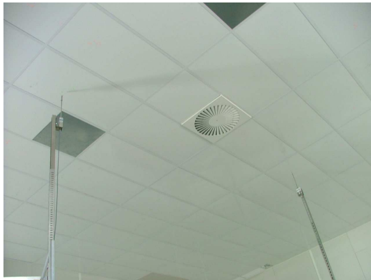
Slika 5.7 Uspravni položaj osjetnika okomito na smjer strujanja, mjerenje s dva istovremeno
