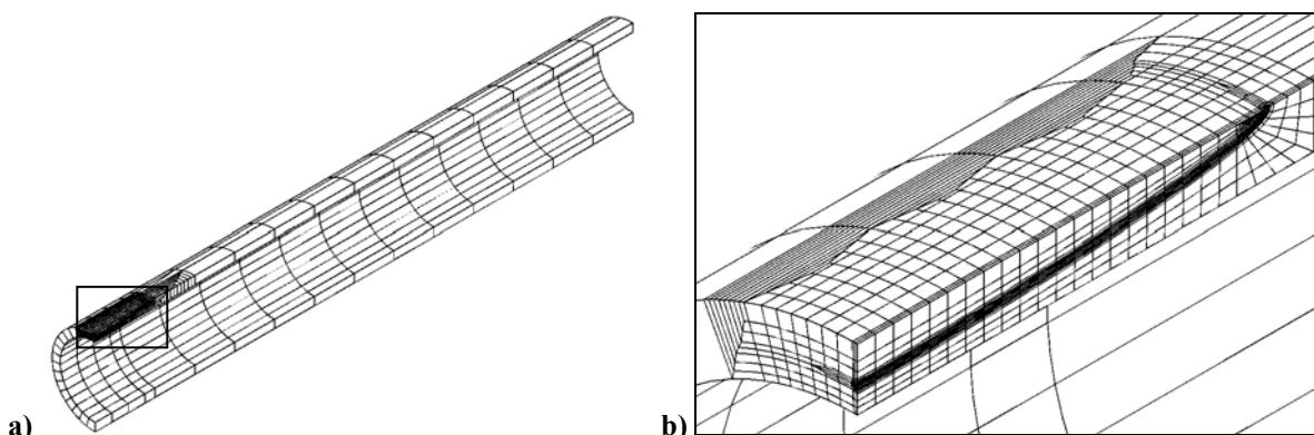
Slika 76. Diskretizirani proračunski model cijevi opterećene unutarnjim tlakom s vanjskom osnom polueliptičkom pukotinom za  $2c = 20\text{ mm}$ ,  $a/t = 0,6$  : a) cijela cijev i b) mreža oko vrha pukotine
