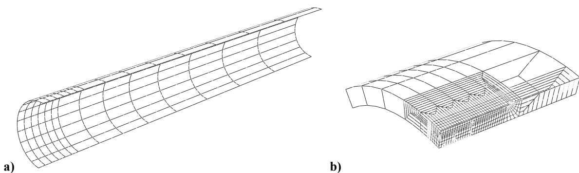
Slika 56. Diskretizirani proračunski model cijevi opterećene unutarnjim tlakom s vanjskom osnom polueliptičkom pukotinom  $R_i/t=10$ ,  $c/a=10$ ,  $a/t=0,4$  i  $s/c=2$ : a) globalni model i b) podmodel
