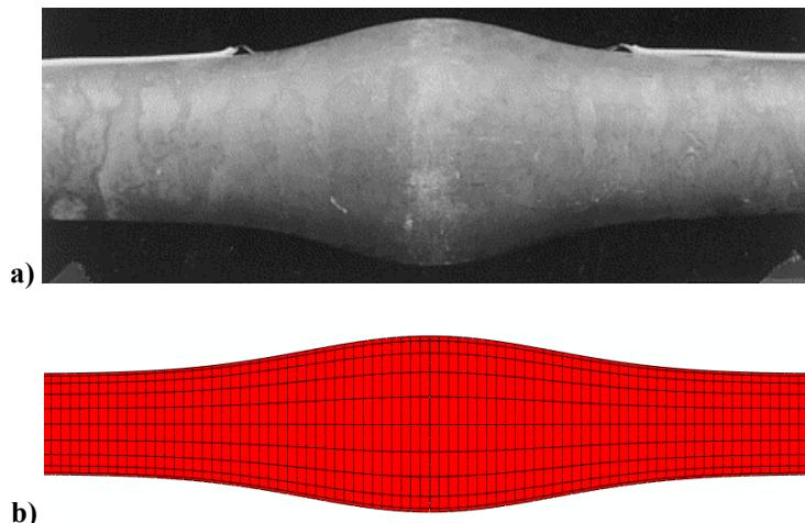
**Slika 40. Plastični kolaps cijevi bez pukotine: a) eksperiment [16] i b) analiza metodom konačnih elemenata**
