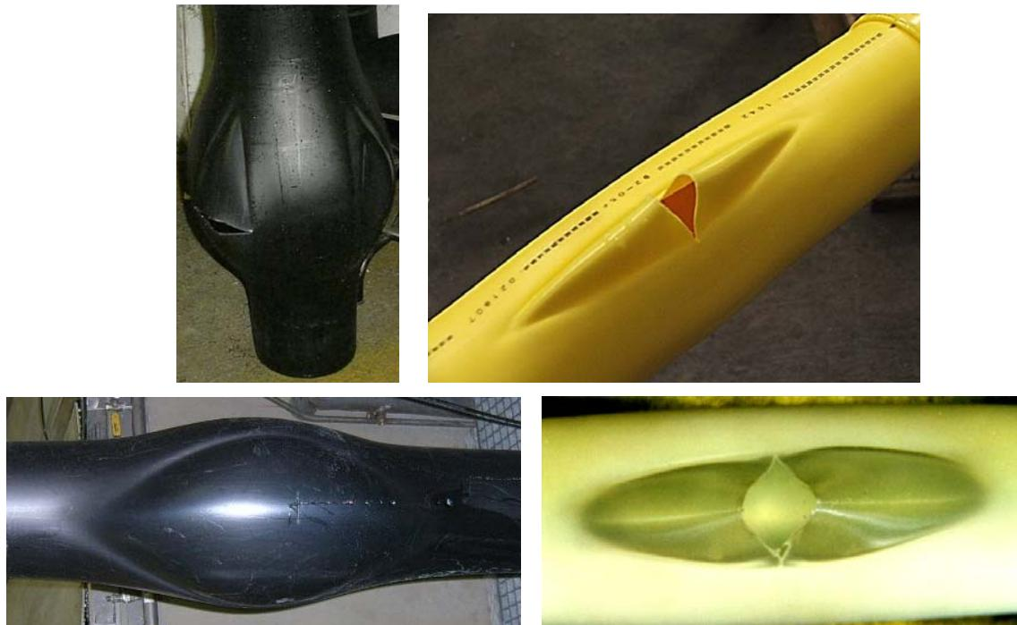
Slika 95. Vrste lomova polietilenskih cijevi [84, 85]
