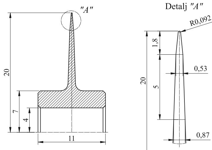
Slika 150. Izmjerene dimenzije polumjera vrha noža
