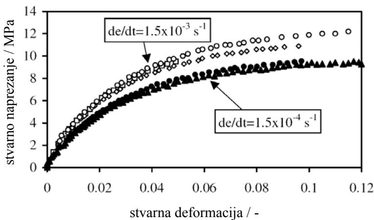
Slika 96. Krivulje stvarno naprezanje-deformacija za polietilen srednje gustoće pri  $60^{\circ}\text{C}$  [37, 45]
