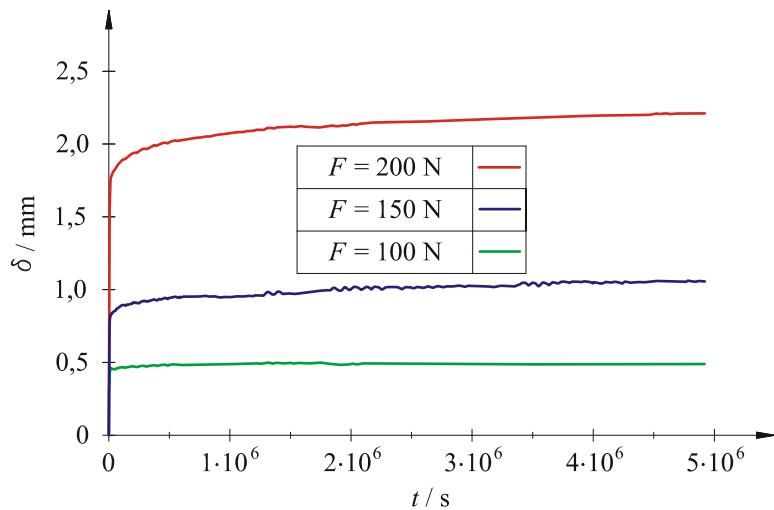
Slika 154. Dijagram međusobne ovisnosti ukupnog pomaka točke A,  $\delta$ , i vremena uslijed puzanja,  $t$ , polietilena PE100 pri  $80^{\circ}\text{C}$
