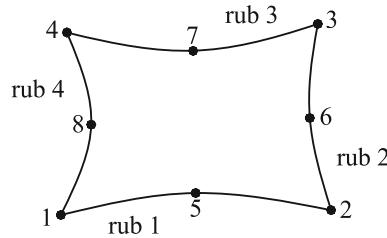
Slika 20. CAX8 – 8-čvorni osnosimetrični konačni element [47]
