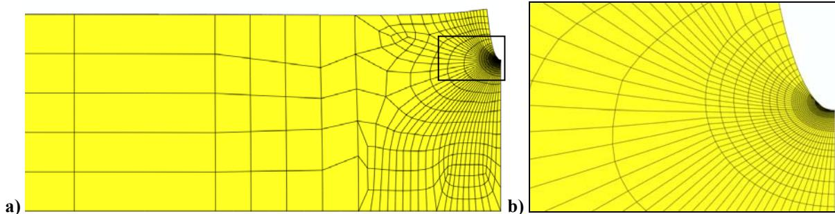
**Slika 115. Deformirani oblik osnosimetrične epruvete s potpunim obodnim zarezom dubine  $a / R = 0,25$ :**
