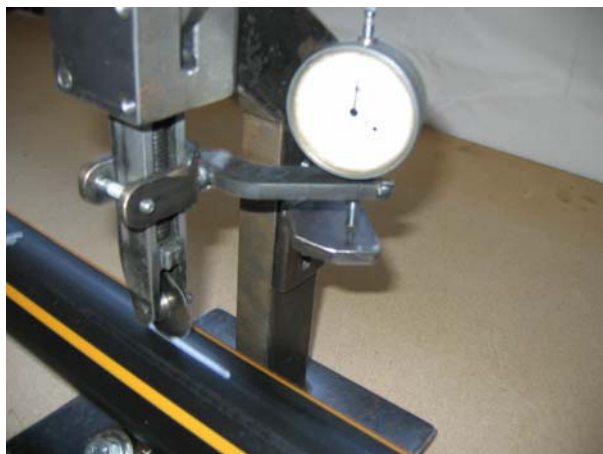
Slika 125. Naprava za urezivanje osnih zareza [99]
