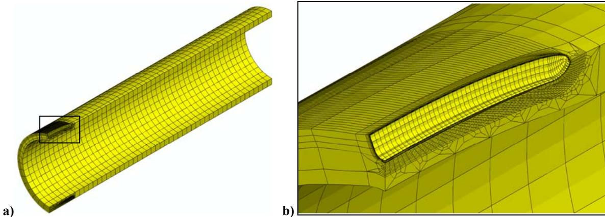
**Slika 131.** Deformirani oblik cijevi opterećene unutarnjim tlakom s vanjskim osnim zarezom  $2c = 50 \text{ mm}$
