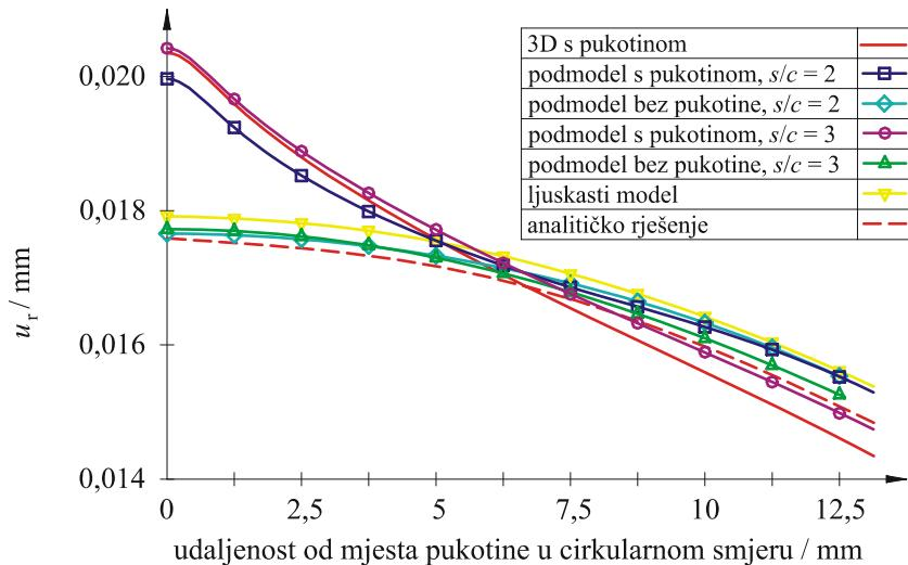
**Slika 61. Radikalni pomak unutarnje stijenke cijevi u ovisnosti o udaljenosti od mjesta pukotine u циркуларном смјеру  $R_i/t = 10$ ,  $c/a = 10$  и  $a/t = 0,4$**
