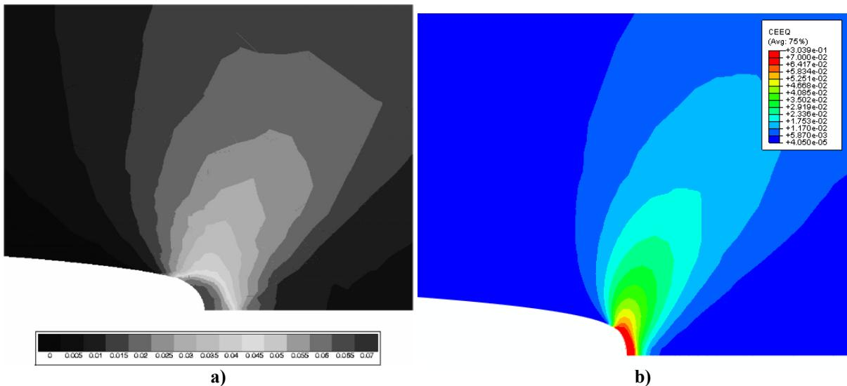
**Slika 107. Prikaz raspodjele ekvivalentne deformacije od puzanja u vrhu zareza nakon  $10^5$  s:**
