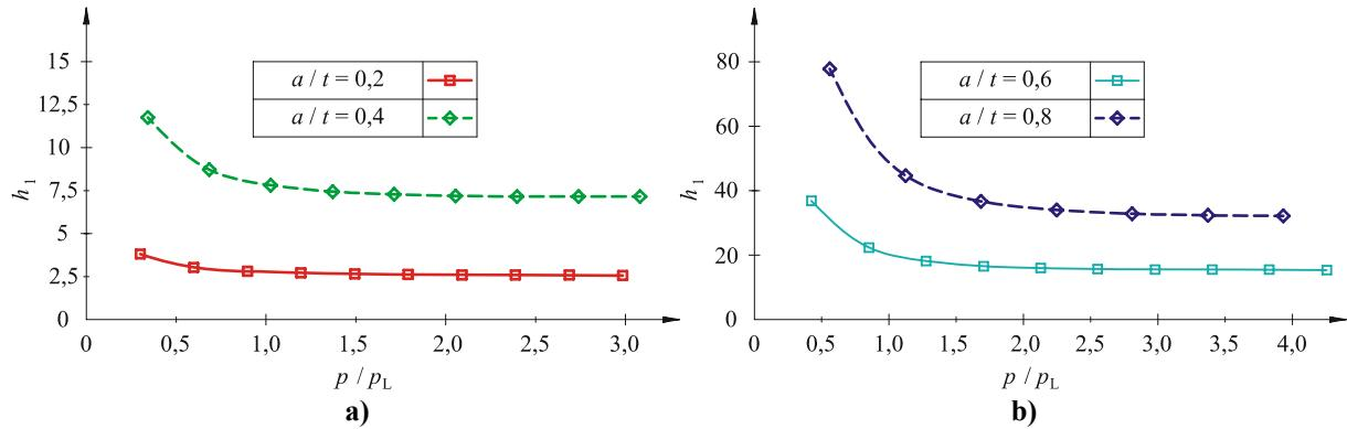
Slika 89. Promjena bezdimenzijske utjecajne funkcije za procjenu plastičnog dijela  $J$ -integrala s veličinom opterećenja za  $2c = 30 \text{ mm}$ : a)  $a/t = 0,2$  i  $a/t = 0,4$  i b)  $a/t = 0,6$  i  $a/t = 0,8$
