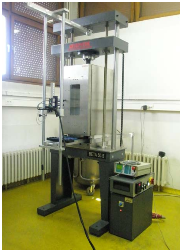
Slika 137. Kidalica tipa Messphysik, Beta 50
