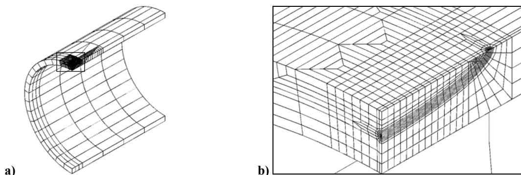
Slika 34. Diskretizirani proračunski model cijevi opterećene unutarnjim tlakom s vanjskom osnom polueliptičkom pukotinom  $R_i/t = 10$ ,  $c/a = 5$  i  $a/t = 0,4$  : a) cijela cijev i b) mreža oko vrha pukotine
