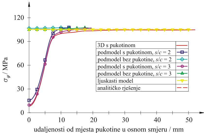
Slika 62. Cirkularno naprezanje na unutarnjoj stjenci cijevi u ovisnosti o udaljenosti od mjesta pukotine u osnom smjeru  $R_i / t = 10$ ,  $c/a = 10$  i  $a/t = 0,4$
