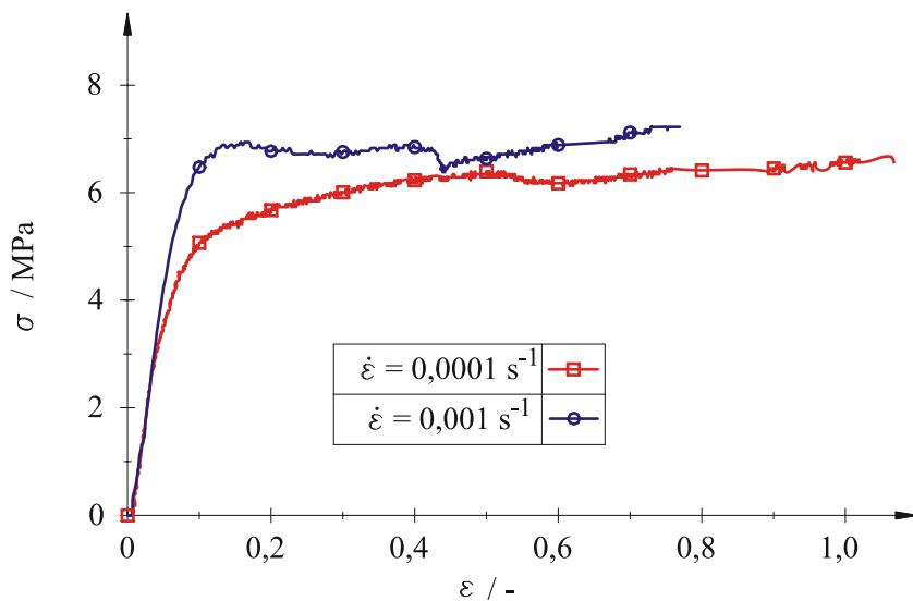
Slika 143. Krivulja konvencionalno naprezanje-konvencionalna deformacija pri 80°C
