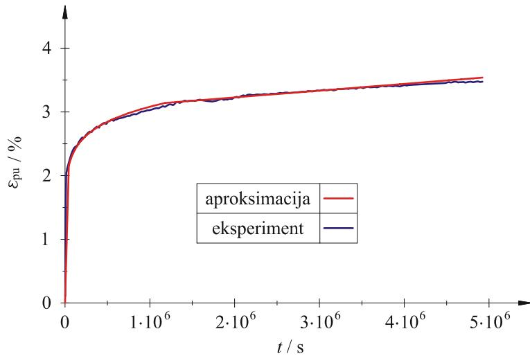
**Slika 162. Usporedba krivulja medusobne ovisnosti deformacije puzanja točke A,  $\varepsilon_{pu}$ , i vremena puzanja,  $t$ , dobivenih eksperimentalno i primarno-sekundarnim zakonom puzanja**
