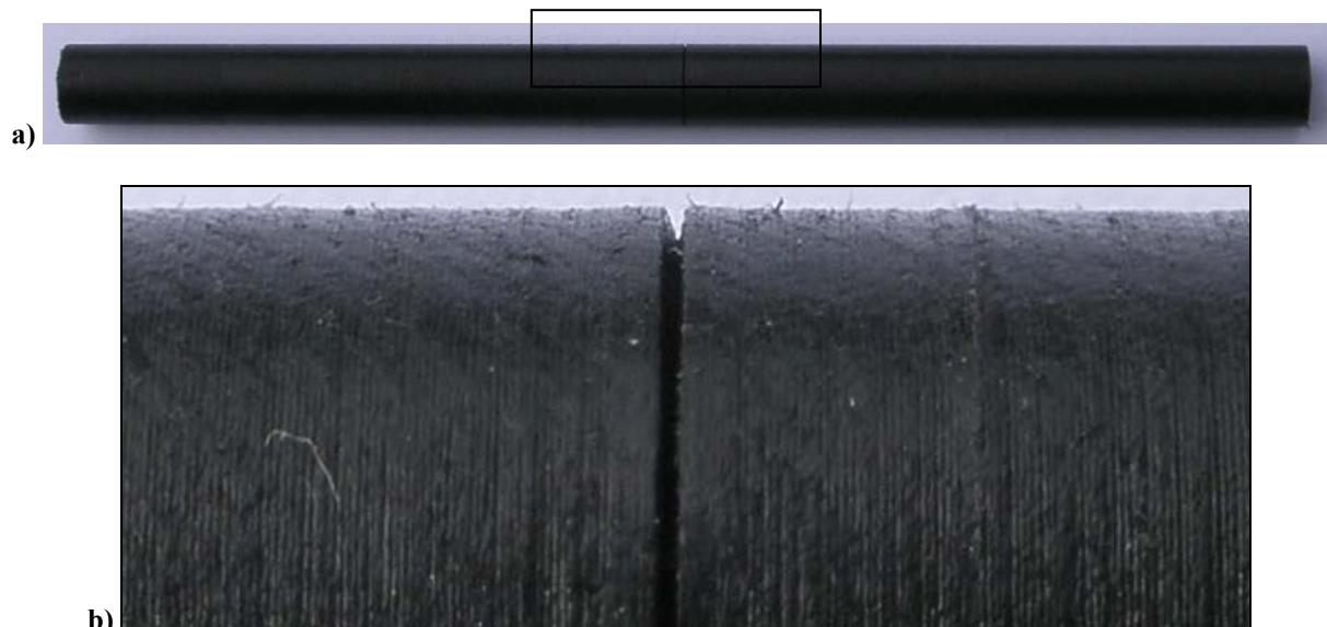
**Slika 145. Osnosimetrična epruveta s potpunim obodnim zarezom korишtena u eksperimentu puzanja:**
