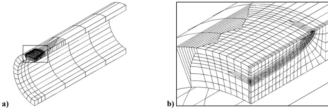
Slika 32. Diskretizirani proračunski model cijevi opterećene unutarnjim tlakom s vanjskom osnom polueliptičkom pukotinom  $R_i/t = 4$ ,  $c/a = 5$  i  $a/t = 0,4$  : a) cijela cijev i b) mreža oko vrha pukotine
