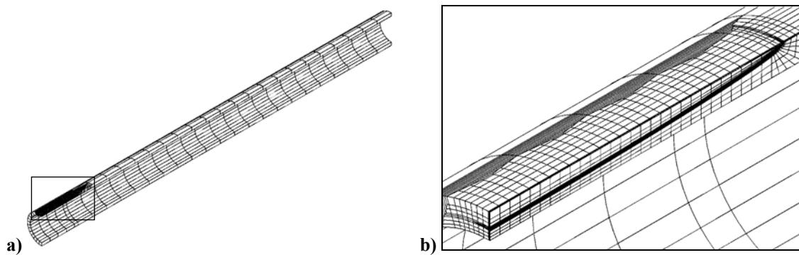
Slika 33. Diskretizirani proračunski model cijevi opterećene unutarnjim tlakom s vanjskom osnom polueliptičkom pukotinom  $R_i/t = 4$ ,  $c/a = 20$  i  $a/t = 0,6$  : a) cijela cijev i b) mreža oko vrha pukotine
