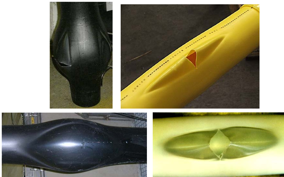
Slika 95. Vrste lomova polietilenskih cijevi [84, 85]
