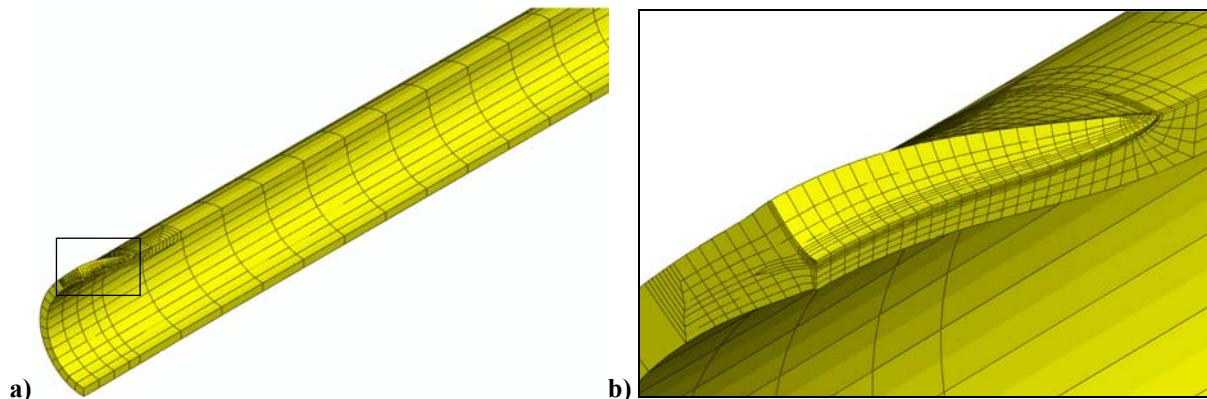
Slika 45. Deformirani oblik cijevi s pukotinom za  $R_i/t = 4$ ,  $c/a = 10$  i  $a/t = 0,6$  : a) cijela cijev i
