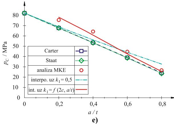
Slika 84. Usporedba tlaka plastičnog kolapsa u ovisnosti o funkciju  $k_1$  za cijevi generatora pare dobivenih numeričkom analizom, predloženim izrazom (95) i izrazima predloženim od Carter-a [21] i Staat-a [20, 29] za: a)  $2c = 10 \text{ mm}$ ; b)  $2c = 20 \text{ mm}$ ; c)  $2c = 30 \text{ mm}$ ; d)  $2c = 40 \text{ mm}$  i e)  $2c = 50 \text{ mm}$
