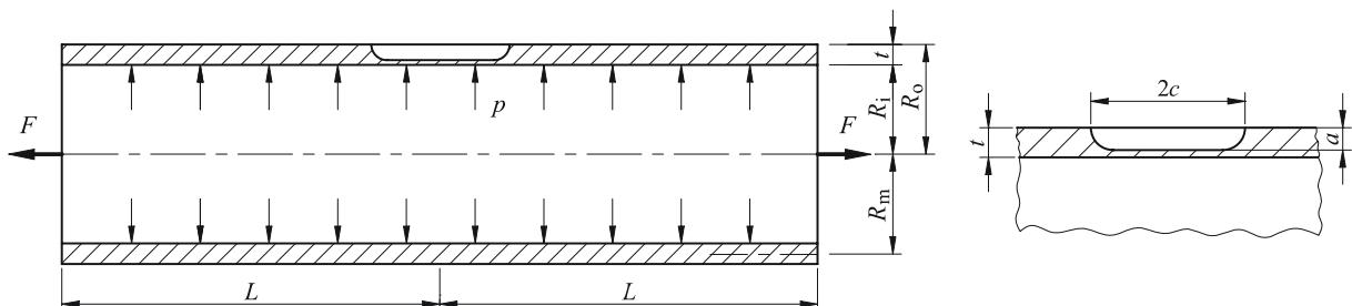
Slika 127. Dimenzije i opterećenje cijevi s vanjskim osnim zarezom opterećene unutarnjim tlakom
