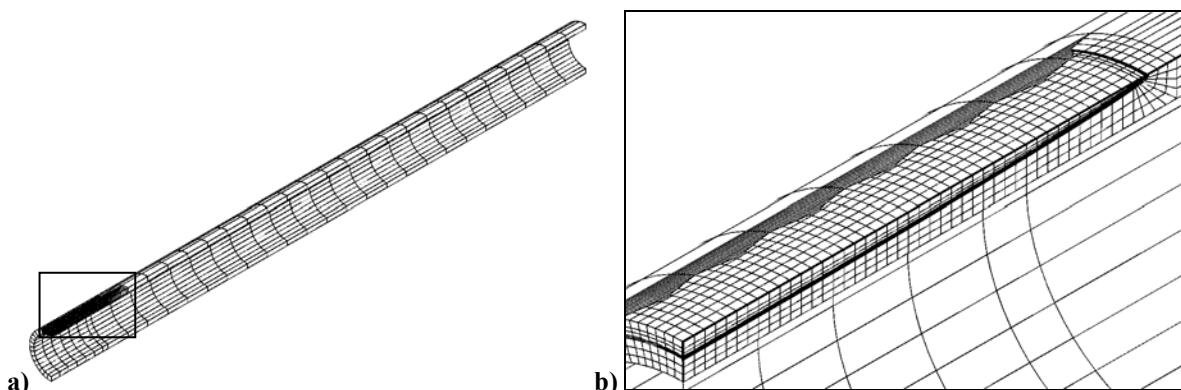
Slika 77. Diskretizirani proračunski model cijevi opterećene unutarnjim tlakom s vanjskom osnom polueliptičkom pukotinom za  $2c = 40\text{ mm}$ ,  $a/t = 0,4$  : a) cijela cijev i b) mreža oko vrha pukotine
