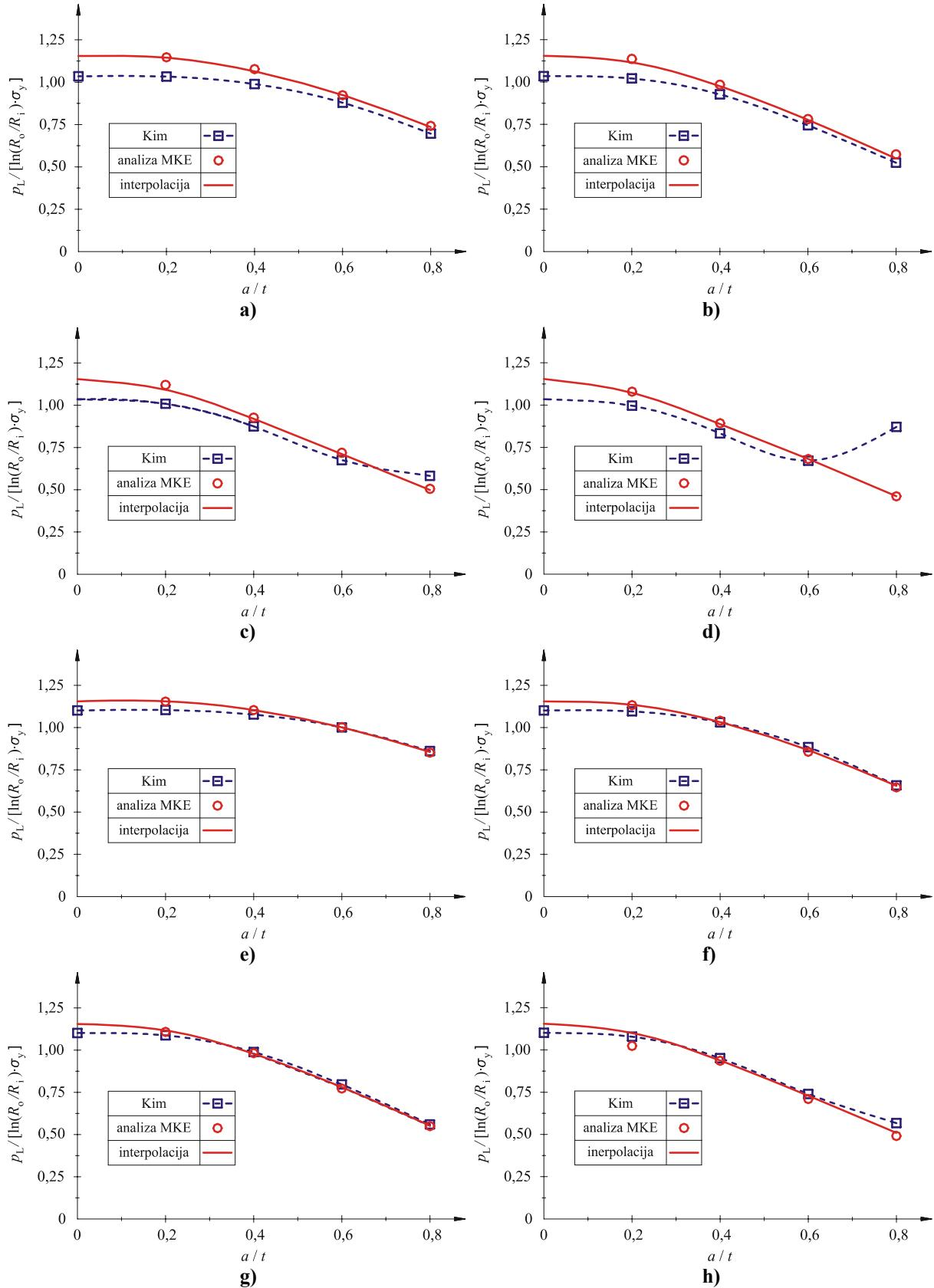
**Slika 42.** Usporedba graničnog tlaka za cijevi opterećene unutarnjim tlakom s vanjskom osnom polueliptičkom pukotinom s izrazom predloženim od Kima i ostalih autora [18] za: a)  $R_i/t = 4$  i  $c/a = 5$  ;
