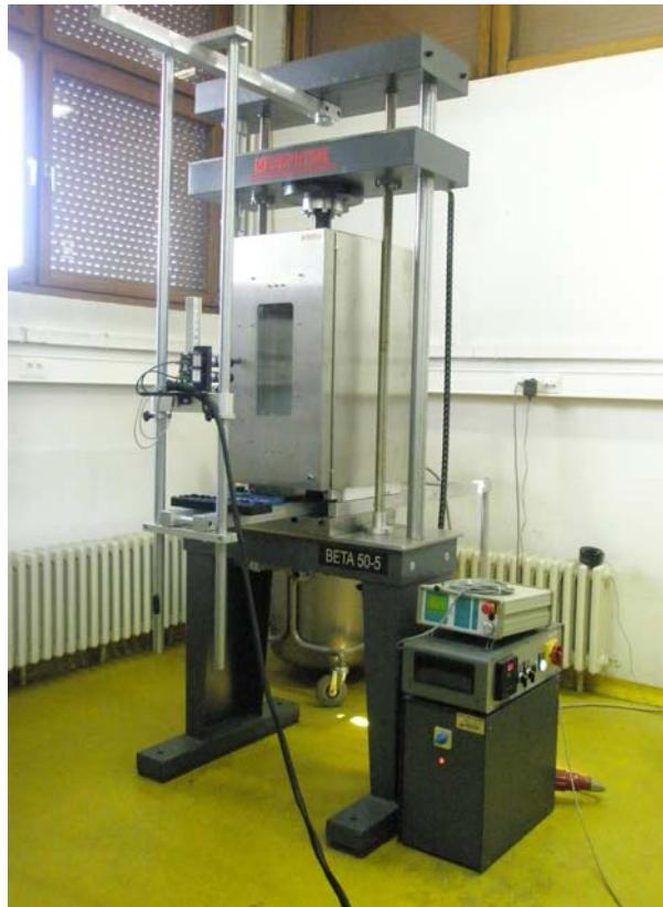
Slika 137. Kidalica tipa Messphysik, Beta 50
