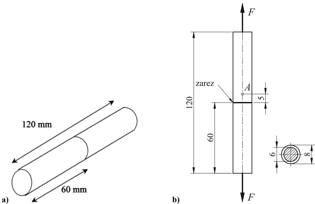
Slika 97. Osnosimetrična epruveta s potpunim obodnim zarezom (*full notched crack tensile (FNCT) specimen*): a) shematski prikaz i b) deteljni prikaz epruvete i presjeka na mjestu zareza [33, 36, 37, 45, 46]
