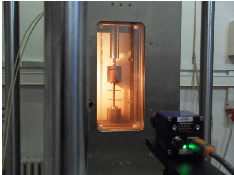
Slika 156. Osnosimetrična epruveta s markerima u čeljustima kidalice
