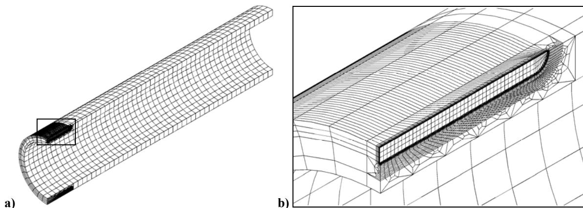
**Slika 129. Diskretizirani proračunski model cijevi opterećene unutarnjim tlakom s vanjskim osnim zarezom  $2c = 50 \text{ mm}$  i  $a = 2 \text{ mm}$  : a) cijela cijev i b) mreža oko vrha zareza**
