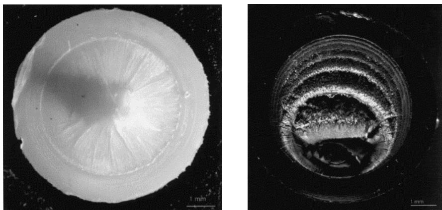
Slika 99. Površine loma epruvete [33, 36, 37]
