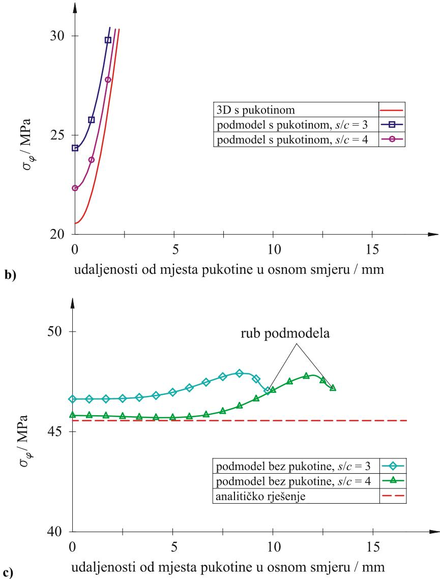
Slika 65. Cirkularno naprezanje na unutarnjoj stjenci cijevi u ovisnosti o udaljenosti od mjesto pukotine u osnom smjeru  $R_i/t = 4$ ,  $c/a = 5$  i  $a/t = 0,4$ : a) cijelo područje, b) detaljniji prikaz u području A i c) detaljniji prikaz u području B
