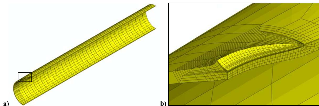
Slika 46. Deformirani oblik cijevi s pukotinom za  $R_i/t = 10$ ,  $c/a = 15$  i  $a/t = 0,4$  : a) cijela cijev i
