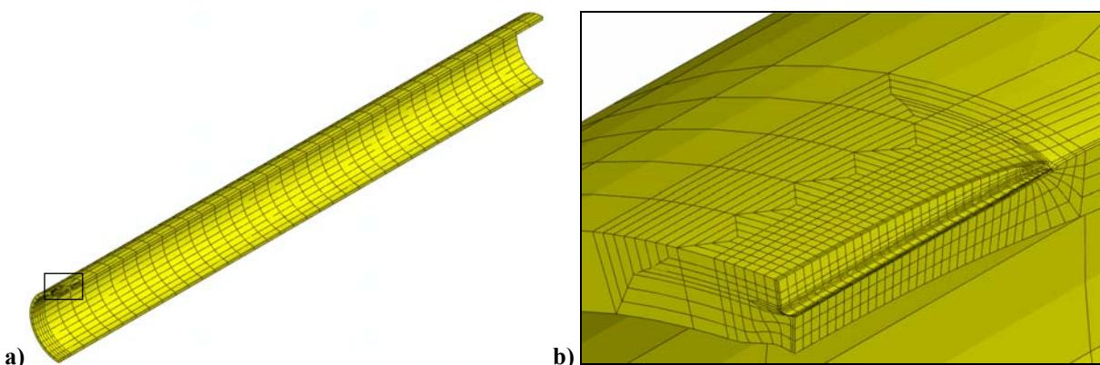
**Slika 44. Deformirani oblik cijevi s pukotinom za  $R_i/t = 10$ ,  $c/a = 10$  i  $a/t = 0,4$  : a) cijela cijev i
