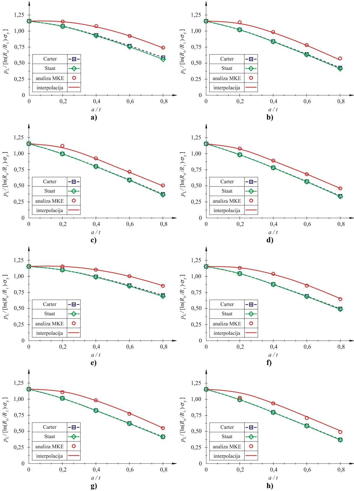
**Slika 41. Usporedba graničnog tlaka za cijevi opterećene unutarnjim tlakom s vanjskom osnom polueliptičkom pukotinom s izrazima iz literature [21] i [20, 29] za:**
