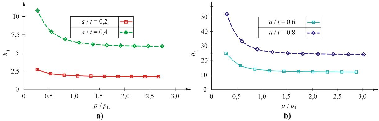
Slika 86. Promjena bezdimenzijske utjecajne funkcije za procjenu plastičnog dijela J-integrala s veličinom opterećenja za  $2c = 5 \text{ mm}$  : a)  $a/t = 0,2$  i  $a/t = 0,4$  b)  $a/t = 0,6$  i  $a/t = 0,8$
