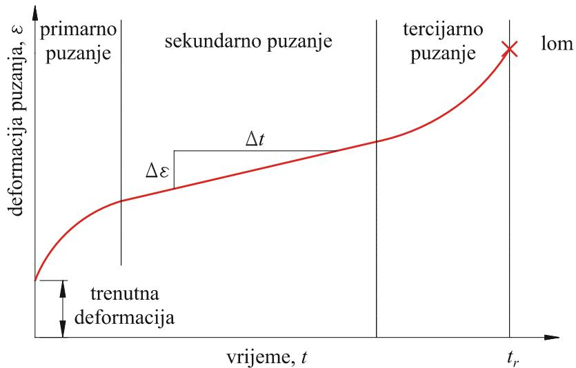
Slika 13. Dijagram puzanja konstrukcije opterećene konstantnim naprezanjem [52, 56]
