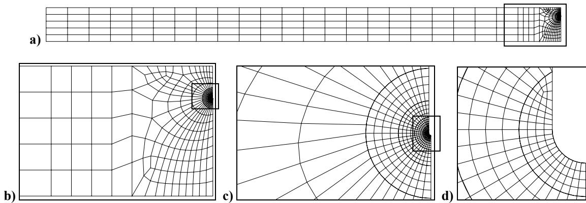
**Slika 102. Mreža 1 konačnih elemenata za osnosimetričnu epruvetu s potpunim obodnim zarezom:
