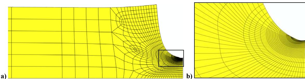
Slika 117. Deformirani oblik osnosimetrične epruvete s potpunim obodnim zarezom dubine  $a / R = 0,75$ :
