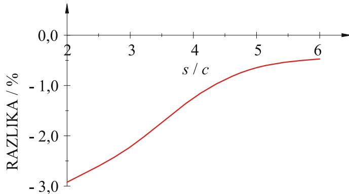
Slika 59. Ovisnost koeficijenta intenzivnosti naprezanja o veličini podmodela  $R_i / t = 4$ ,  $c / a = 5$  i  $a / t = 0,4$  [75]
