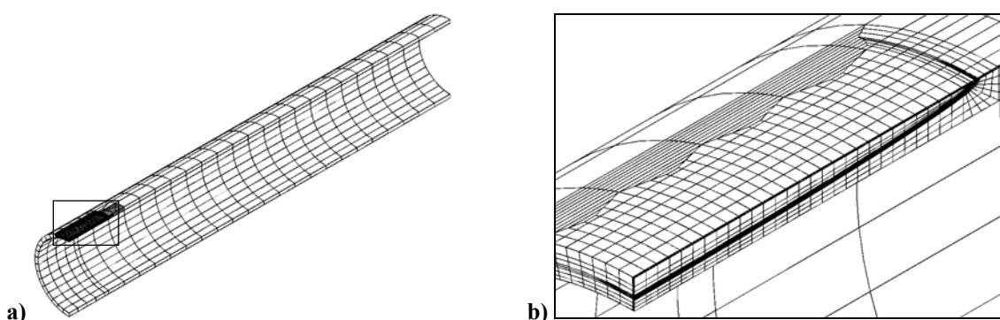
Slika 35. Diskretizirani proračunski model cijevi opterećene unutarnjim tlakom s vanjskom osnom polueliptičkom pukotinom  $R_i/t = 10$ ,  $c/a = 20$  i  $a/t = 0,6$  : a) cijela cijev i b) mreža oko vrha pukotine
