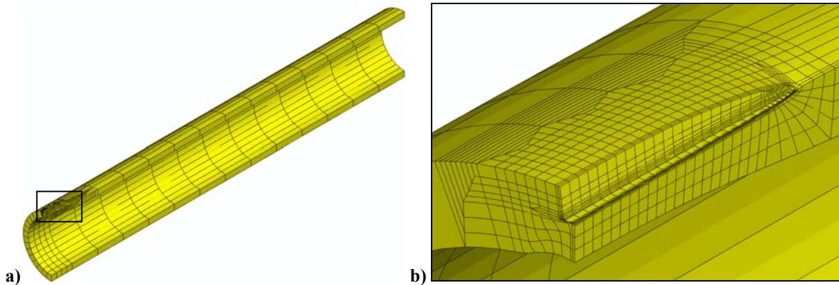
Slika 80. Deformirani oblik cijevi s pukotinom za  $2c=10\text{ mm}$  i  $a/t = 0,4$  : a) cijela cijev i b) područje oko vrha pukotine
