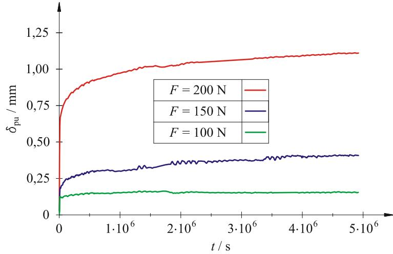
Slika 160. Dijagram međusobne ovisnosti pomaka točke A uslijed puzanja,  $\delta_{pu}$ , i vremena,  $t$ , za polietilen PE100 pri  $80^\circ\text{C}$
