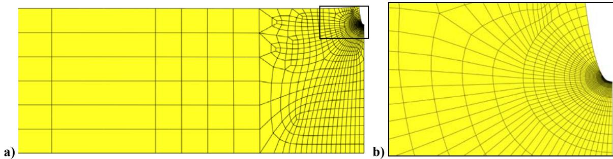
**Slika 114. Deformirani oblik osnosimetrične epruvete s potpunim obodnim zarezom dubine  $a / R = 0,125$ :**
