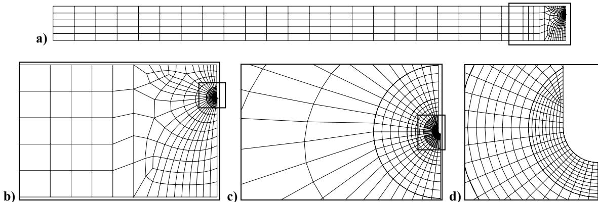
**Slika 103. Mreža 2 konačnih elemenata za osnosimetričnu epruvetu s potpunim obodnim zarezom:
