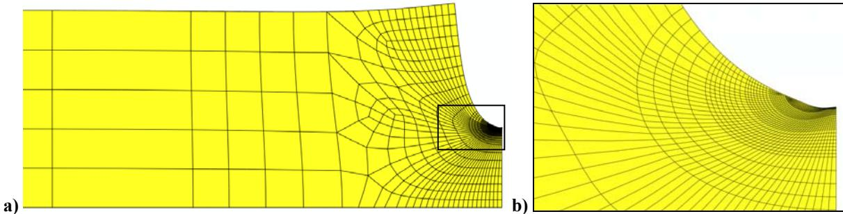
Slika 116. Deformirani oblik osnosimetrične epruvete s potpunim obodnim zarezom dubine  $a/R = 0,625$ :
