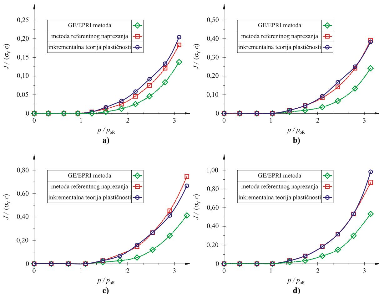
Slika 91. Usporedba vrijednosti  $J$ -integrala dobivenih GE/EPRI metodom, metodom referentnog naprezanja i numerički primjenom inkrementalne teorije plastičnosti za  $2c = 5 \text{ mm}$  : a)  $a = 0,3 \text{ mm}$  ;
