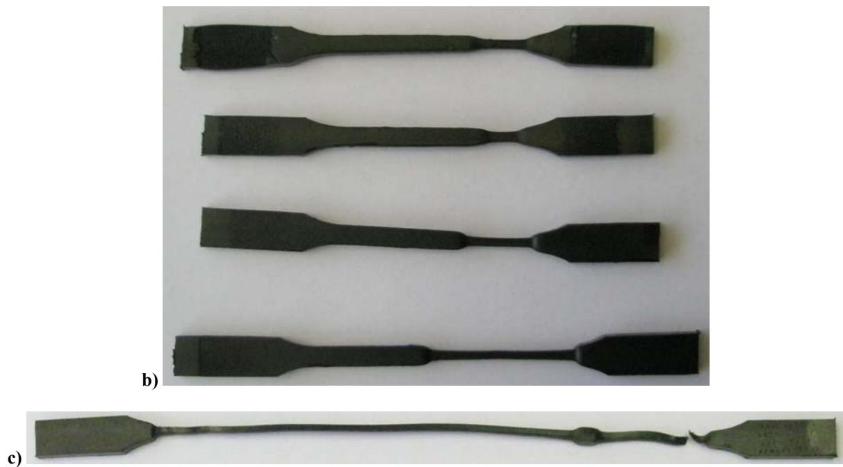
Slika 140. Epruvete nakon ispitivanja: a) pri  $60^{\circ}\text{C}$ , b) pri  $80^{\circ}\text{C}$  i c) polomljena epruveta
