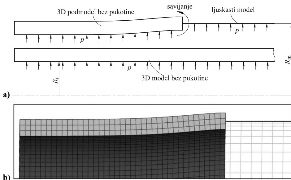
Slika 64. Opterećenje 3D modela i podmodela jednakim tlakom: a) shematski prikaz deformiranog oblika podmodela i 3D modela i b) deformirani oblik podmodela
