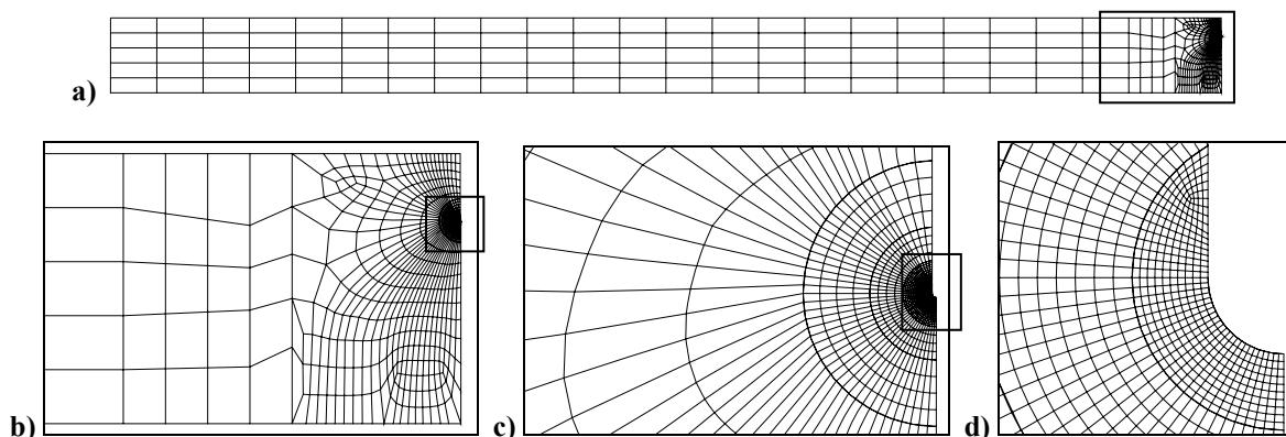
**Slika 104. Mreža 3 konačnih elemenata za osnosimetričnu epruvetu s potpunim obodnim zarezom:
