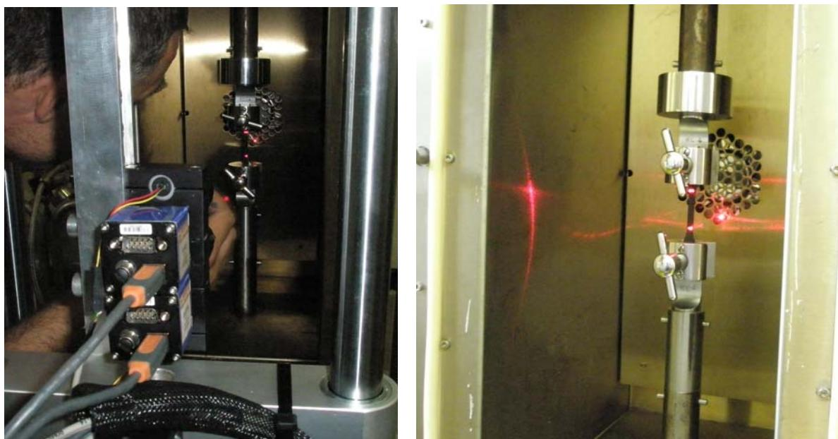
Slika 138. Epruveta postavljena u čeljusti kidalice
