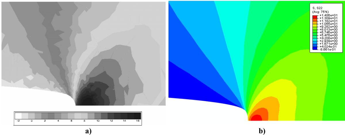
Slika 108. Prikaz raspodjele naprezanje  $\sigma_{22}$  / MPa u vrhu zareza nakon  $10^5$  s: a) Hamouda i ostali autori [33, 36, 37] i b) numerički primjenom rutine CREEP
