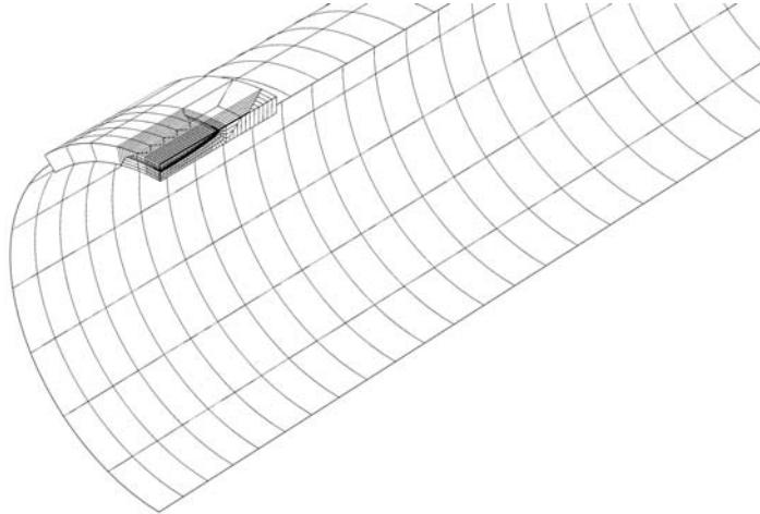
**Slika 57.** Stvarni položaj podmodela na globalnom modelu cijevi s pukotinom za  $R_i/t = 10$ ,  $c/a = 10$ ,
