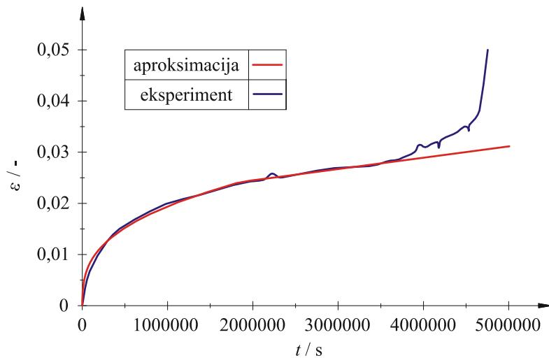
Slika 100. Usporedba krivulja deformacija,  $\varepsilon$ , u ovisnosti o vrijemenu puzanja,  $t$ , dobivenih eksperimentalno [33, 36, 37] i parametrima aproksimacije
