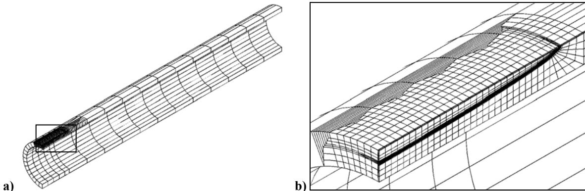
Slika 75. Diskretizirani proračunski model cijevi opterećene unutarnjim tlakom s vanjskom osnom polueliptičkom pukotinom za  $2c = 20\text{ mm}$ ,  $a/t = 0,4$  : a) cijela cijev i b) mreža oko vrha pukotine
