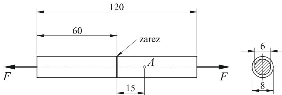
Slika 144. Osnosimetrična epruveta s potpunim obodnim zarezom
