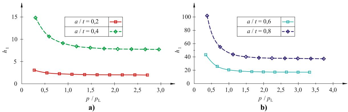
Slika 87. Promjena bezdimenzijske utjecajne funkcije za procjenu plastičnog dijela J-integrala s veličinom opterećenja za  $2c = 10 \text{ mm}$  : a)  $a/t = 0,2$  i  $a/t = 0,4$  b)  $a/t = 0,6$  i  $a/t = 0,8$
