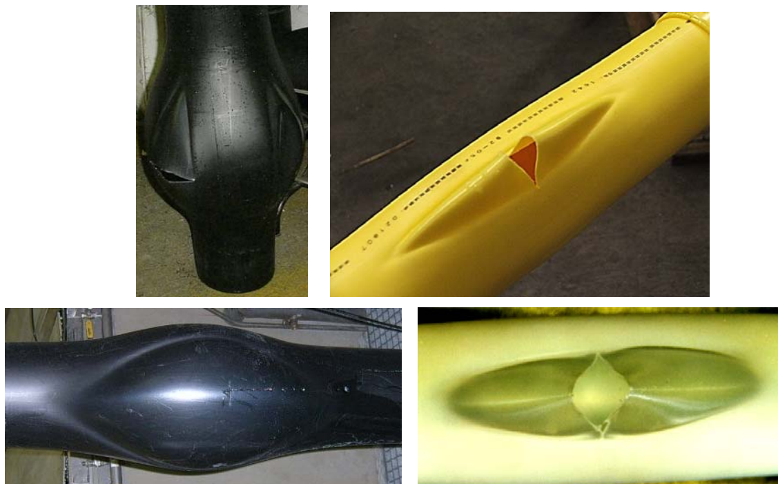
Slika 95. Vrste lomova polietilenskih cijevi [84, 85]
