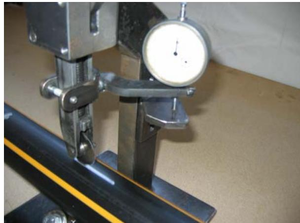
Slika 125. Naprava za urezivanje osnih zareza [99]
