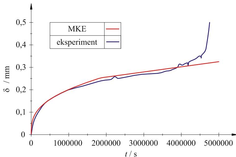
Slika 105. Usporedba dijagrama međusobne ovisnosti pomaka,  $\delta$ , točke A o vremenu puzanja,  $t$ , materijala pri  $60^{\circ}\text{C}$  i za  $\sigma_{\text{net}} = 8 \text{ MPa}$  dobivenog eksperimentalno, Hamouda i ostali autori [33, 36, 37], i numerički primjenom korisničke rutine CREEP u programskom paketu ABAQUS
