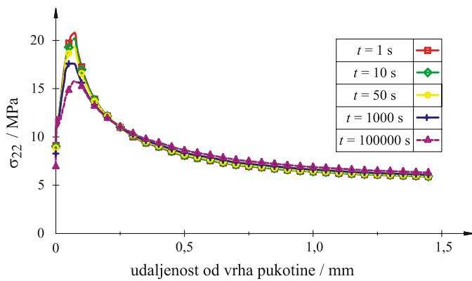
Slika 109. Relaksacija maksimalnog glavnog naprezanja,  $\sigma_{22}$ , u ovisnosti o udaljenosti od vrha zareza i vremenu puzanja
