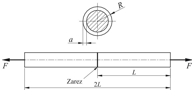
Slika 110. Osnosimetrična epruveta s potpunim obodnim zarezom
