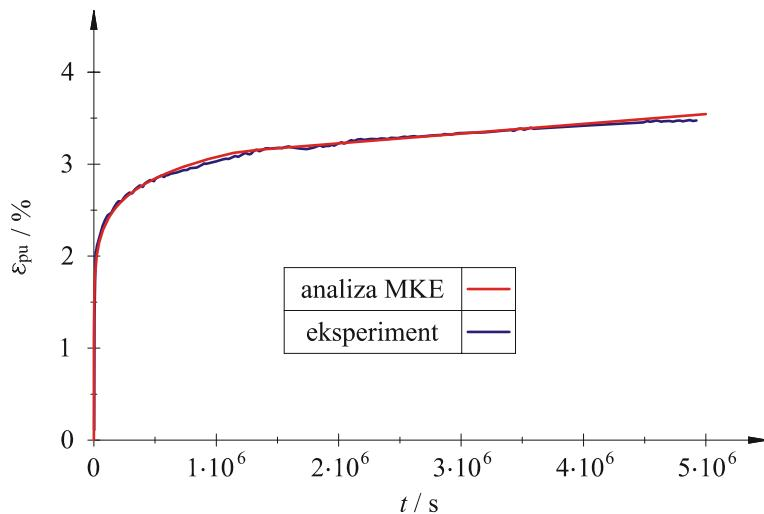
Slika 164. Usporedba dijagrama medusobne ovisnosti deformacije puzanja točke  $A$ ,  $\varepsilon_{pu}$ , i vremena uslijed puzanja,  $t$ , materijala pri  $80^\circ\text{C}$  i za  $F = 200 \text{ N}$  dobivenog provedbom eksperimenta i numerički primjenom korisničke rutine CREEP u programskom paketu ABAQUS [47]
