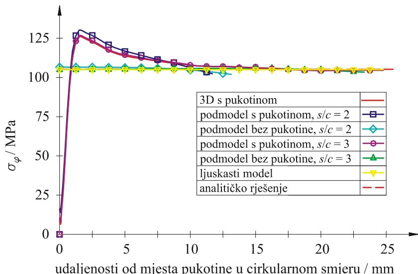
Slika 63. Cirkularno naprezanje na unutarnjoj stjenci cijevi u ovisnosti o udaljenosti od mjesta pukotine u cirkularnom smjeru  $R_i / t = 10$ ,  $c/a = 10$  i  $a/t = 0,4$
