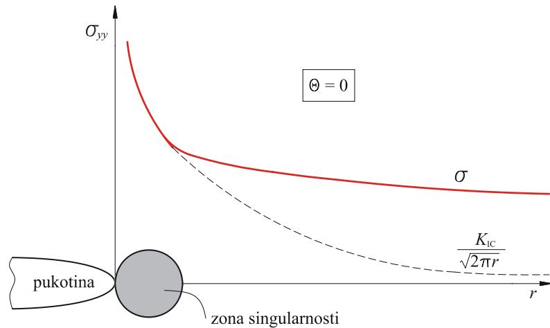
Slika 6. Raspodjela normalnog naprezanja na ravninu pukotine,  $\sigma_{yy}$  [49, 51]
