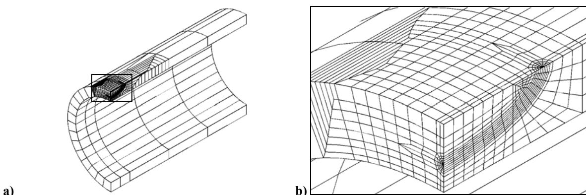
Slika 74. Diskretizirani proračunski model cijevi opterećene unutarnjim tlakom s vanjskom osnom polueliptičkom pukotinom za  $2c = 5$  mm,  $a/t = 0,6$  : a) cijela cijev i b) mreža oko vrha pukotine
