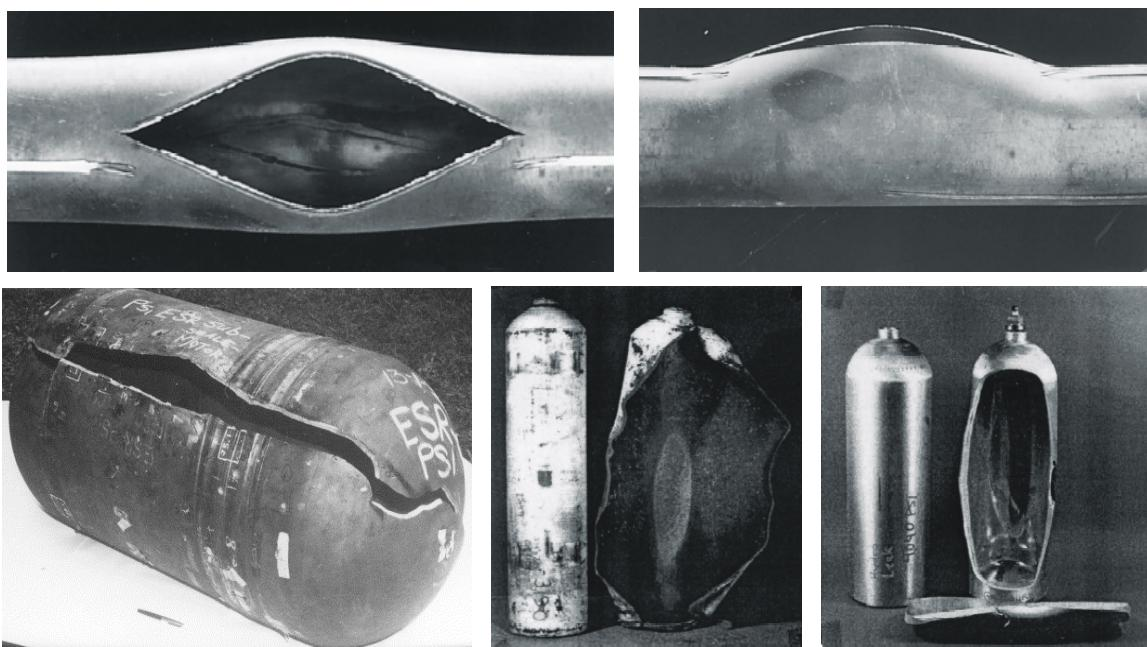
Slika 30. Lomovi na cijevima i posudama pod tlakom [16, 63]
