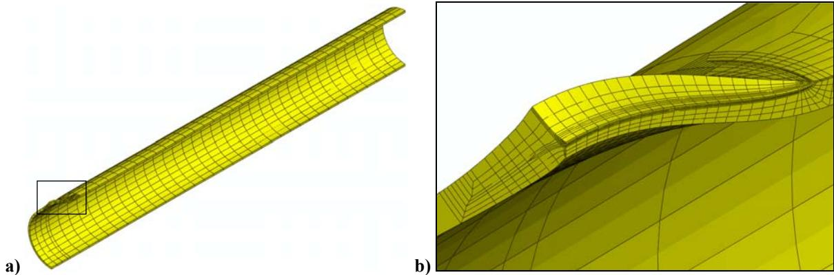
**Slika 39. Deformirani oblik cijevi s pukotinom za  $R_i/t = 10$ ,  $c/a = 15$  i  $a/t = 0,6$ :** a) cijela cijev i
