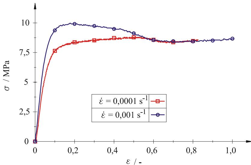
Slika 142. Krivulja konvencionalno naprezanje-konvencionalna deformacija pri 60°C
