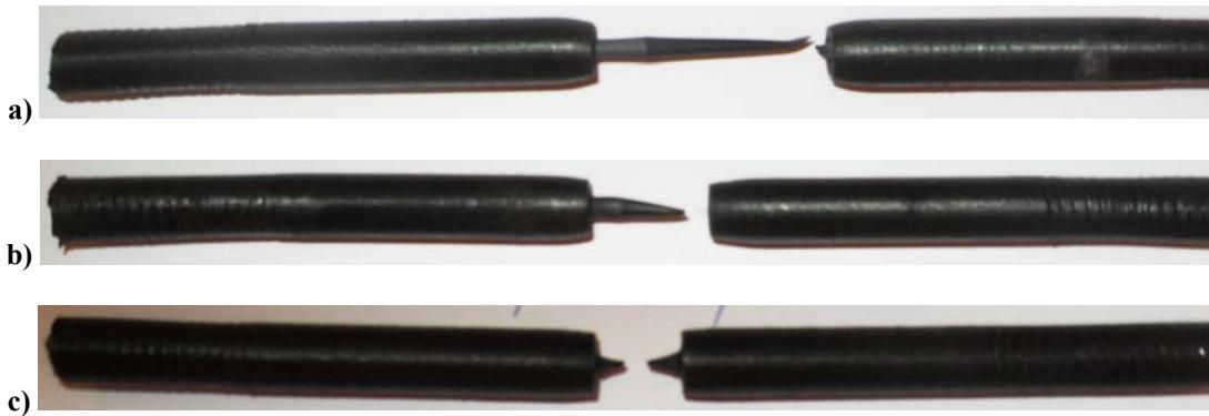
Slika 158. Epruvete nakon ispitivanja u ovisnosti o brzini deformacije: a)  $0,348 \text{ mm/min}$ ,
