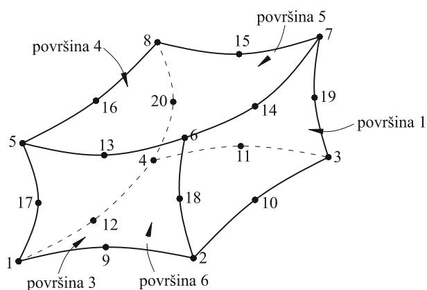
Slika 18. C3D20 – 20-čvorni prizmatični konačni element [47]
