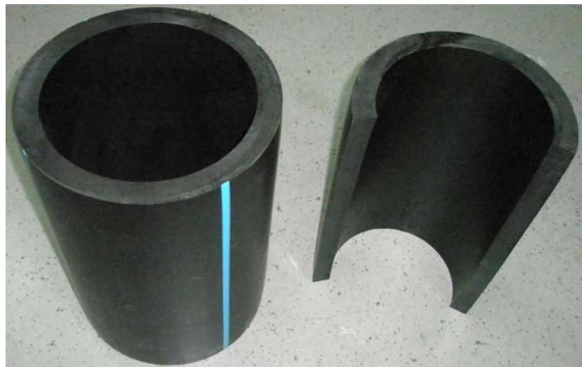
**Slika 136. Cijevi od polietilena PE100 za izradu epruveta**
