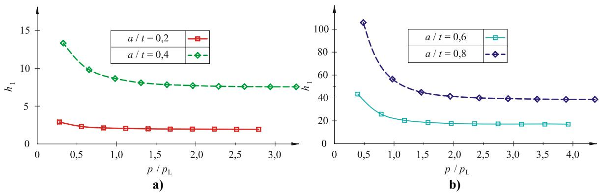
Slika 88. Promjena bezdimenzijske utjecajne funkcije za procjenu plastičnog dijela J-integrala s veličinom opterećenja za  $2c = 20 \text{ mm}$  : a)  $a/t = 0,2$  i  $a/t = 0,4$  b)  $a/t = 0,6$  i  $a/t = 0,8$
