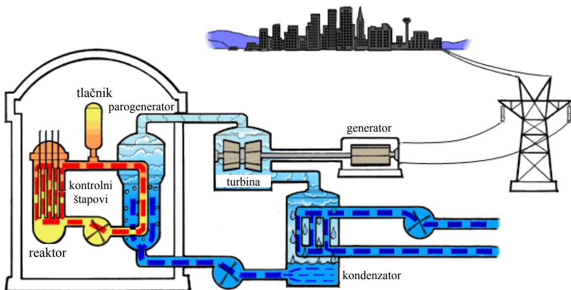
Slika 68. Shema nuklearne elektrane s PWR reaktorom [76]
