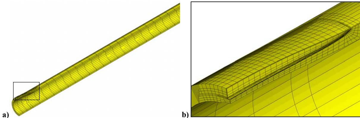
**Slika 43. Deformirani oblik cijevi s pukotinom za  $R_i/t = 4$ ,  $c/a = 15$  i  $a/t = 0,6$  : a) cijela cijev i
