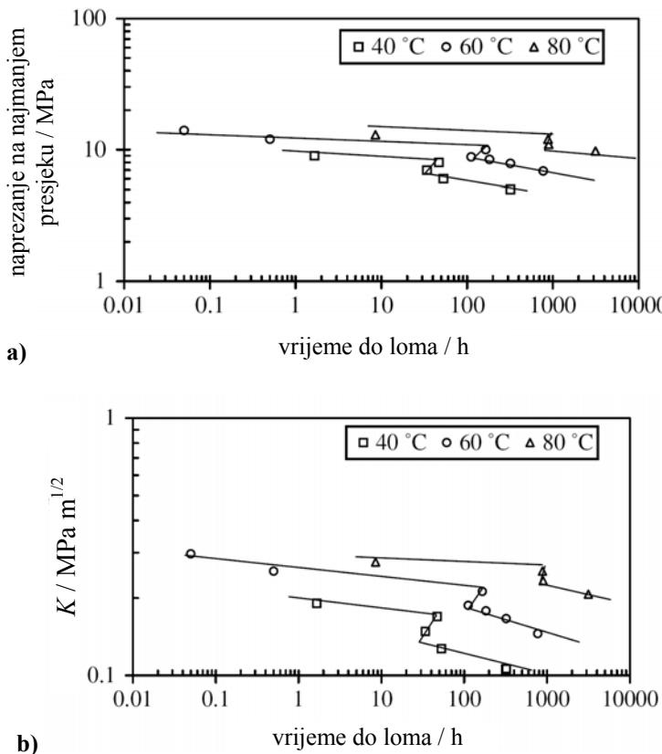
Slika 118. Dijagram procjene loma: a) naprezanje na najmanjem presjeku i b) koeficijent intenzivnosti naprezanja [36]
