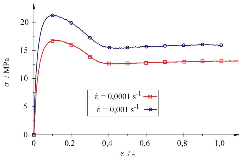
Slika 141. Krivulja konvencionalno naprezanje-konvencionalna deformacija pri  $23^{\circ}\text{C}$
