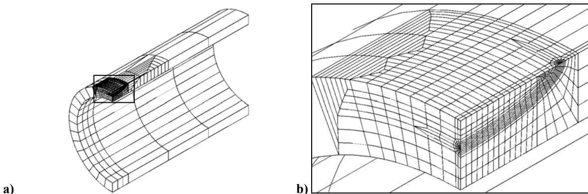
Slika 73. Diskretizirani proračunski model cijevi opterećene unutarnjim tlakom s vanjskom osnom polueliptičkom pukotinom za  $2c = 5$  mm,  $a/t = 0,4$  : a) cijela cijev i b) mreža oko vrha pukotine
