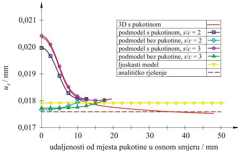
**Slika 60. Radikalni pomak unutarnje stijenke cijevi u ovisnosti o udaljenosti od mjesta pukotine u osnom smjeru  $R_i/t = 10$ ,  $c/a = 10$  i  $a/t = 0,4$**
