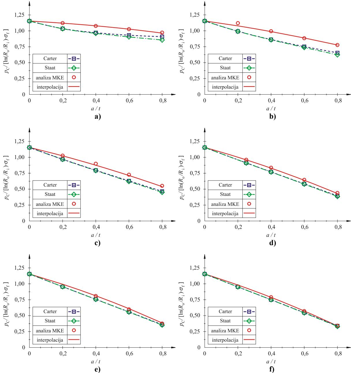
Slika 81. Usporedba tlaka plastičnog kolapsa za cijevi generatora pare dobivenih numeričkom analizom, predloženim izrazom (38) i izrazima predloženim od Cartera [21] i Staata [20, 29] za: a)  $2c = 5 \text{ mm}$  ; b)  $2c = 10 \text{ mm}$  ; c)  $2c = 20 \text{ mm}$  ; d)  $2c = 30 \text{ mm}$  ; e)  $2c = 40 \text{ mm}$  i f)  $2c = 50 \text{ mm}$
