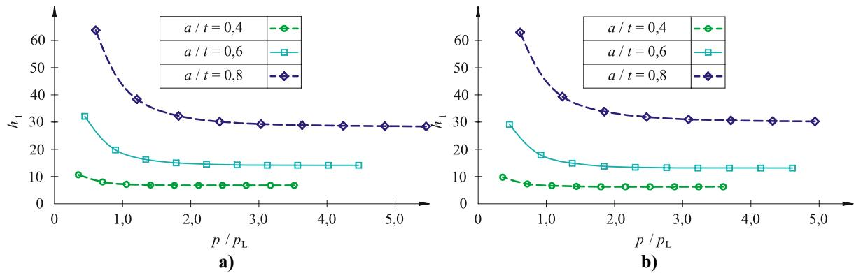
Slika 90. Promjena bezdimenzijske utjecajne funkcije za procjenu plastičnog dijela  $J$ -integrala s veličinom opterećenja za: a)  $2c = 40 \text{ mm}$  :  $a/t = 0,4$ ;  $a/t = 0,6$  i  $a/t = 0,8$  i b)  $2c = 50 \text{ mm}$  :  $a/t = 0,4$ ;  $a/t = 0,6$  i  $a/t = 0,8$
