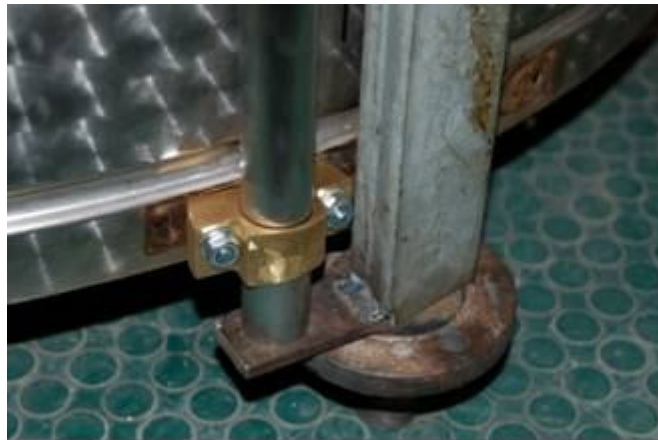
Slika 3.5: Vodilice od mjedi i cijev za vođenje
