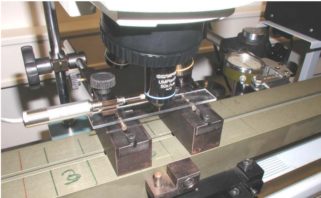
Slika 117. Mjerenje pomaka objektivna pomoću elektronskog komparatora
