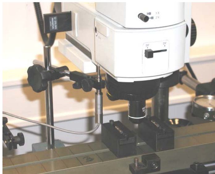
Slika 23. Mjerenje utjecaja pomaka u osi z na fokus mikroskopa
