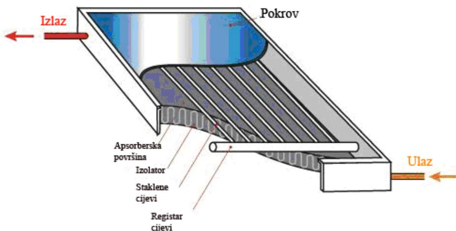
Slika 10. Solarni pločasti kolektor
