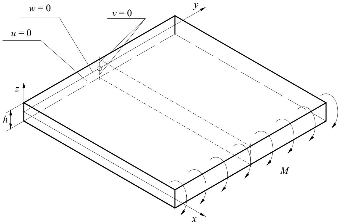
Slika 72. Čisto savijanje ploče s rubnim uvjetima
