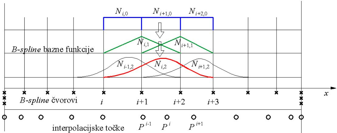
Slika 9. B-spline bazne funkcije u jednodimenzijском простору [27]
