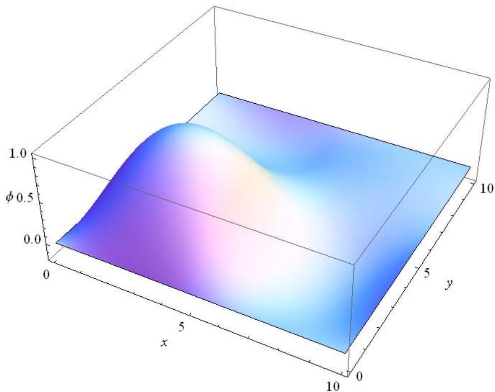
Slika 13. Bikvadratna  $B$ -spline funkcija oblika u dvodimenziskom prostoru
