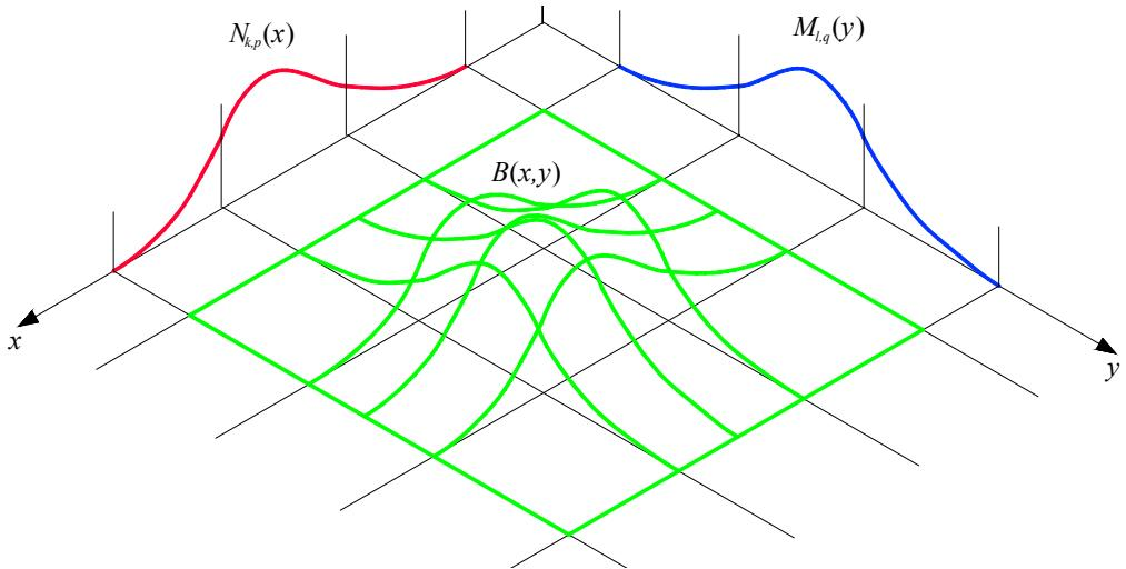
Slika 11. Shematski prikaz bikvadratne *B-spline* baze u dvodimenzijском простору
