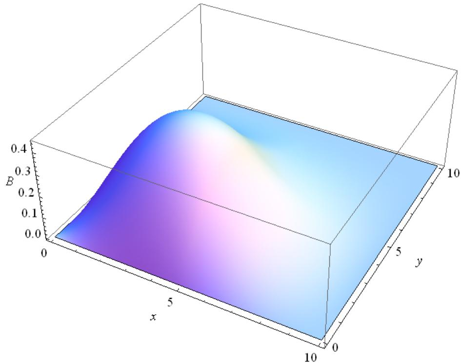
Slika 12. Bikvadratna *B-spline* baza u dvodimenzijском простору
