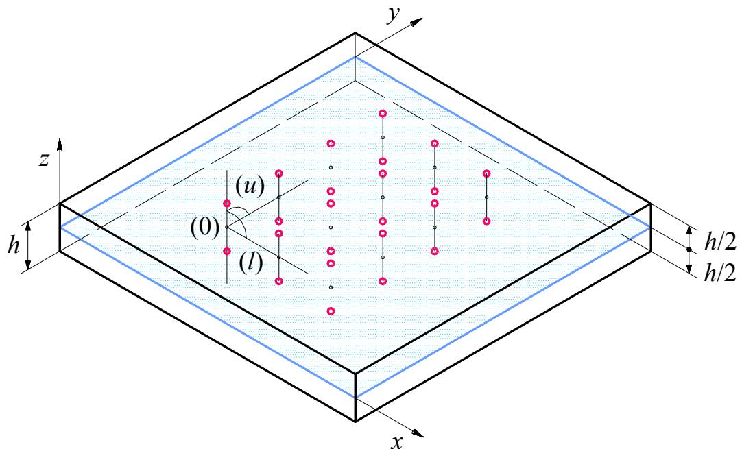
Slika 2. Geometrija ploče s tri čvora po debljini
