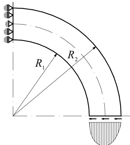
Slika 51. Debeli zakrivljeni štap opterećen promjenjivo raspodijeljenim opterećenjem
