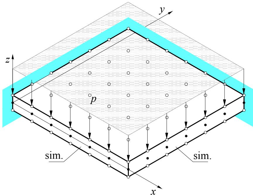
Slika 90. Izometrijski prikaz četvrtine kvadratne ploča uklještene po svim stranicama
