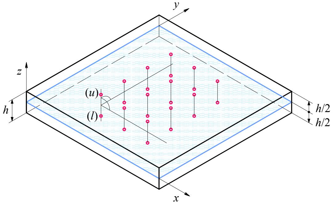
Slika 1. Geometrija ploče s dva čvora po debljini
