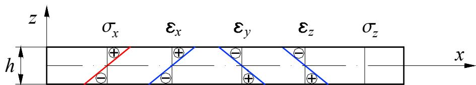
Slika 73. Točna raspodjela komponenata naprezanja i deformacija za čisto savijanje ploče
