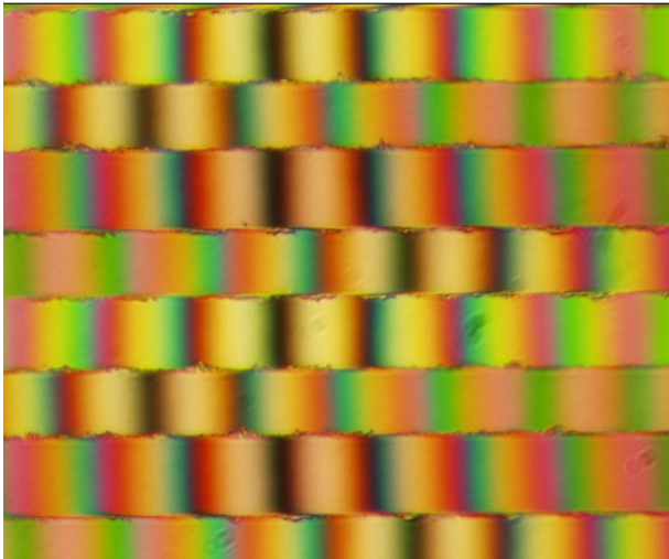
Slika 6.22 Etalon nazivne dubine brazde 800 nm. Interferogram primarne strukture Si/SiO 2
