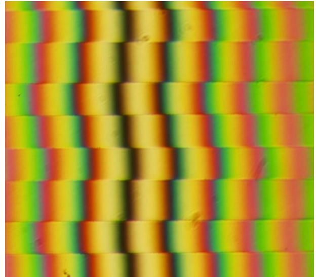
Slika 6.19 Etalon nazivne dubine brazde 50 nm. Interferogram na površini prevučenoj kromom
