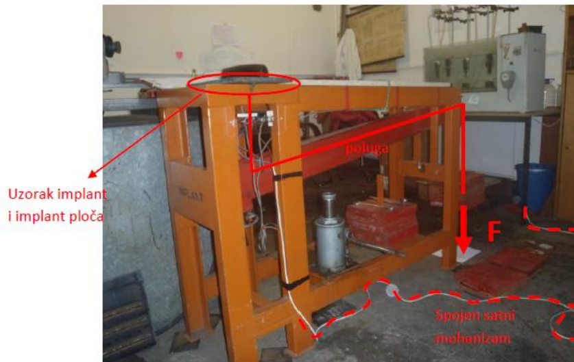
Slika 3.10. Prikaz opterećenja implant uzorka.
