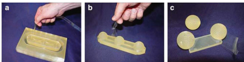
Slika 4.17. Postupak odvajanja viška materijala [12]
