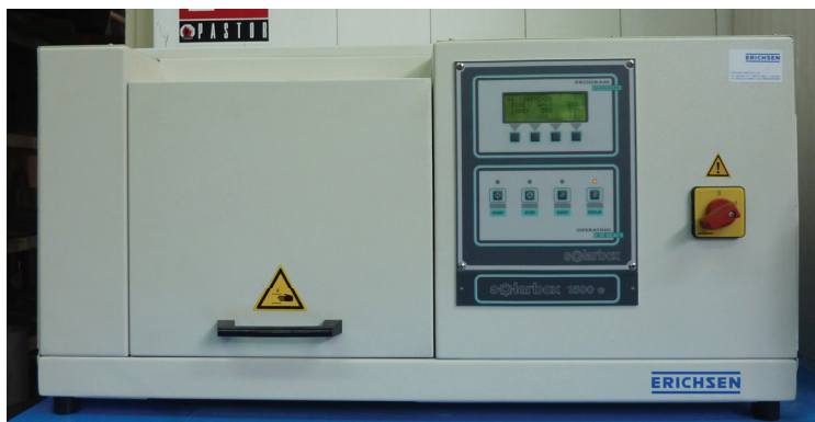
Slika 6.12. Komora za ispitivanje izlaganja izvorima svjetla
