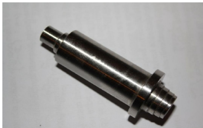
Slika 10: „Bravice“ rađene na CNC obradnom centru
