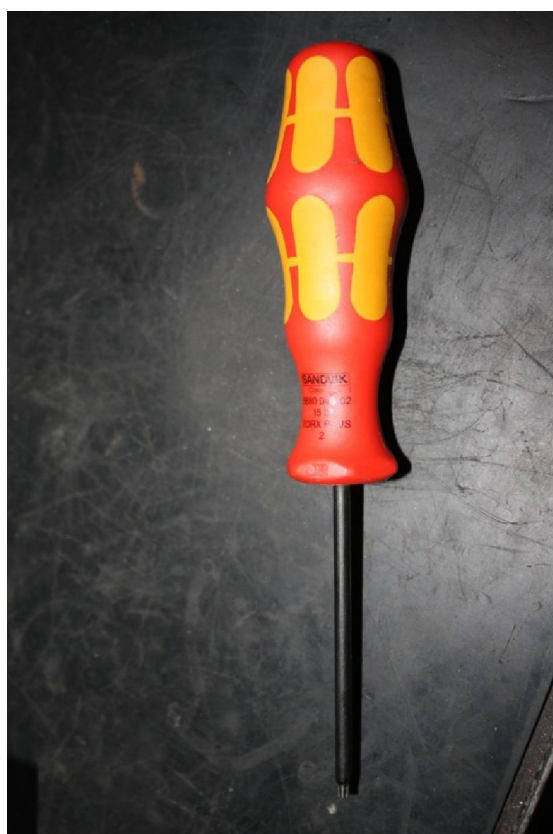
Slika 21: Alat za mijenjanje plo ica
