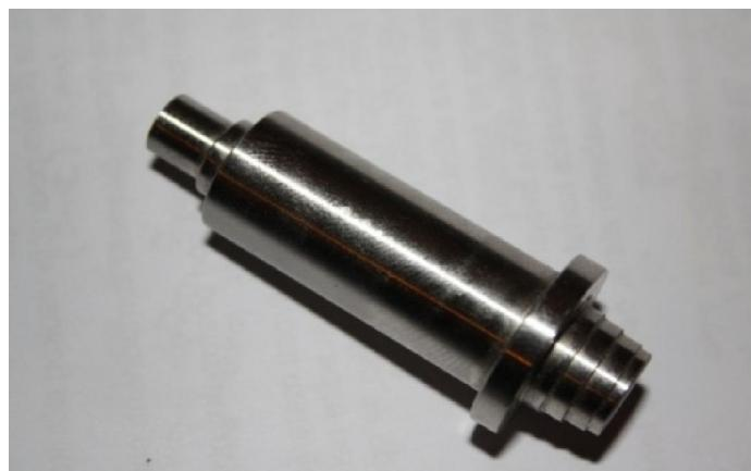
Slika 10: „Bravice“ rađene na CNC obradnom centru
