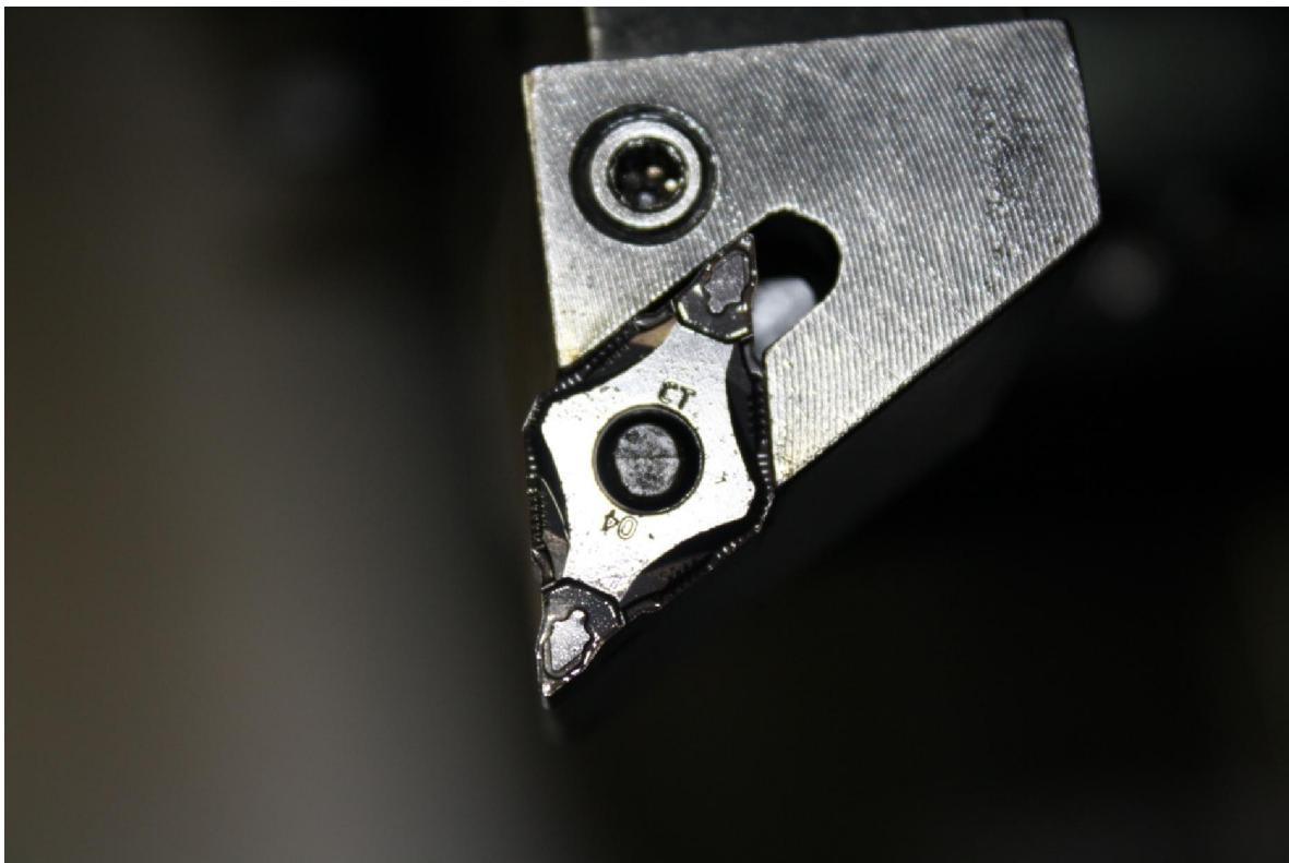
Slika 19: Rezni alat na držaču
