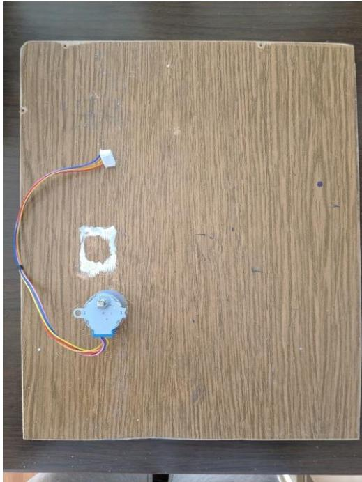
**Slika 3.4. Spoj prvog koračnog motora s podlogom manipulatora**
