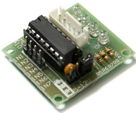
**Slika 2.7. Upravljački sklop za unipolarne koračne motore *ULN2003A* [9]**
