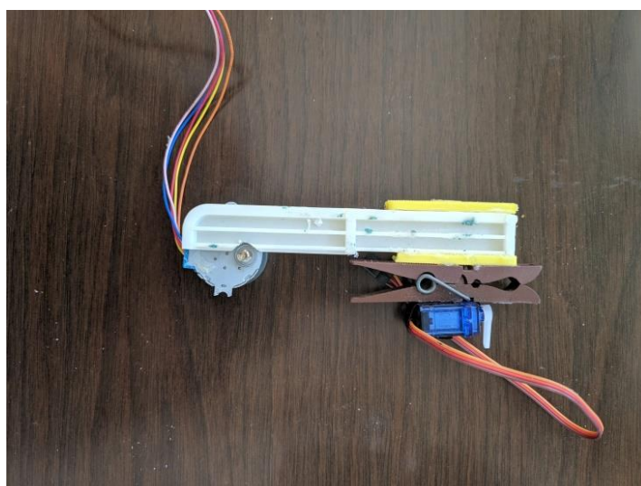
Slika 3.6. Spoj štapa vanjske ruke manipulatora s drugim koračnim motorom
