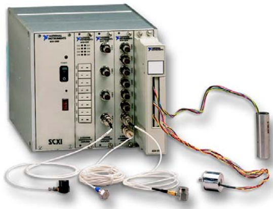
Slika 4-17. SCXI kućište s modulima i različitim osjetnicima
