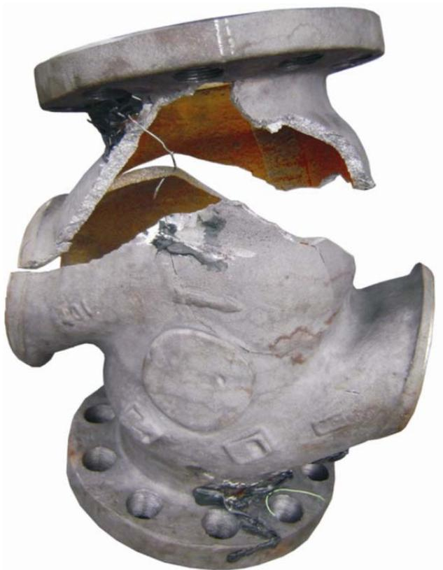
Slika 4.4 Prikaz slomljenog kućišta
