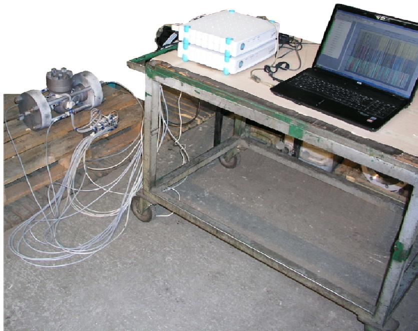
Slika 4.15 Ispitivanje deformiranja kućišta ventila
