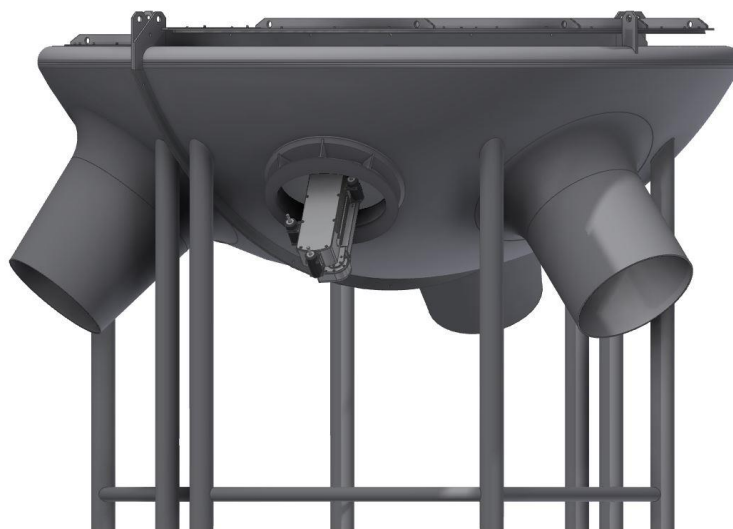
Slika 50. Ulazak manipulatora u kalotu
