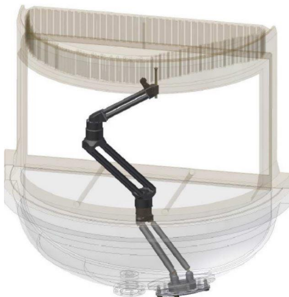
Slika 15. Prototip Spyder M1 u radnom položaju [18]
