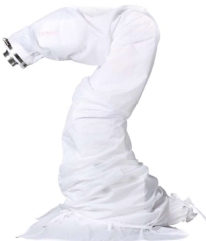
Slika 39: Zaštitni rukav robotske ruke [40]
