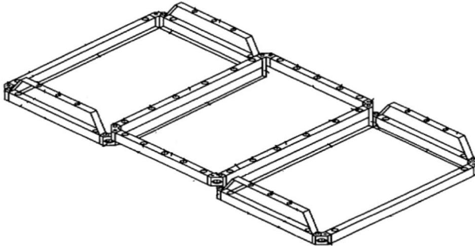
Slika 25 Sistem za povezivanje modulu i prigušenje vibracija [11]
