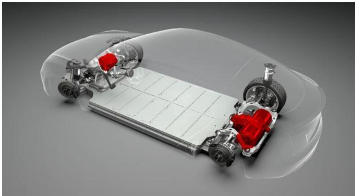
**Slika 28 „Floor“ konfiguracija baterijskog paketa (Tesla Model S)**
