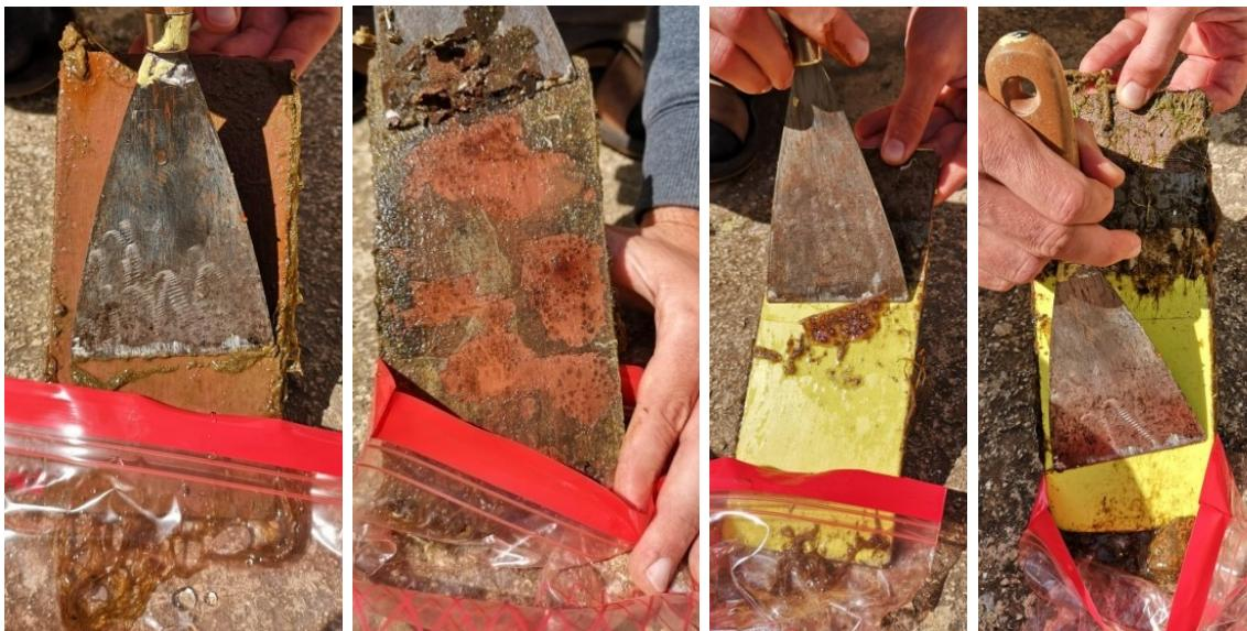
Slika 25. Skidanje obraštaja s uzoraka za terensko ispitivanje
