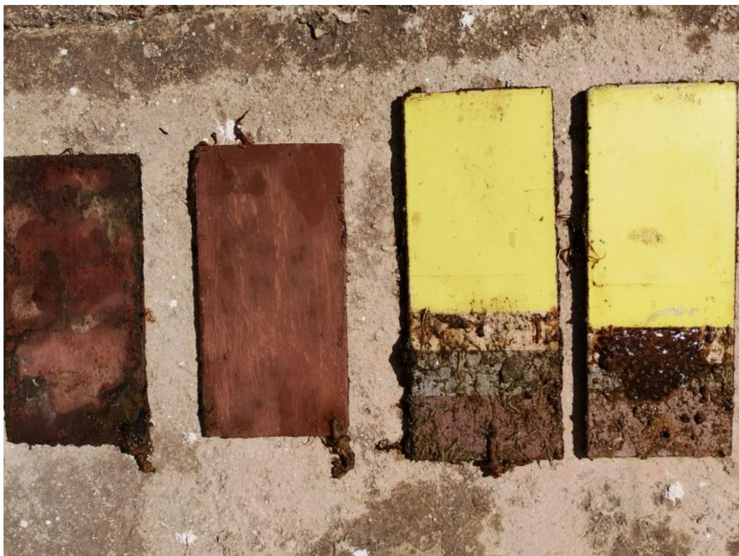
Slika 26. Stanje uzoraka nakon skidanja obraštaja
