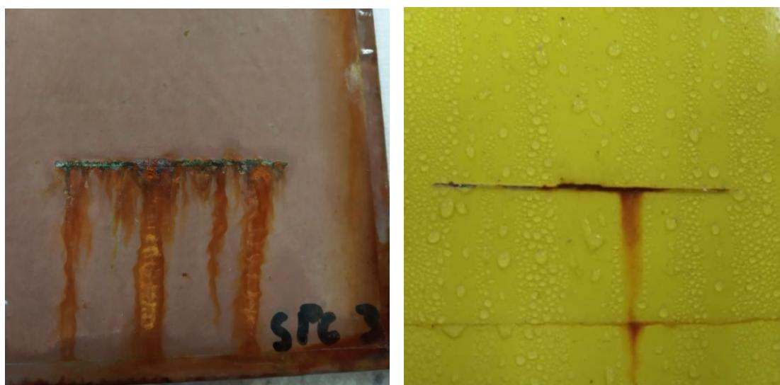
Slika 32. Detaljniji prikaz stanja uzorka u blizini ureza: samopolirajući premaz (lijevo), silikonski protuobraštajni premaz (desno)
