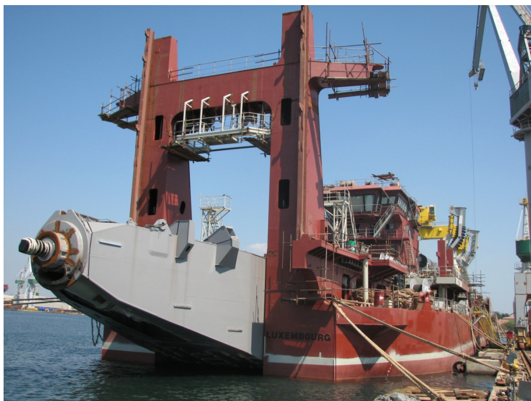
Slika 15. Ruka dredgera zaštićena sivim silikonskim antivegetativnim premazom u svrhu lakšeg održavanja
