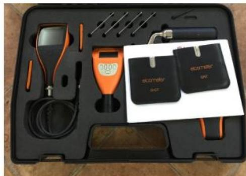
Slika 19. Mjerni set s uređajem Elcometer 456 za ispitivanje debljine prevlake
