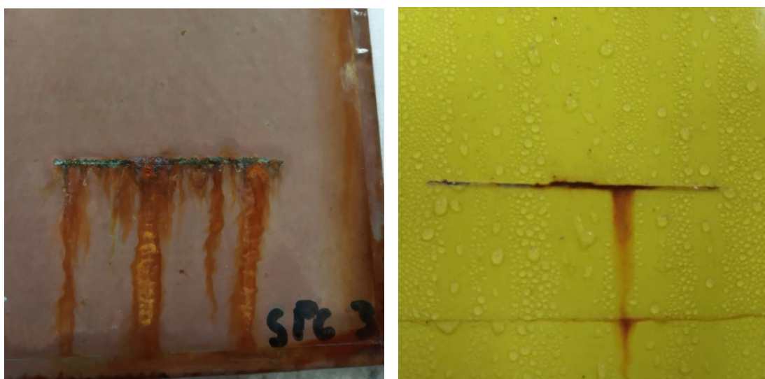
Slika 32. Detaljniji prikaz stanja uzoraka u blizini ureza: samopolirajući premaz (lijevo), silikonski protuobraštajni premaz (desno)
