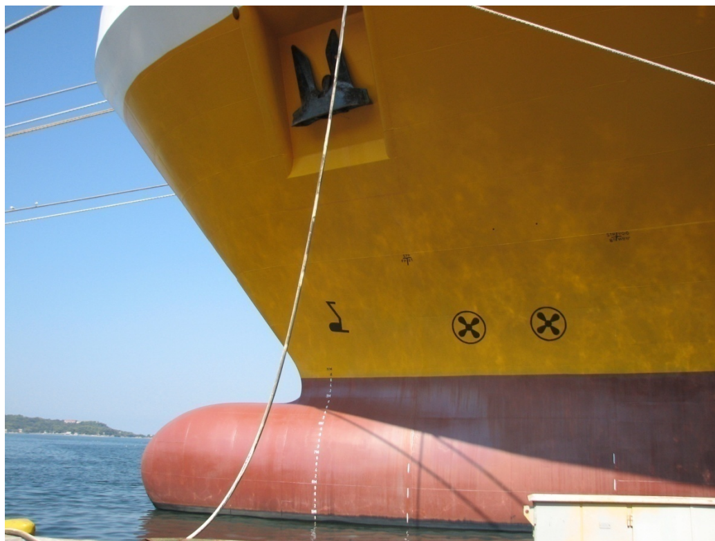
Slika 11. Pravilno nanesena antivegetativna zaštita na brodsku konstrukciju samopolirajućim SPC premazom
