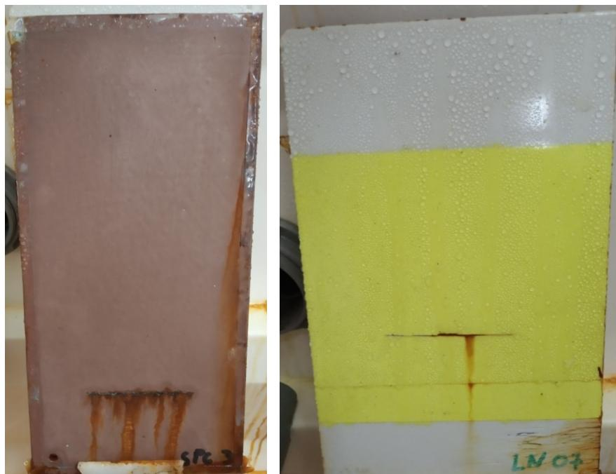
Slika 31. Izgled uzorka na kraju ispitivanja u slanoj komori
