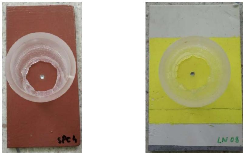
Slika 33. Prikaz oštećenja na uzorcima i zaliđepljenih ćelija
