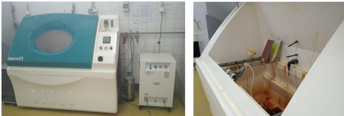
Slika 28. Komora Ascott S450 (lijevo); smještaj uzoraka u komoru (desno), Laboratorij za zaštitu materijala, FSB
