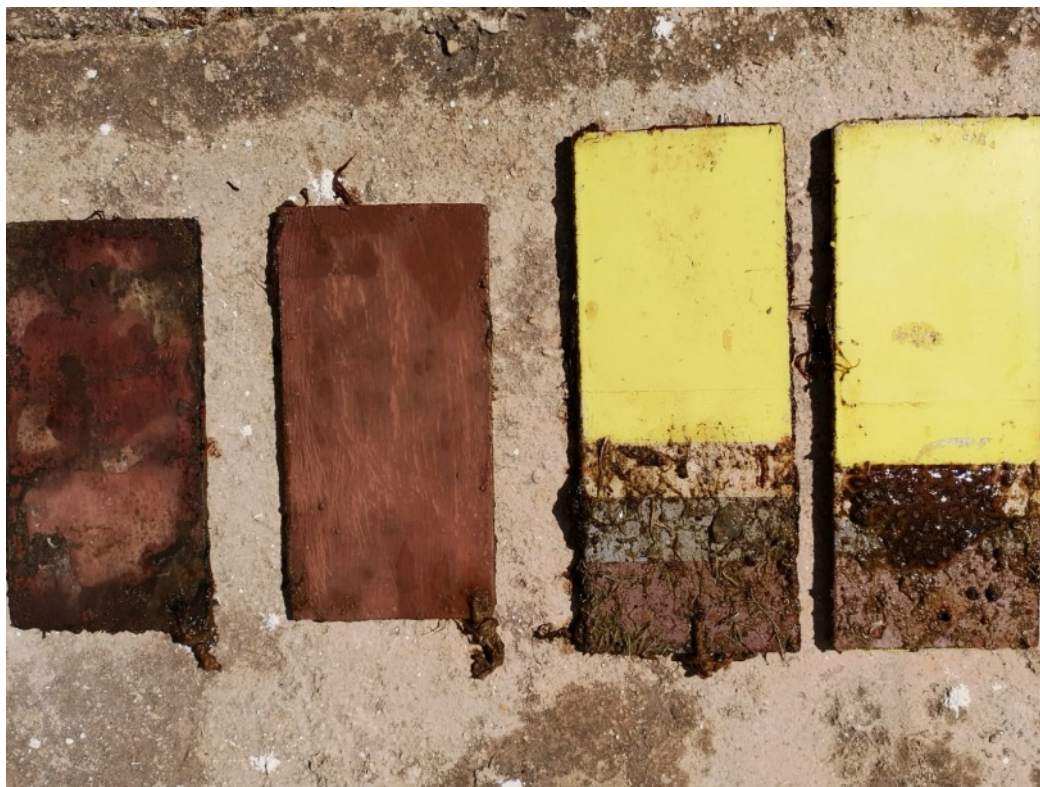
Slika 26. Stanje uzoraka nakon skidanja obraštaja
