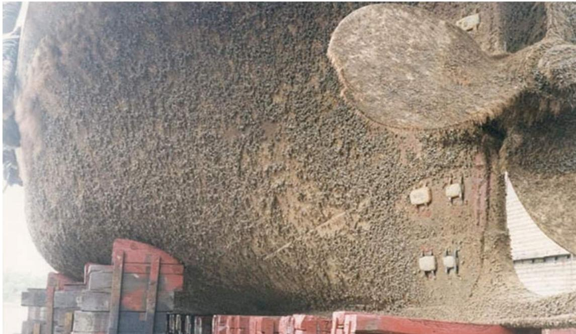
Slika 3. Obrasli propeler i podvodni dio trupa
