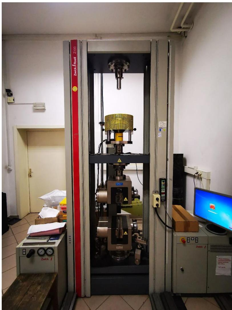
Slika 4. Univerzalna vlačno tlačna kidalica Zwick Z100
