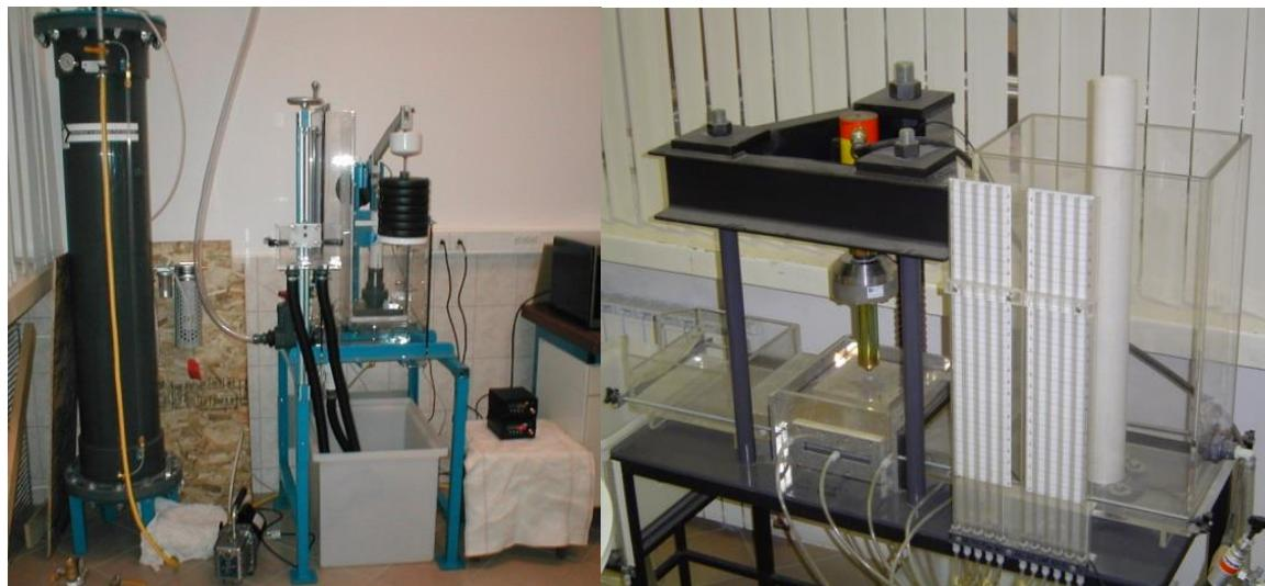
**Slika 2. Uredaj za ispitivanje vodopropusnosti geotekstila u ravnini i okomito na ravninu uzorka**
