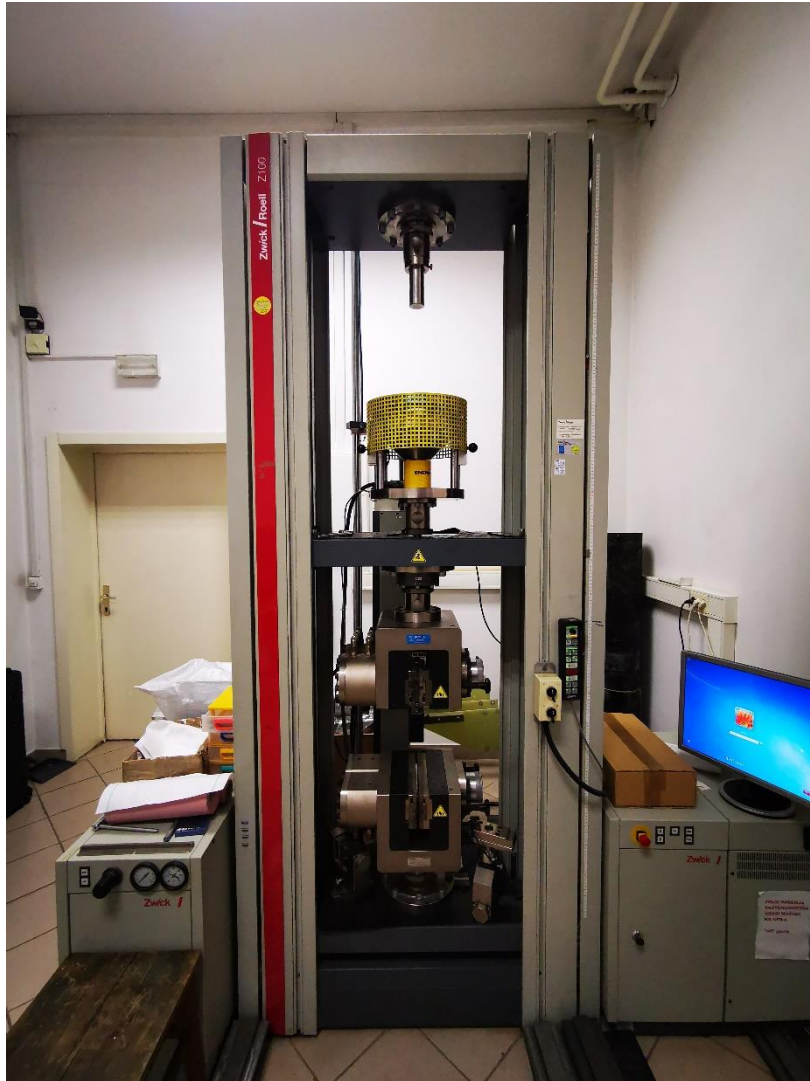
Slika 4. Univerzalna vlačno tlačna kidalica Zwick Z100
