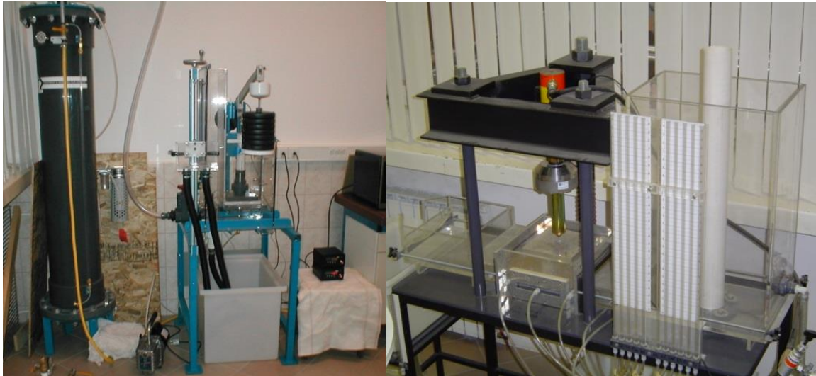
Slika 2. Uređaj za ispitivanje vodopropusnosti geotekstila u ravnini i okomito na ravninu uzorka
