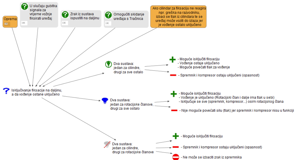
Slika 9-6: Isključivanje fiksacije na daljinu, a da vođenje ostane uključeno
