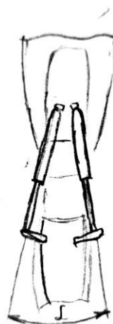
Slika 35. Način spajanja plinskih prigušivača
