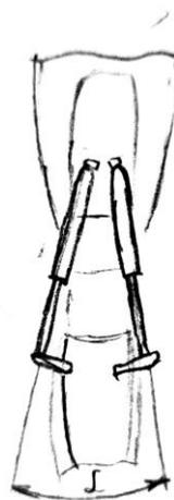
Slika 35. Način spajanja plinskih prigušivača
