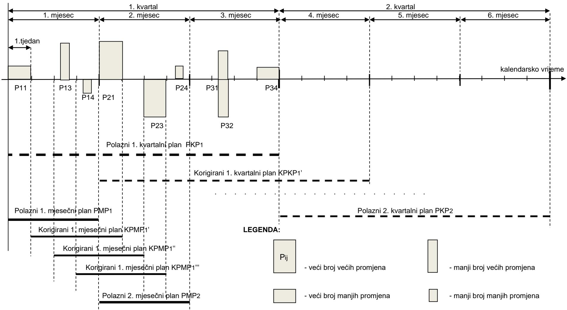
*Slika 24. Shematski prikaz diskretnog korektivnog dinamiziranog optimiranja*
