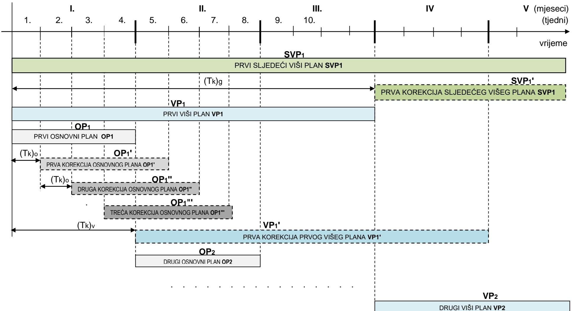
*Slika 6. Shematski prikaz principa kliznog planiranja i praćenja*
