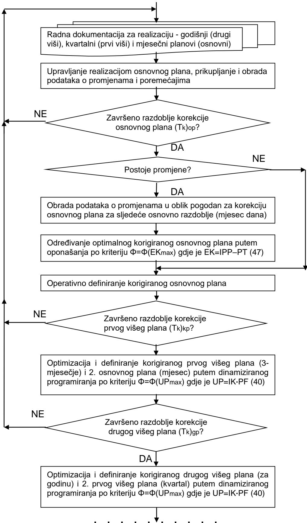
*Slika 25. Skraćeni blok-dijagram diskretnog korektivnog dinamiziranog optimiranja*
