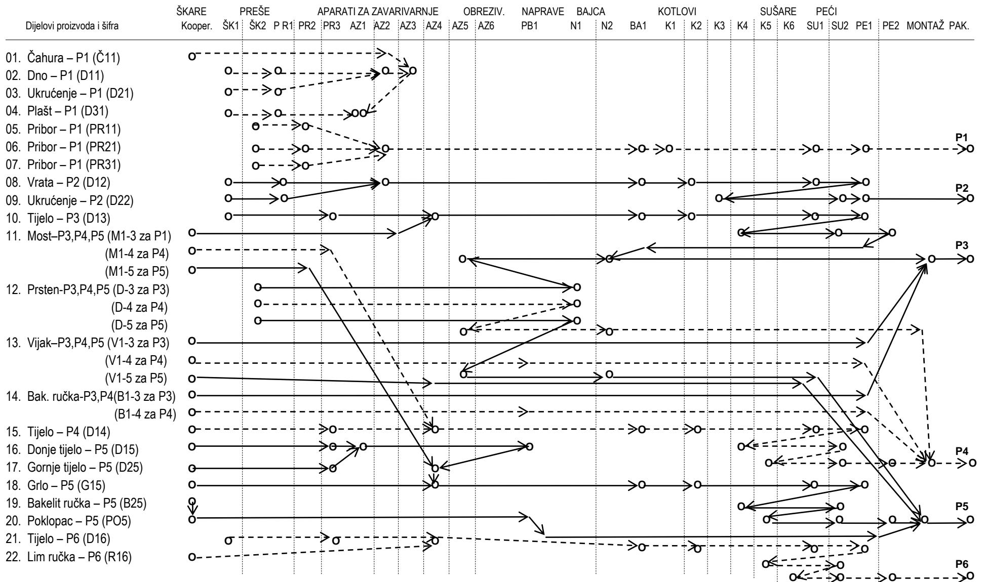
*Slika 9. Shematski prikaz toka proizvodnje grupa proizvoda u proizvodnji posuđa*
