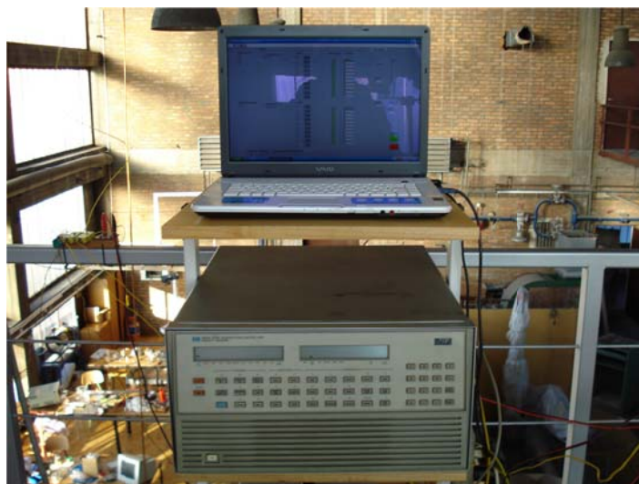
Slika 6.35 Sustav za prikupljanje i obradu mjerenih vrijednosti mjernih veličina
