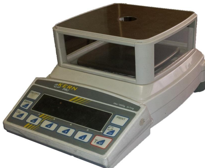
Slika 5.7 Vaga za mjerenje mase PRJ 1200-3N proizvođača Kern &amp; Sohn GmbH
