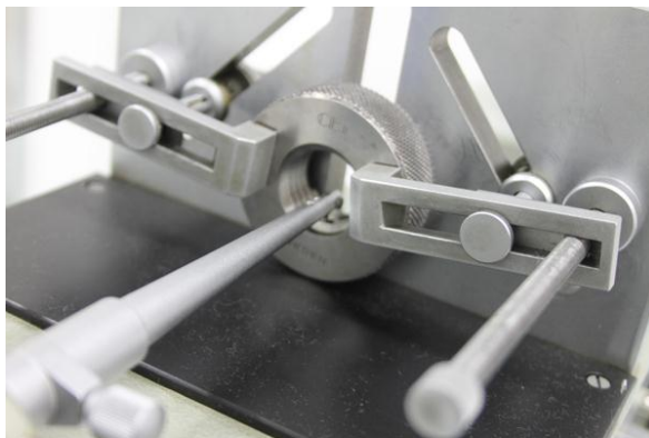
Slika 3-11 Mjerenje koraka unutarnjih navoja
