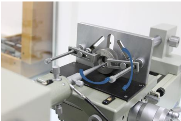
Slika 4-8 Mjerenje koraka unutarnjih navoja
