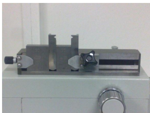
Slika 3-4 Stezna naprava za mjerke s V-utorom
