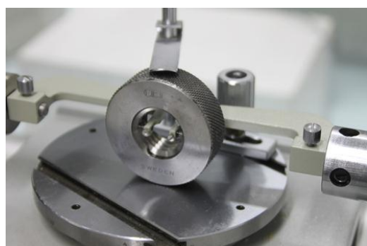
Slika 3-6 Mjerenje srednjeg promjera metodom s mjernim čeljustima
