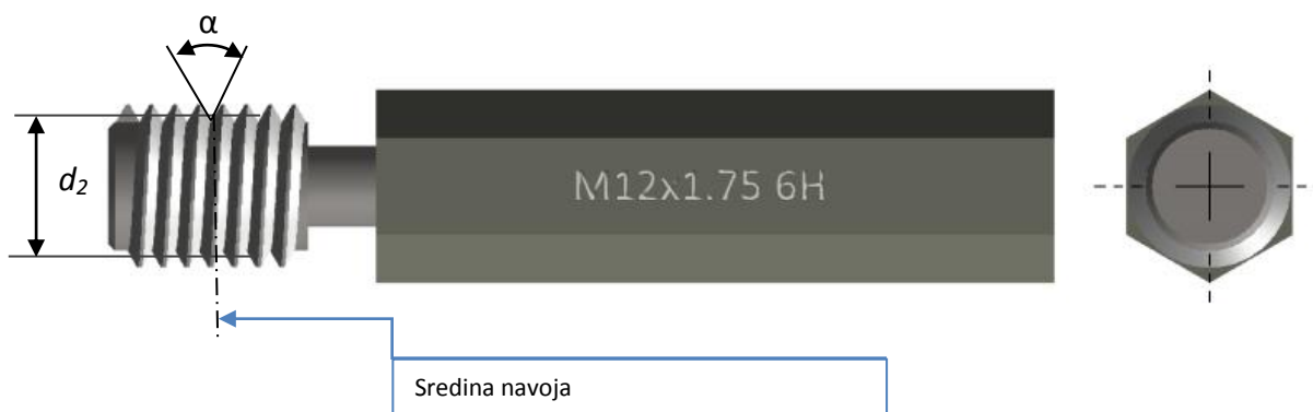
Slika 7-2 mjerna mjesta – navojni čep
