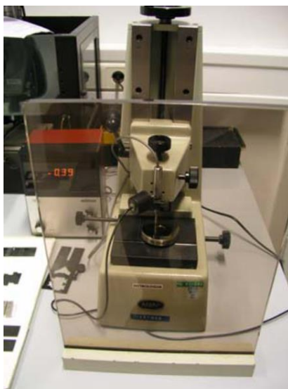
Slika 5.53. - Uređaj za mjerenje planparalelnosti površine [5]
