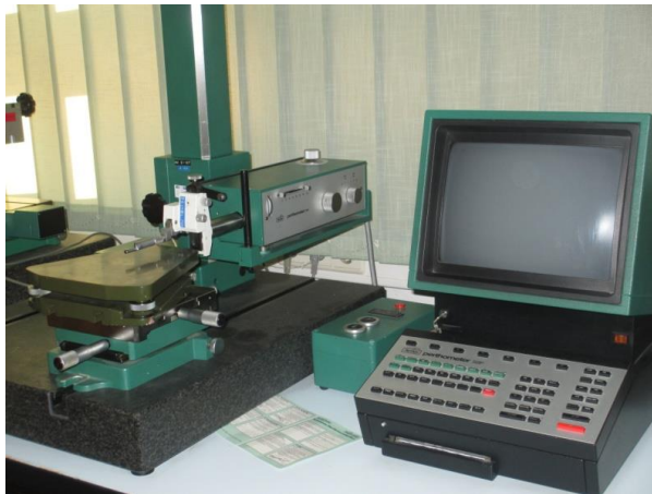
Slika 5.52. - Uređaj za ispitivanje hrapavosti površina [5]
