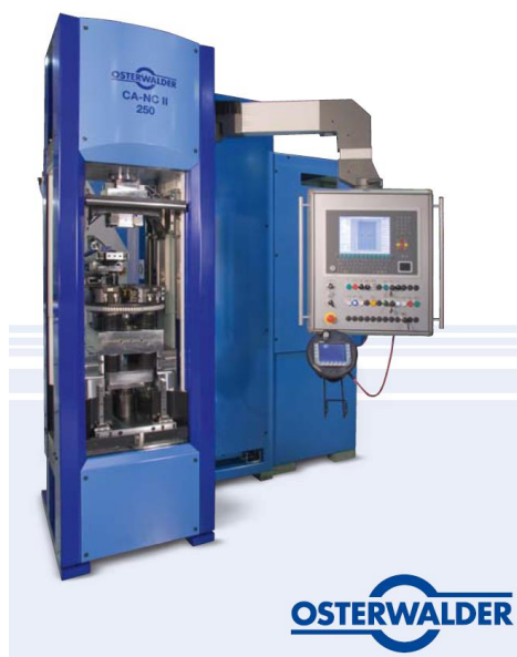
Slika 5.15. - Preša za jednoosno kompaktiranje proizvođača Osterwalder korištena pri sinter HIP- postupku
