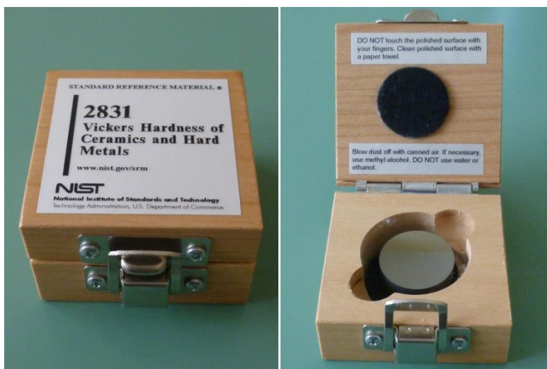
Slika 3.3. - Referentna pločica tvrdoće po Vickersu SRM 2831
