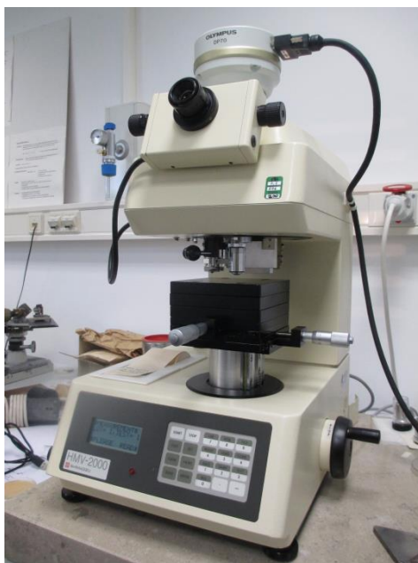
Slika 5.49. - Primarni etalon mikrotvrdoće u PTB-u
