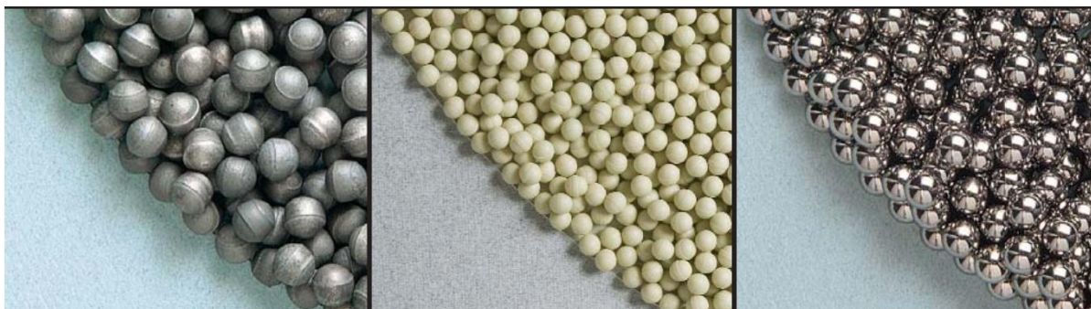
Slika 4.10. - Kuglice za mljevenje izrađene od različitih materijala [45]
