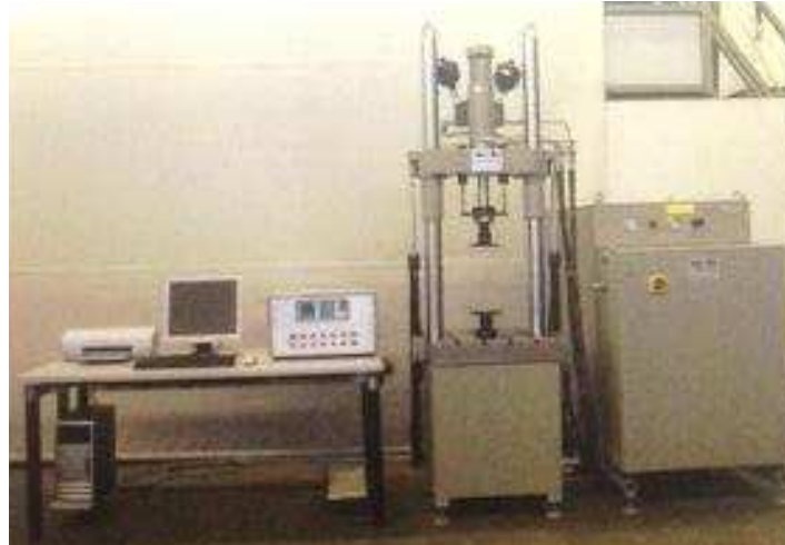
Slika 88. Servo-hidraulička umaralica Walter+bai AG, LFV 50 –HH
