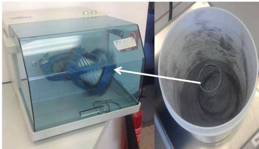
Slika 27. Postupak miješanja prahova u planetarnoj miješalici
