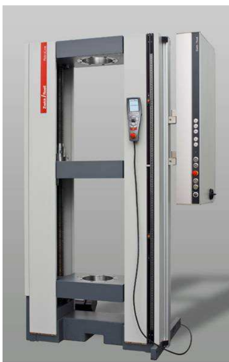
Slika 69. Zwick Roell kidalica, model 1474
