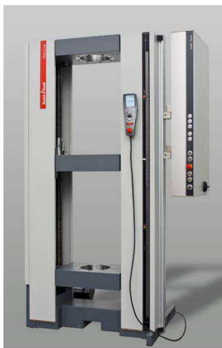
Slika 69. Zwick Roell kidalica, model 1474
