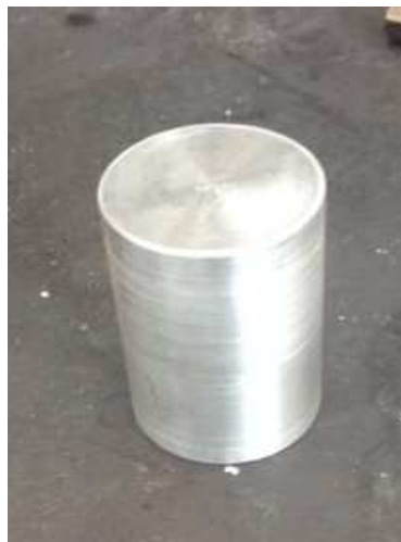
Slika 71. Izgled strojno obrađenog sirovaca prije vrućeg ekstrudiranja
