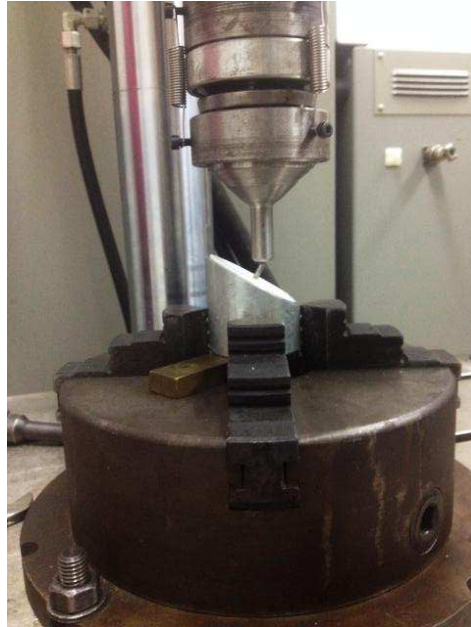
Slika 89. Uzorak pozicioniran na umaralici
