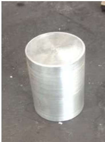
Slika 71. Izgled strojno obrađenog sirovaca prije vrućeg ekstrudiranja
