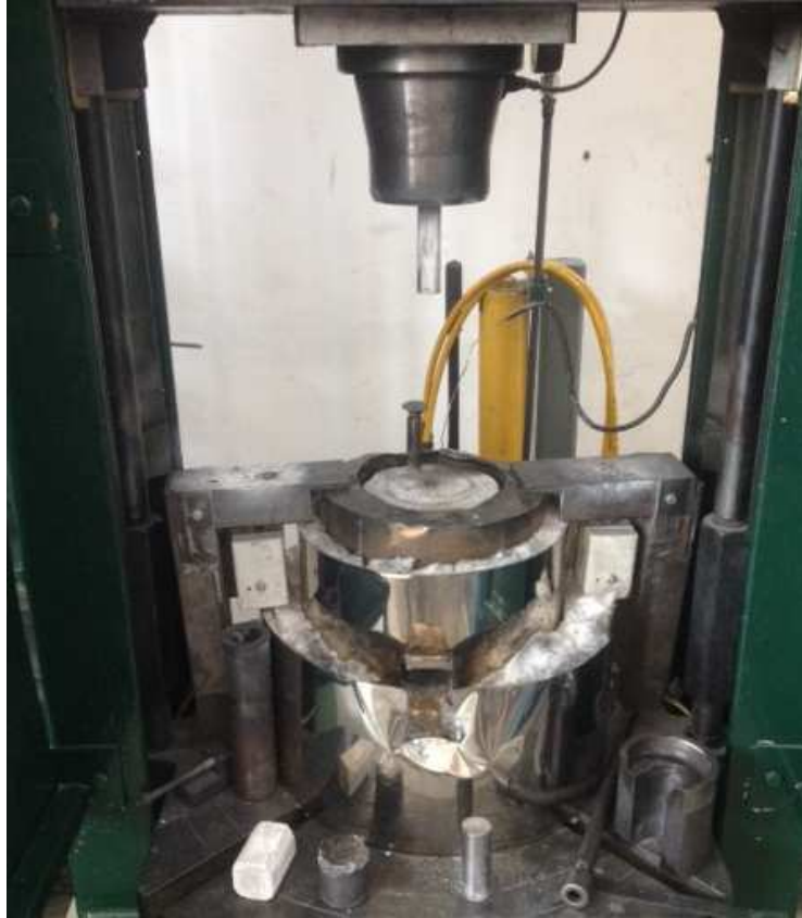
Slika 72. Preša i kalup za vruće ekstrudiranje uzoraka
