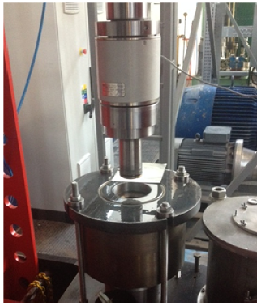
Slika 30. Sklop za hladno izostatsko prešanje (preša i kalup)
