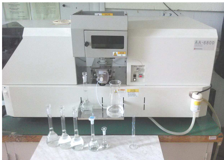
Slika 35. Analiza uzoraka vode na atomskom apsorpcijskom spektrometru Shimadzu AA – 6800 [225]
