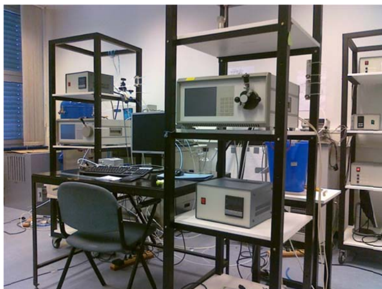
Slika 7. Fotografije sastavljenog primarnog niskotemperaturnog generatora injišta/rosišta zraka (plina).
