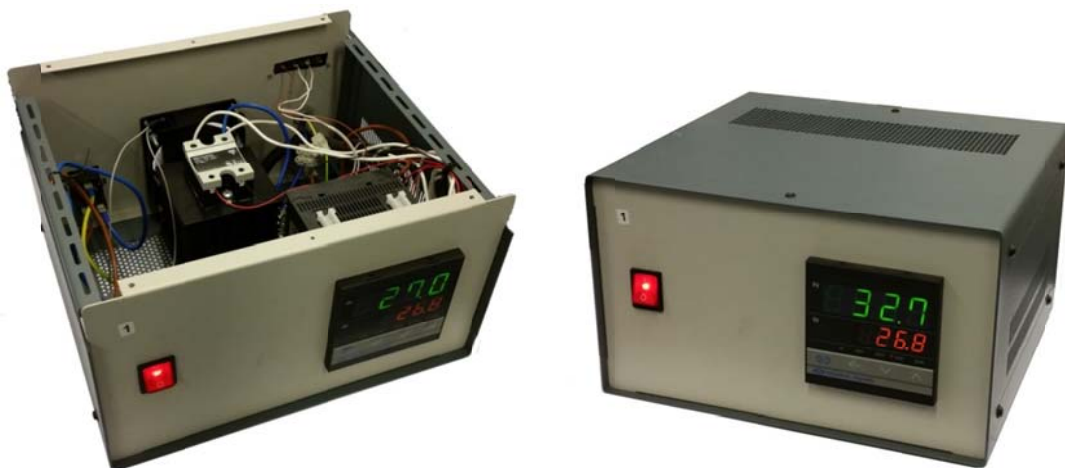
Slika 13. Regulator temperature grijača izlazne cijevi LRS-a.
