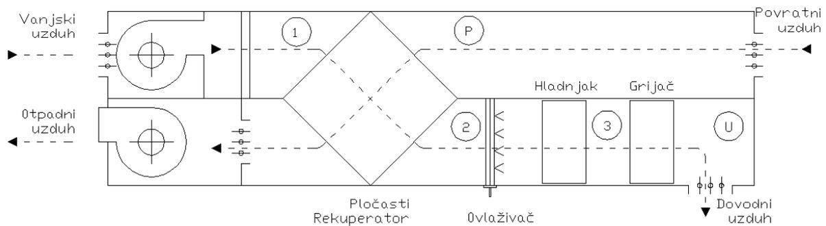
Slika 32. Shema spajanja elemenata za kondicioniranje uzduha
