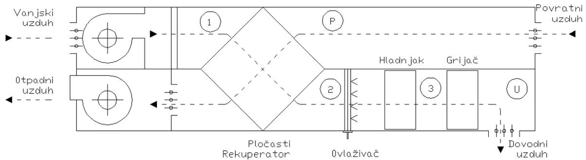
Slika 35. Shema spajanja elemenata za kondicioniranje uzduha
