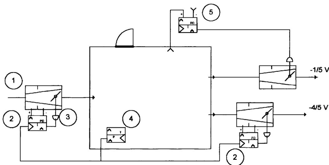
**Slika 19.**Regulacija sobnog tlaka s dodatnim rasterećenjem ("bypass")
