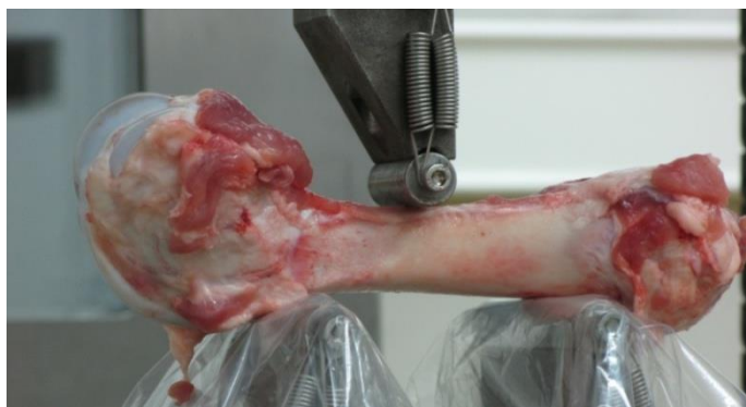
Slika 22. Eksperimentalni postav za savijanje svinjskih femura u tri točke
