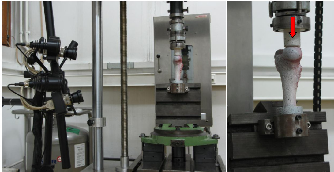
Slika 29. Eksperimentalni postav: a) optički sustav Aramis i pozicionirani ispitni uzorak, b) uvećani detalj ispitnog uzorka i adaptera za prijenos opterećenja s aksijalnim ležajem
