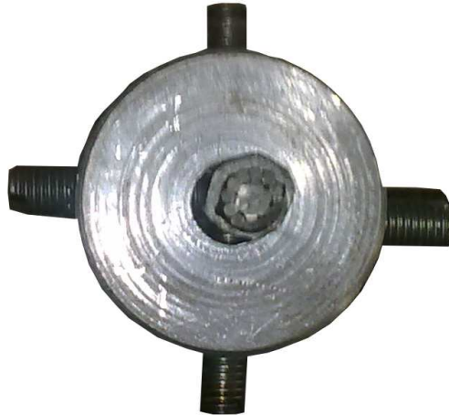
Slika 44. Uteg pričvršćen na glasničko uže
