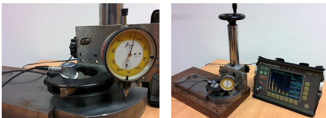
Slika 21. Naprava za prihvat sonde
