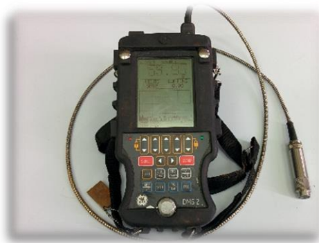
Slika 4. Ultrazvučni uređaj za mjerenje debljine s numeričkim i A prikazom
