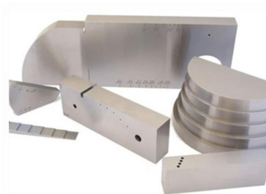
Slika 16. Referentni uzorci i etaloni [51]
