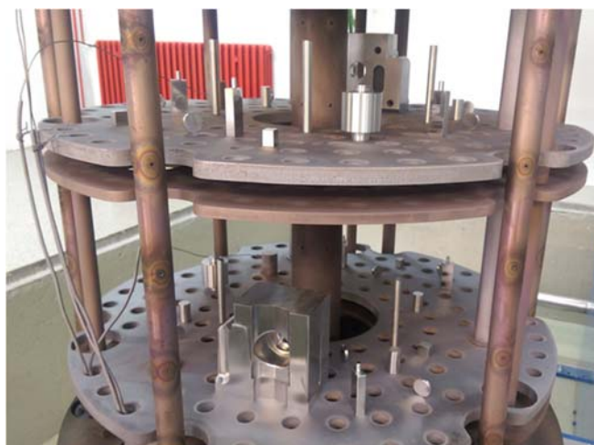
Slika 4.8 Raspored uzoraka od čelika X38CrMoV5-3 prije prevlačenja gradijentnom TiCN prevlakom
