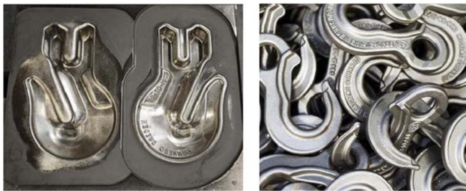
Slika 2.7 a) alat za kovanje kuka za dizalice b) otkovak [55]
