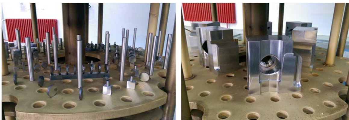
Slika 4.5 Raspored uzoraka za laboratorijska ispitivanja i segmenata kalupa za tlačni lijev u uređaju za plazmatsko nitiranje
