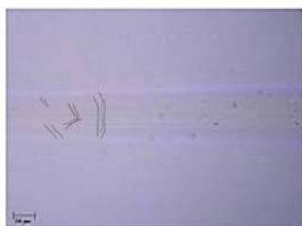
Pojava prvih pukotina L_{c1}
