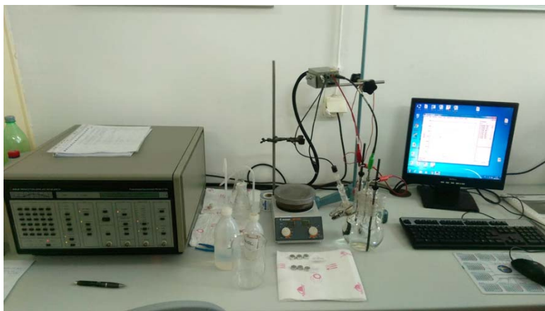
Slika 4.59 Oprema za ispitivanje otpornosti na koroziju DC metodom
