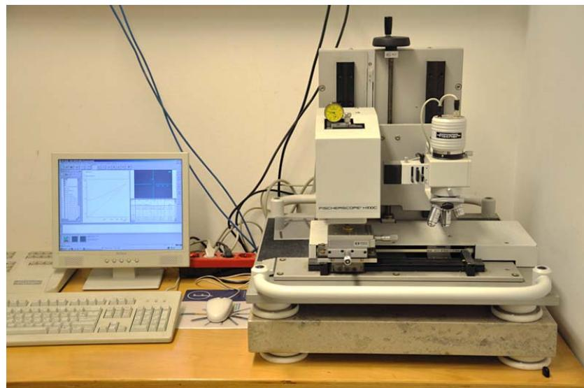
**Slika 4.44 Tvrdomjer Vickers Helmut Fisher Fisherscope H100C za mjerene tvrdoće prevlaka**
