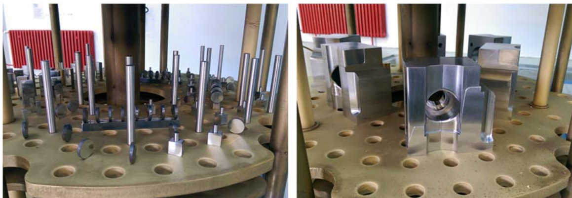
Slika 4.5 Raspored uzoraka za laboratorijska ispitivanja i segmenata kalupa za tlačni lijev u uređaju za plazmatsko nitriranje
