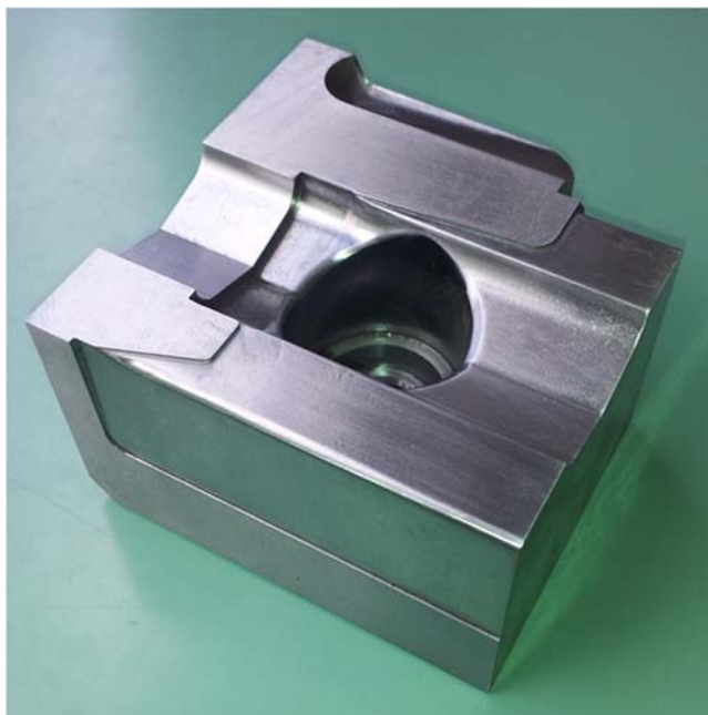
Slika 4.1 Segment kalupa za tlačni lijev aluminijskih radijatora tvrtke Lipovica d.o.o. od čelika X38CrMoV5-3 za ispitivanje u radnim uvjetima
