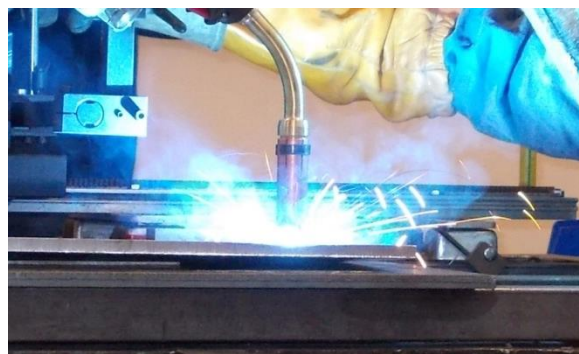
Slika 5.16 CBT MAG zavarivanje
