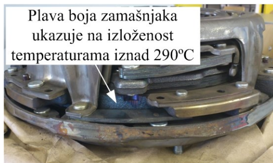
Slika 8-26: Fotografija 37k spojke
