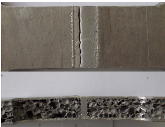
Slika 6.39. Prijelom epruvete B171
