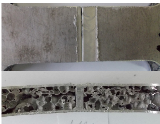
Slika 6.33. Prijelom epruvete A131
