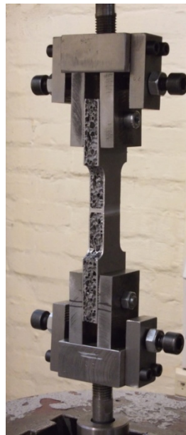
Slika 5.26. Statičko vlačno ispitivanje uzorka spoja aluminijskih sendvič panela
