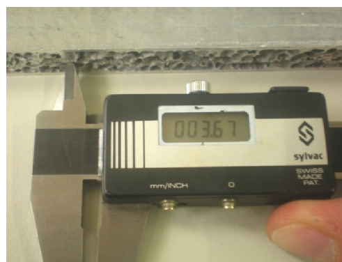
Slika 5.2. Mjerenje promjera pora digitalnim pomičnim mjerilom
