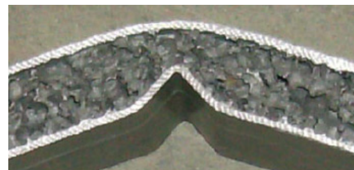
Slika 4.9. Deformacija uzorka nakon ispitivanja [105]
