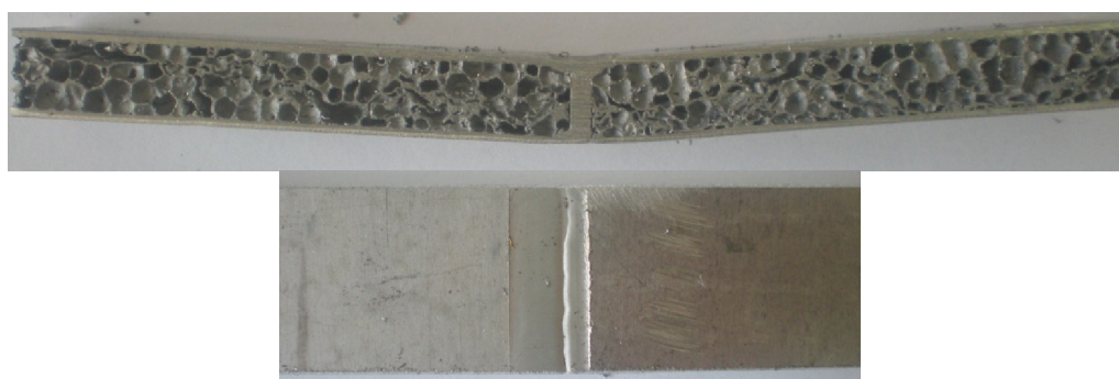
Slika 6.67. Prijelom epruvete B093
