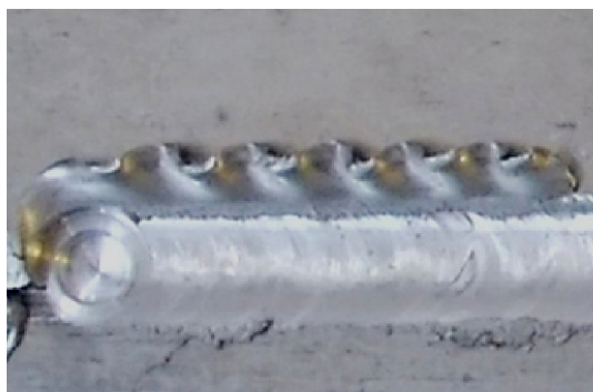
Slika 3.20. Primjer zavara s prekomjernim istiskivanjem materijala
