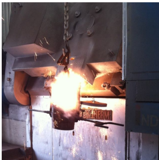
Slika 3.4 Ispust primarne taljevine iz peći u Sandwich lonac
