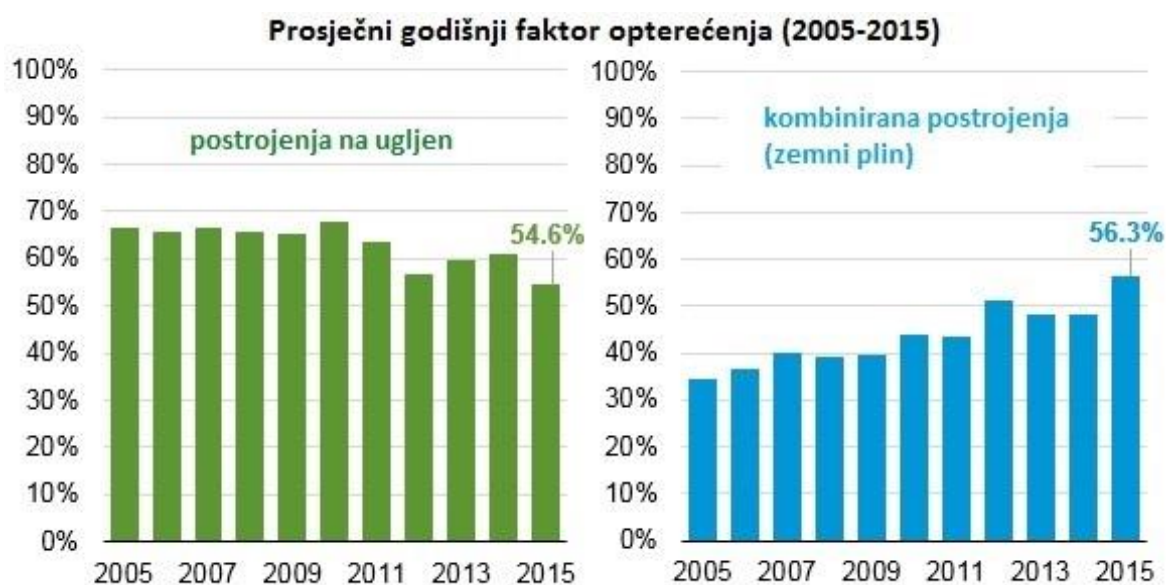
Slika 7.64 Prosječni godišnji faktor opterećenja kombiniranih postrojenja, 2005. – 2015. (SAD) [102]
