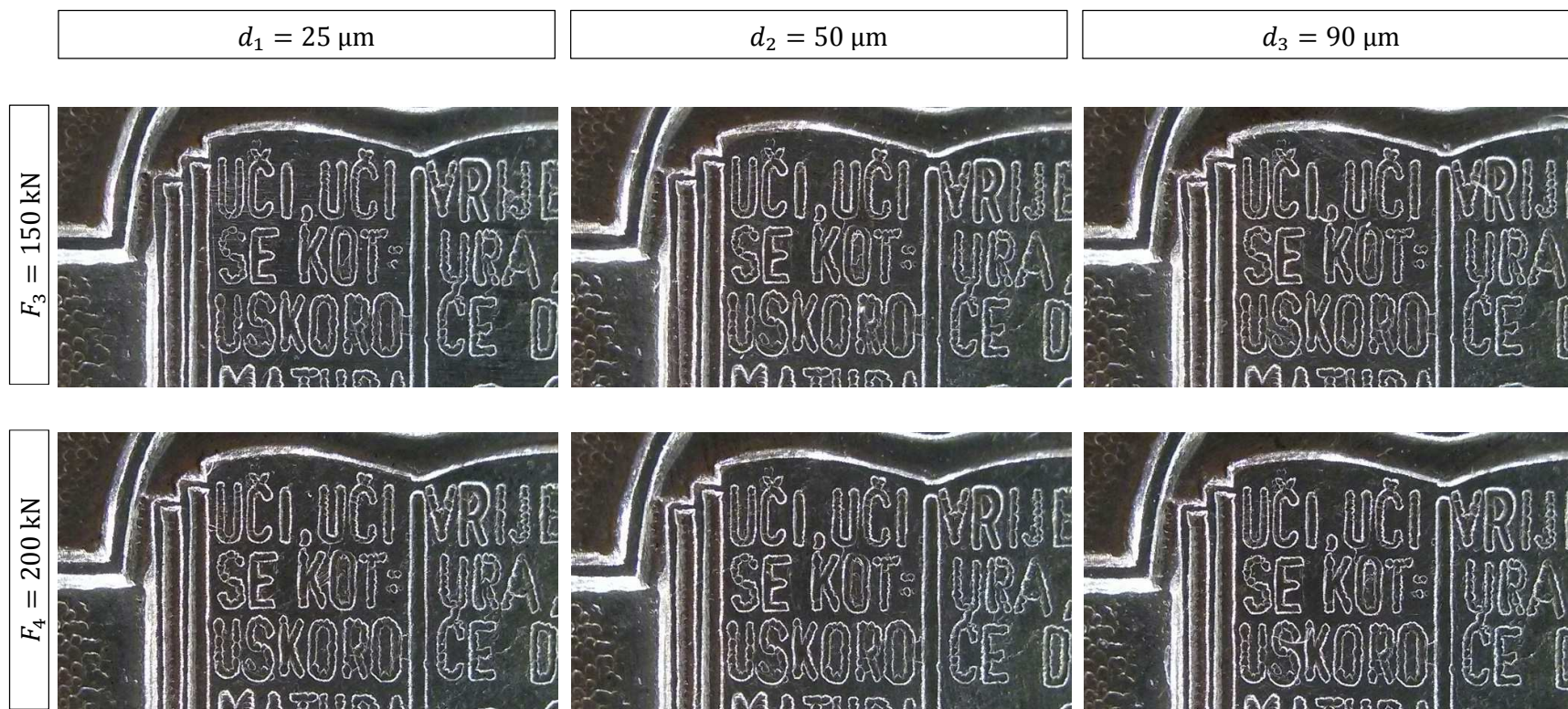
Slika 121: Detalji knjige na otkivcima različitih veličina kristalnih zrna kod sila kovanja 150 kN i 200 kN.
