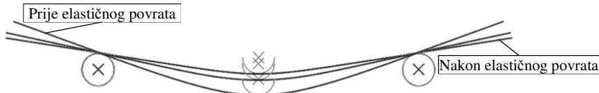
Slika 43: Postupak savijanja u tri točke [79].
