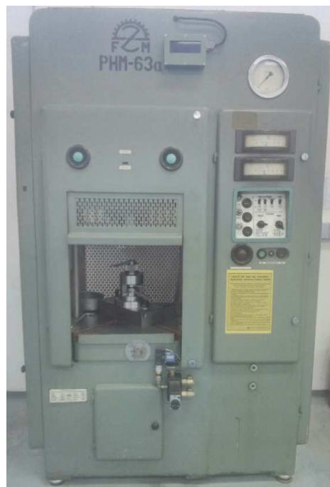
Slika 55: Hidraulična preša s montiranim alatom.
