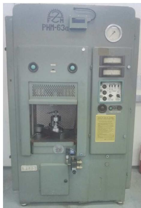
Slika 55: Hidraulična preša s montiranim alatom.
