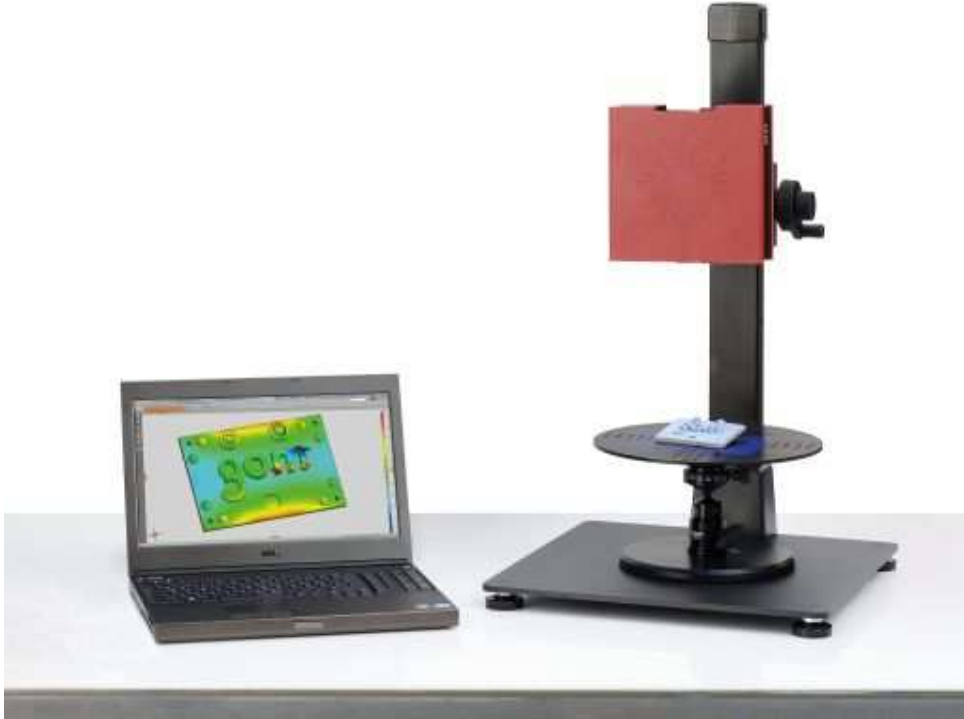
Slika 61: Optički mjerni 3D digitalizator ATOS [102].
