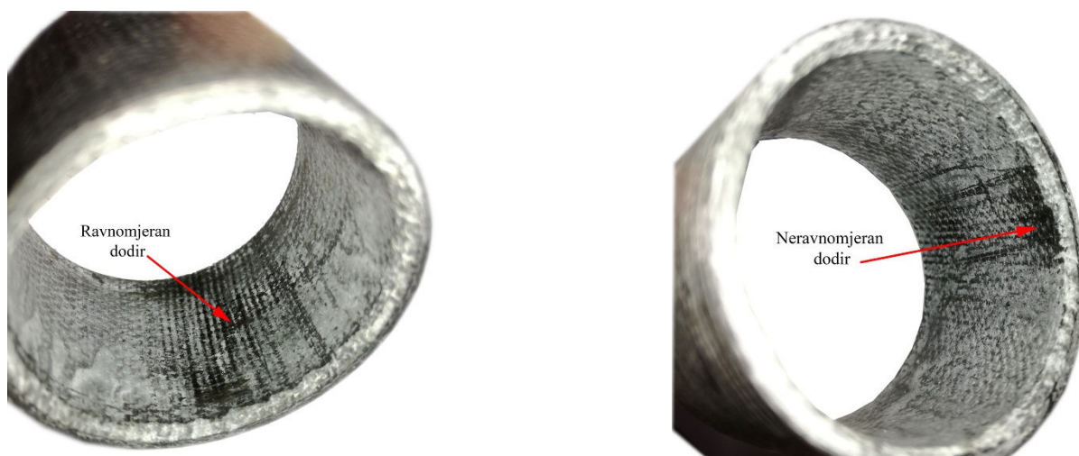
Slika 75. Ravnojeran i neravnomjeren dodir između kliznog ležaja s dodatkom maziva i rukavca
