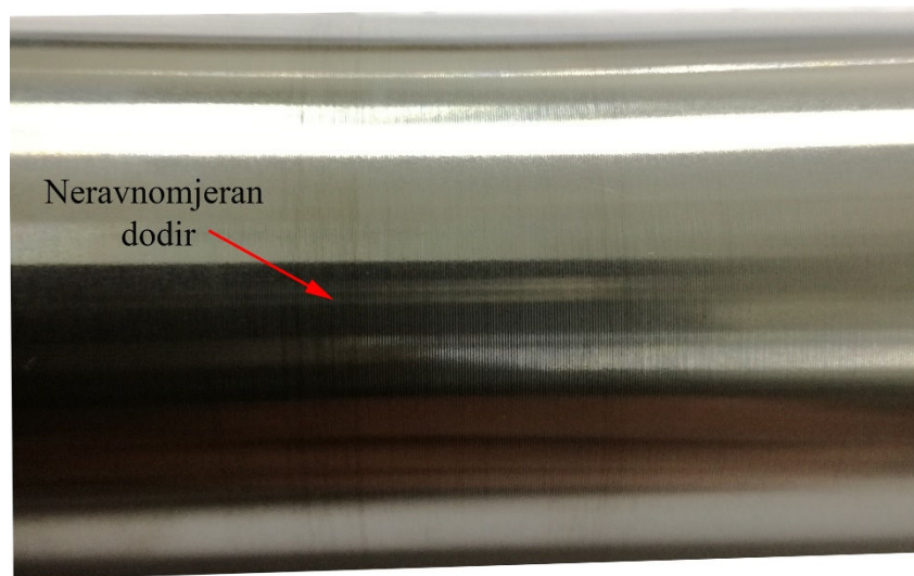
Slika 77. Vrlo malo oštećenje rukavca uslijed neravnomjernog dodira kliznog ležaja bez dodatka maziva
