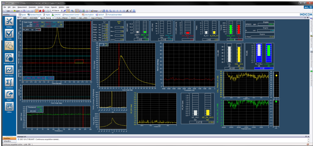
Slika 2.54. Izgled sučelja za indiciranje i nadziranje rada motora u programskom paketu AVL IndiCom [10]
