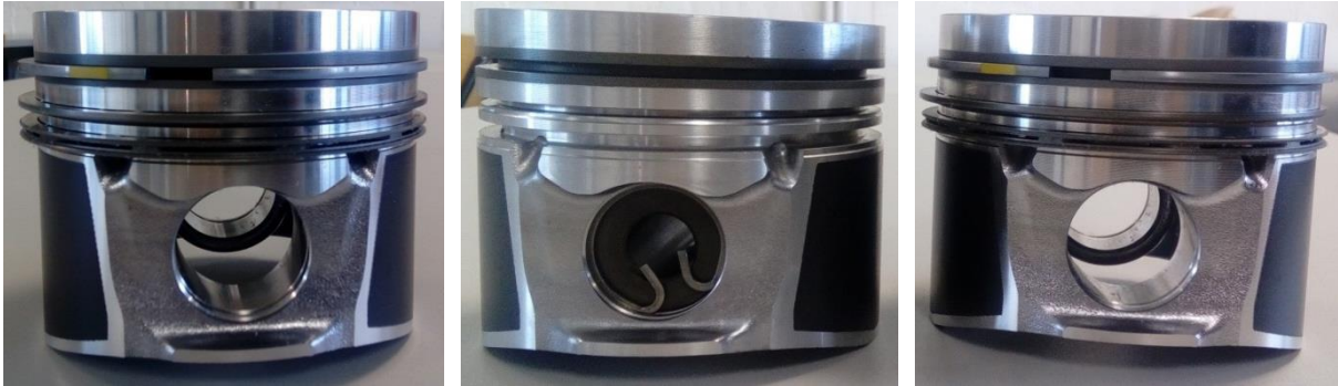
Slika 2.7. Originalni klip (lijevo), klip s visinom čela smanjenom za 3 mm (sredina) i klip s visinom čela smanjenom za 0,6 mm (desno)
