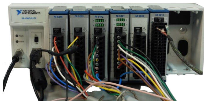
Slika 2.10. Uređaj NI cDAQ-9188 upotrebljen za upravljanje i prikupljanje podataka
