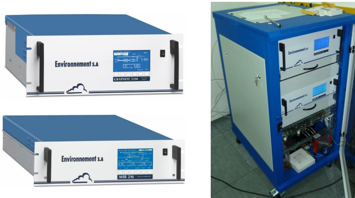
Slika 2.45. Uređaji za mjerenje emisija HC, CO i CO 2
