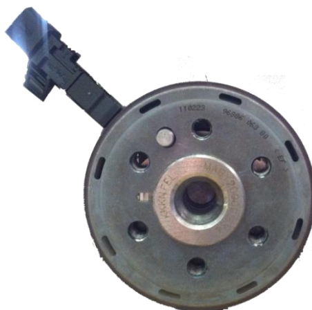
Slika 2.11. Hallov senzor prstena s magnetima na koljenastom vratilu
