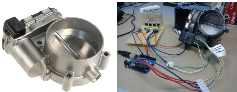
Slika 2.21. Zaklopka snage Bosch (lijevo), proba upravljanja zaklopkom (desno)
