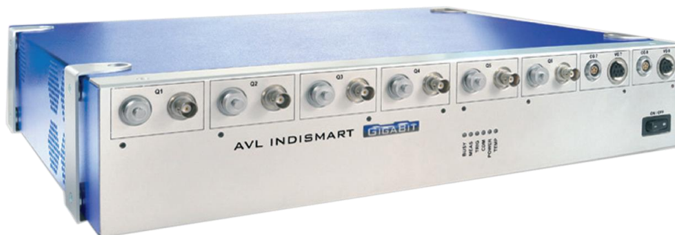
Slika 2.52. Uređaj za prikupljanje podataka AVL Indimodul gigabit 612 [9]
