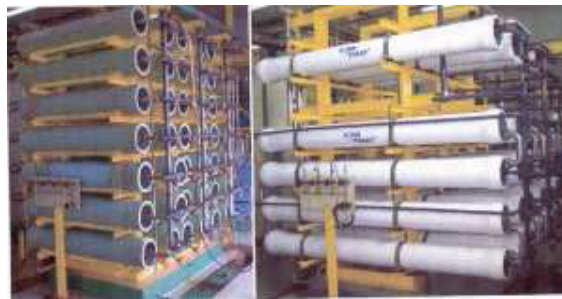
Slika 9. RO moduli u postrojenju za desalinizaciju
