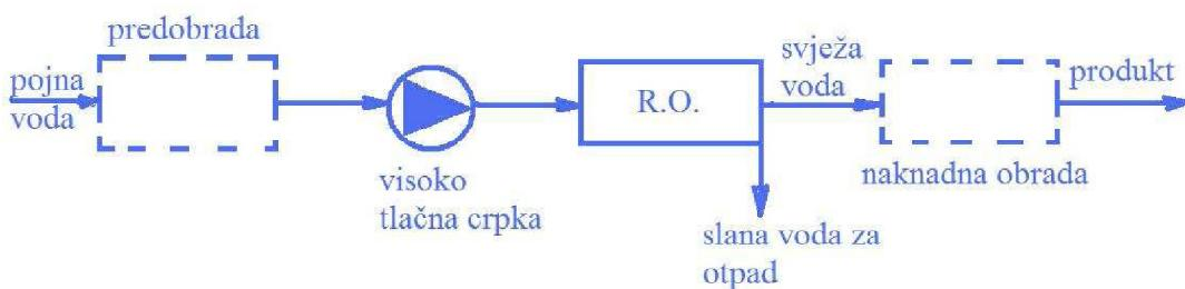
Slika 5. Osnovni dijagram sustava za reverznu osmozu
