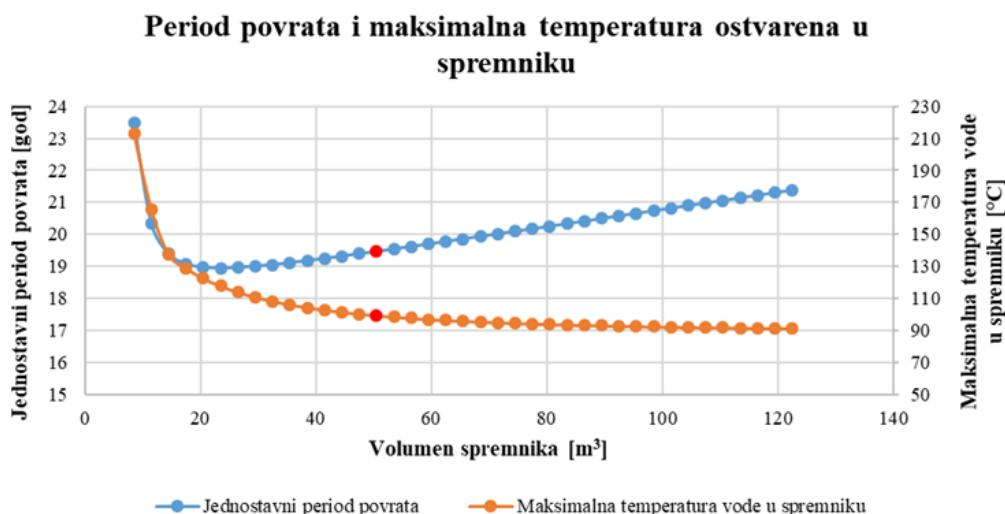
Slika 23. Određivanje minimalnog volumena spremnika za  $A=588 \text{ m}^2$
