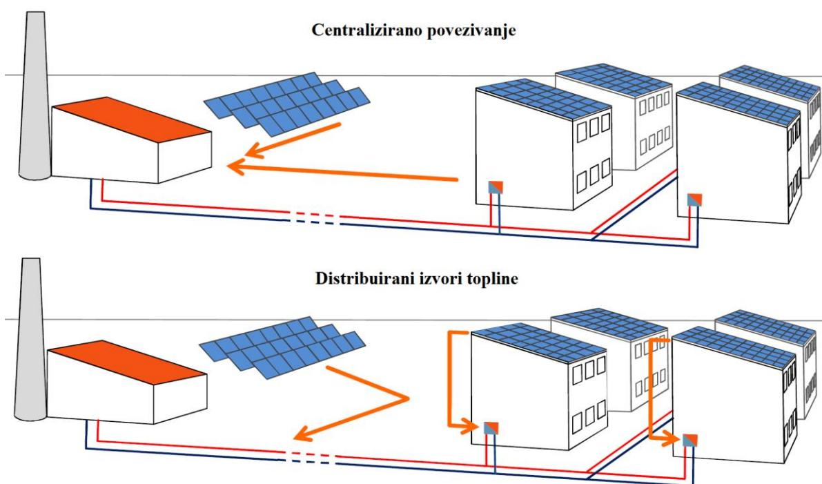
Slika 2. Integracija solarnih kolektora u sustav daljinskog grijanja
