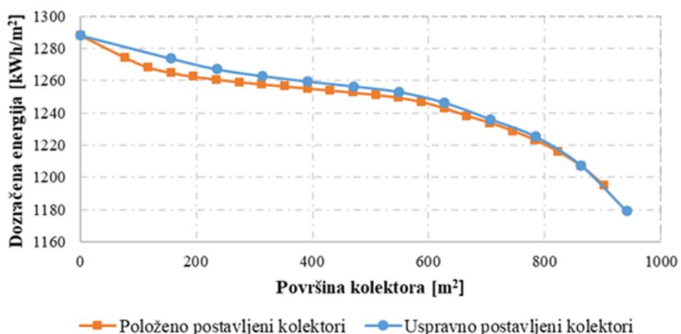
Slika 22. Usporedba dozračene energije po jedinici površine
