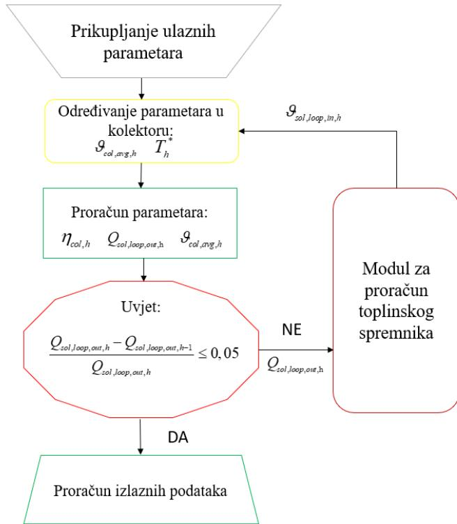
Slika 15. Tijek proračuna solarnog kolektora
