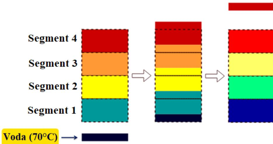
Slika 17. Shematski prikaz proračuna temperature u spremniku
