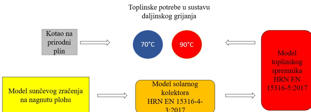
*Slika 6. Shematski prikaz modela solarnog toplinskog sustava*
