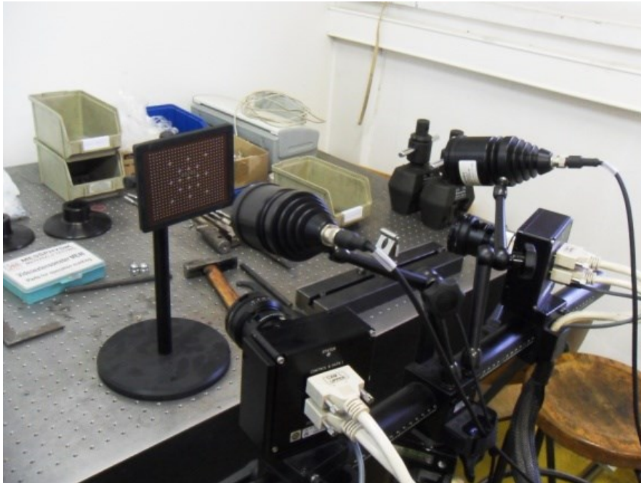
Slika 29. Kalibracija Aramis mjernog sustava [157]
