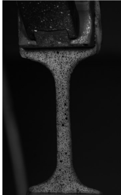
Slika 40. Uzorak aorte s nanesenim rasterom za ispitivanje DIC metodom
