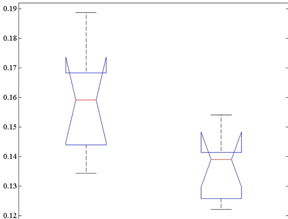
Slika 68. Rezultati analize varijance modula elastičnosti  $E_1$  za uzdužne svježe (lijevo) i uzorce odmrznute nakon devet mjeseci pohrane (desno)
