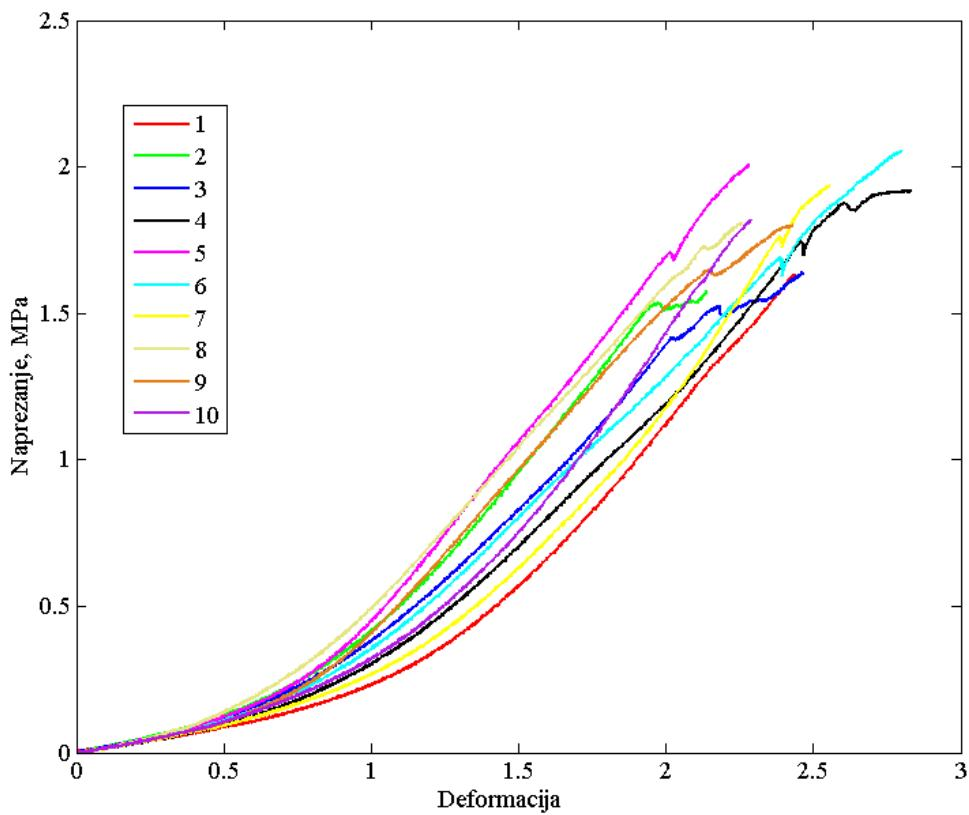
Slika 84. Dijagram *deformacija-naprezanje* poprečnih uzoraka aorte odmrznutih nakon četiri mjeseca pohrane
