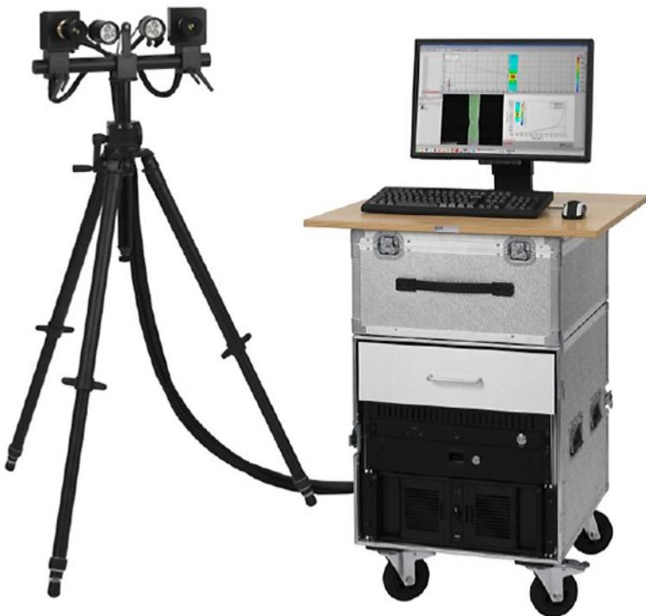
Slika 26. Optički sustav Aramis za mjerjenje pomaka DIC metodom (GOM GmbH, Njemačka)
