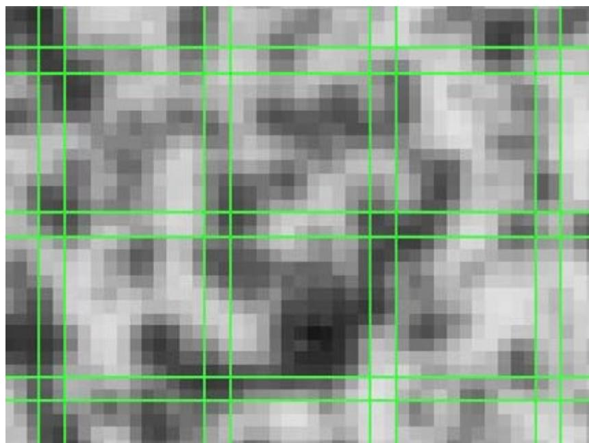
Slika 27. Faseta veličine 15x15 s dva preklapajuća piksela [158]
