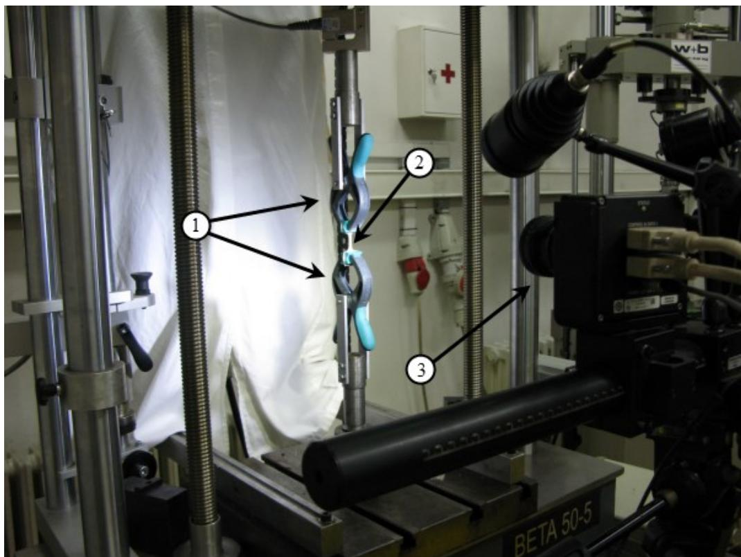
Slika 44. Eksperimentalni postav za provedbu vlačnog ispitivanja
