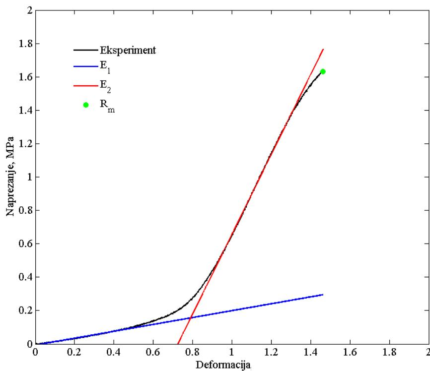
Slika 47. Dijagram *deformacija-naprezanje* s interpoliranim modulima elastičnosti
