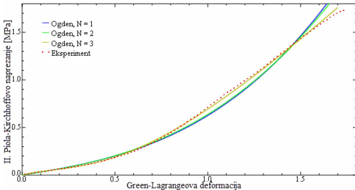
Slika 25. Ogden ( $N = 1, 2, 3$ ) materijalni modeli pridruženi eksperimentalnim rezultatima
