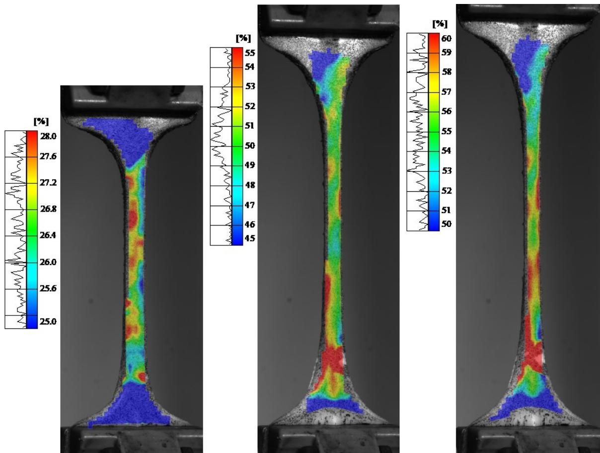
Slika 56. Porast polja deformacije prilikom eksperimentalnog ispitivanja
