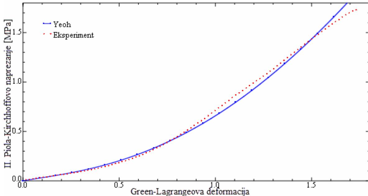
Slika 24. Opisivanje eksperimentalnih rezultata Yeoh-ovim materijalnim modelom
