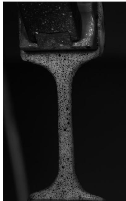
Slika 40. Uzorak aorte s nanesenim rasterom za ispitivanje DIC metodom
