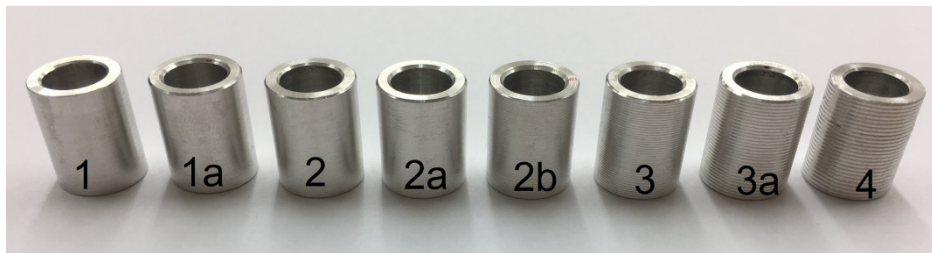
Slika 4-27. Osam aluminijskih cilindara različitih površinskih hrapavosti.
