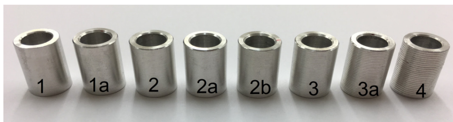
Slika 4-27. Osam aluminijskih cilindara različitih površinskih hrapavosti.
