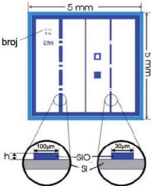
Slika 29. Primjer umjeravanja etalona za mjerenje visine stepenice upotrebom na međunarodnoj usporedbi. Nominalna visina stepenice iznosi 20 nm [1]
