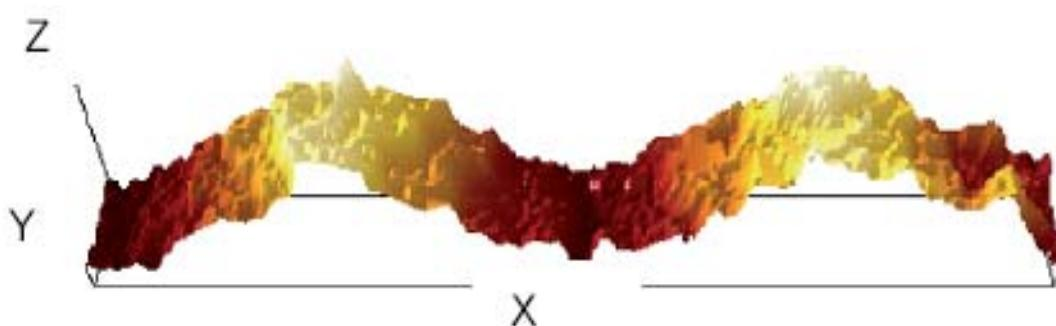
Slika 20. Primjer 3D rekonstrukcije ISO tipa C etalona hrapavosti mjerенog SEM-om [1]
