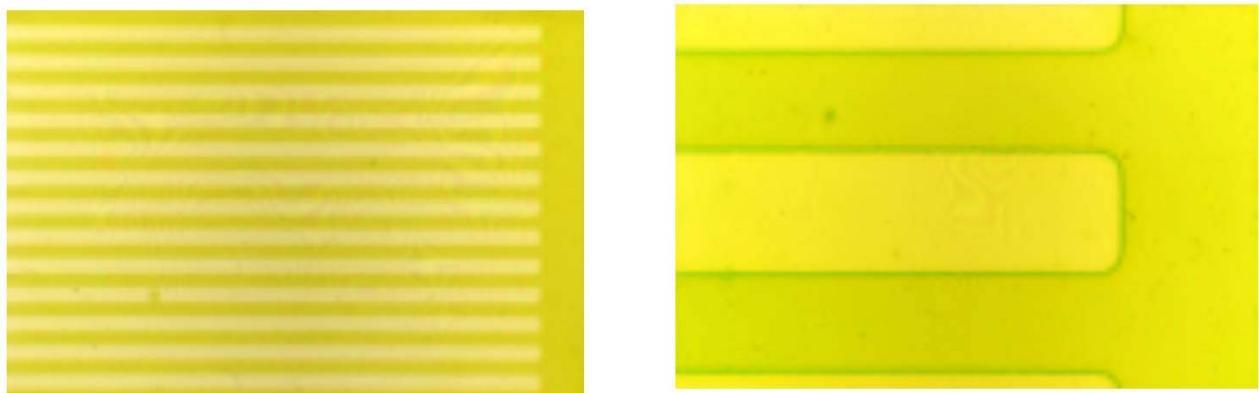
Slika 42. Uvećana slika brazdi referentnih etalona hrapavosti LFSB-a [3]
