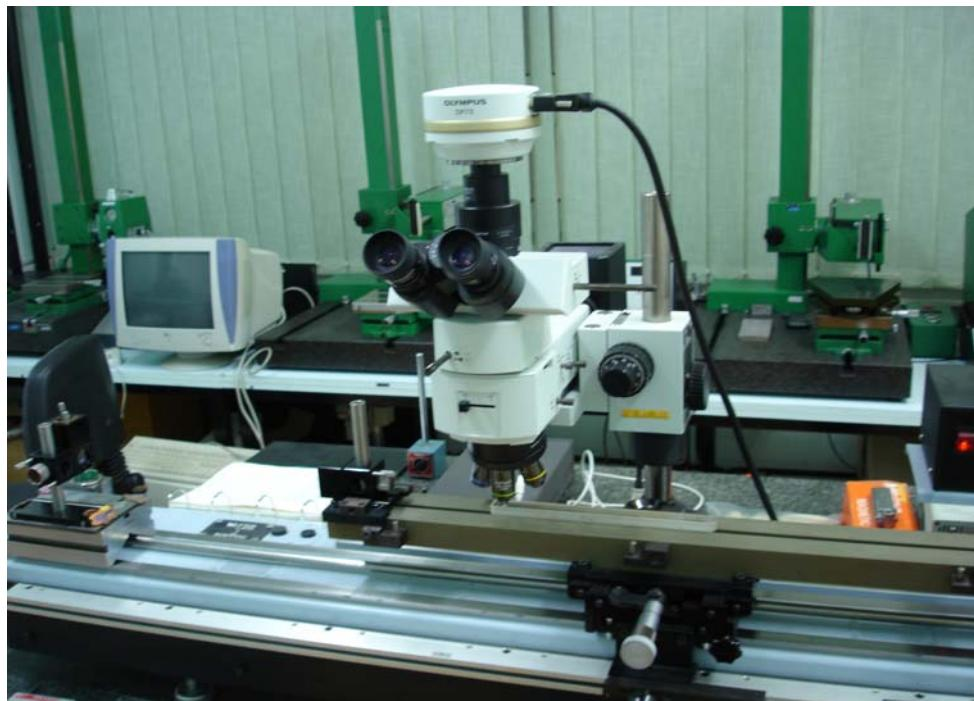
Slika 36. Uređaj za umjeravanje preciznih mjernih skala [7]
