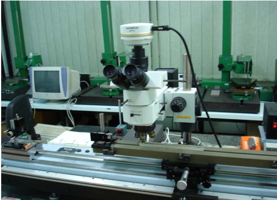
Slika 36. Uređaj za umjeravanje preciznih mjernih skala [7]
