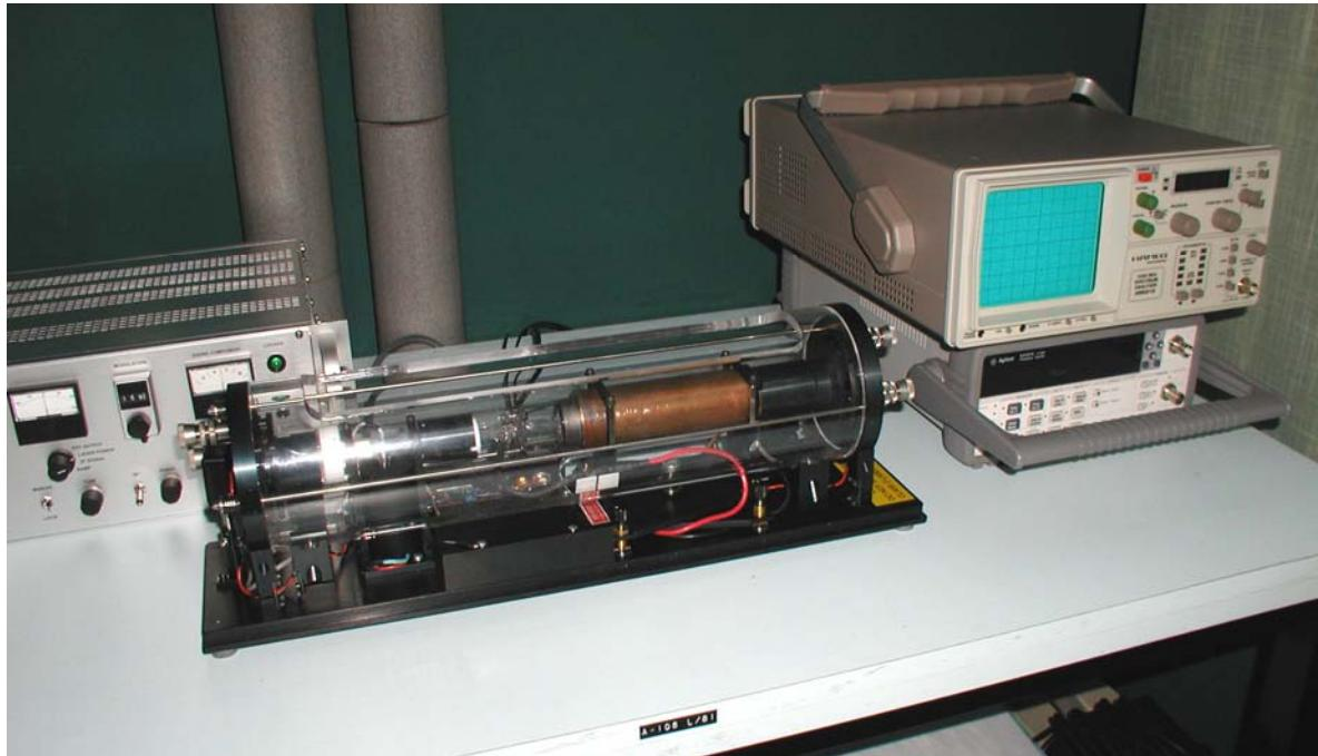
Slika 35. NPL-ov jedno stabilizirani He-Ne laser u *Laboratoriju za precizna mjerjenja dužina*
