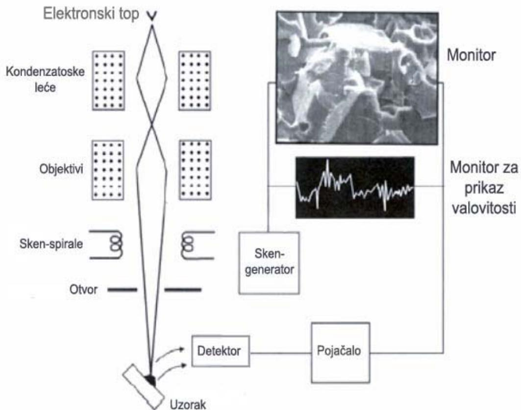
Slika 18. Princip mjerjenja SEM-om [1]
