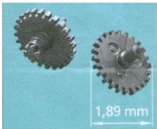
Slika 5. Prikaz mikrozupčanika promjera  $1,89 \text{ mm}$  i mase  $0,0008 \text{ g}$  [4]
