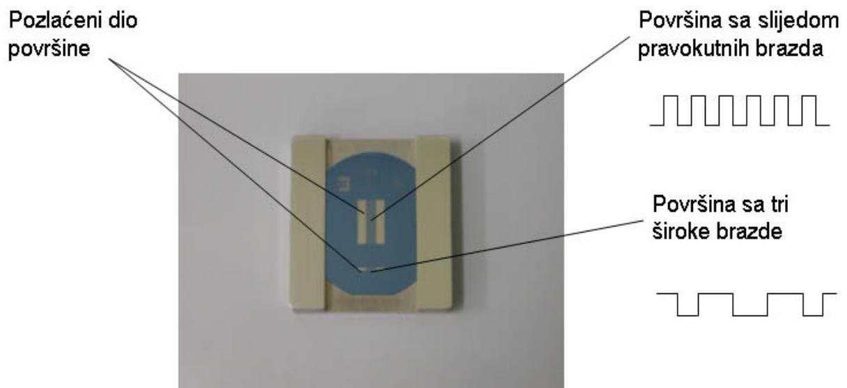
Slika 43. Referentni etalon hrapavosti LFSB-a [3]
