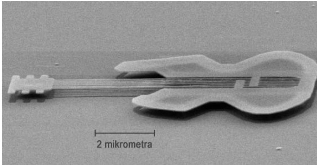
Slika 1. Prikaz minijature "gitare" izrađene postupkom nanolitografije
