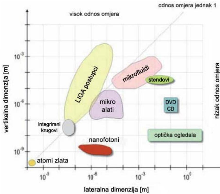
Slika 14. Izabrane komponente za dimenzijsko mikro i nanomjeriteljstvo [1]
