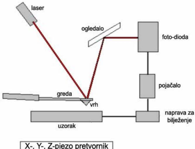
Slika 24. Osnovni princip rada AFM-a
