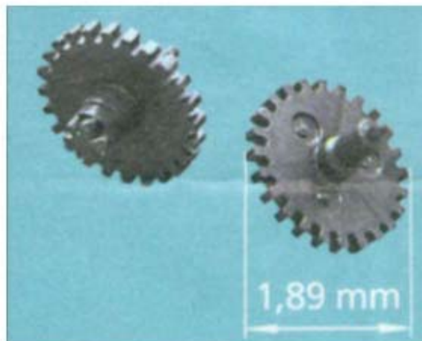
Slika 5. Prikaz mikrozupčanika promjera 1,89 mm i mase 0,0008 g [4]
