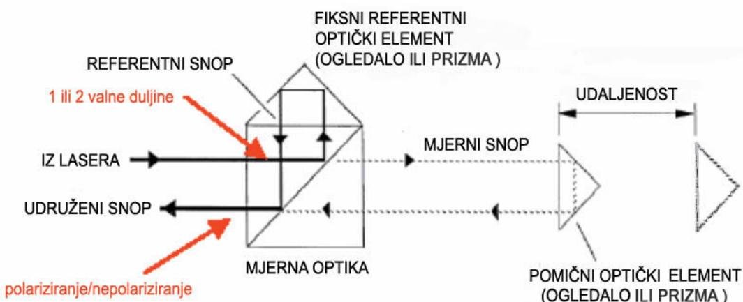
Slika 16. Osnovno podešenje interferometarskog sustava pomaka [1]
