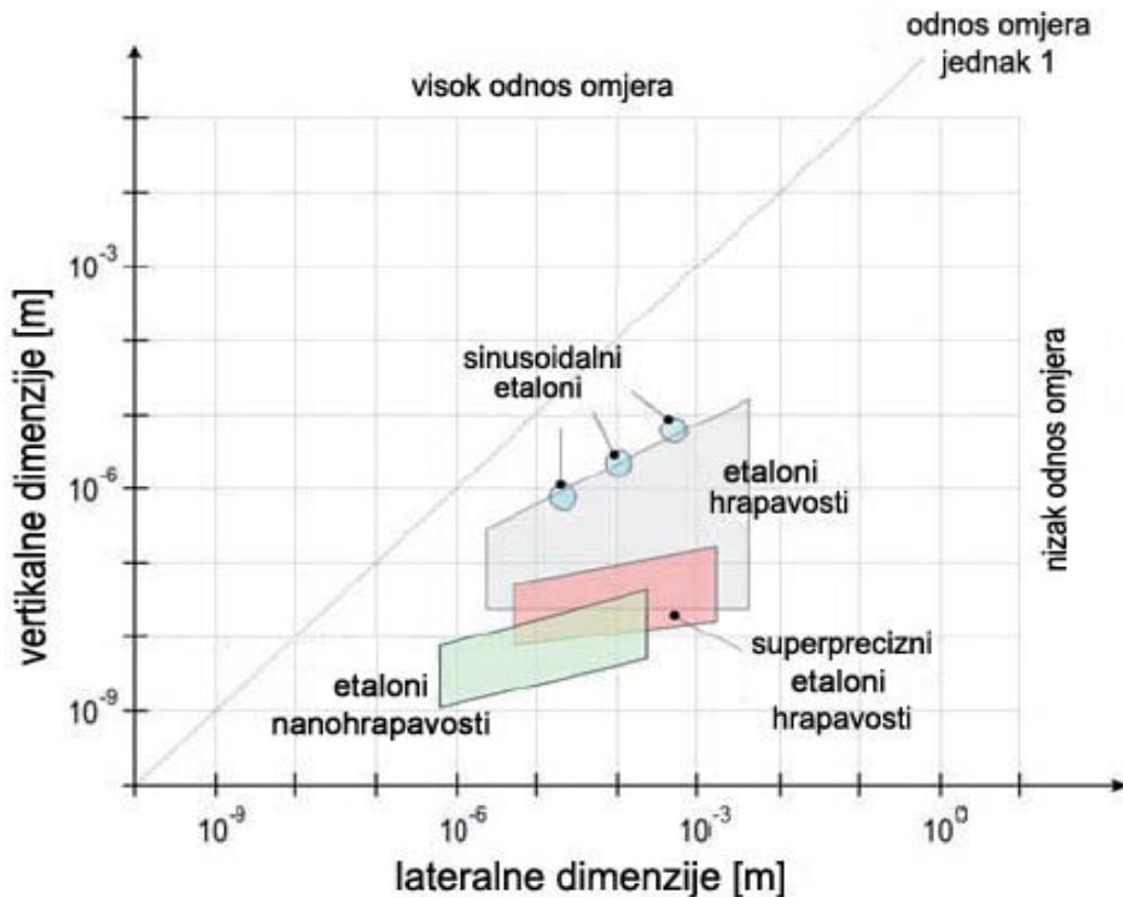
Slika 30. Umjeravanje etalona za dimenzijsko mikro i nanomjeriteljstvo [1]
