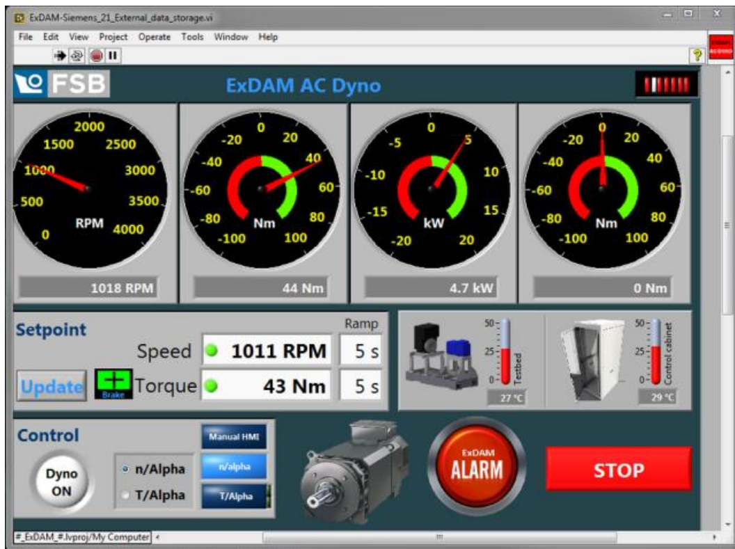
Slika 2.9. Daljinsko upravljačko sučelje kočnice, LabVIEW
