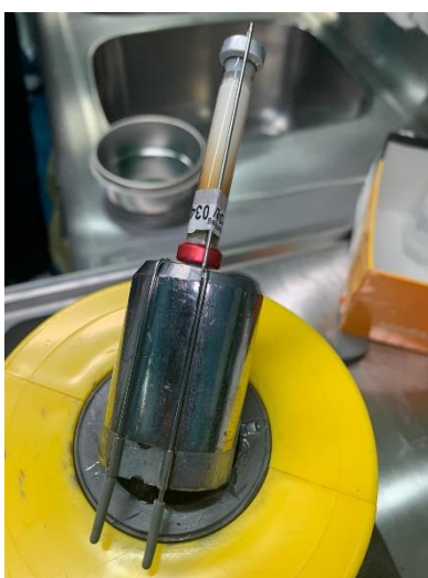
Slika 4. Kromatografska kolona ^{99}\text{Mo}/^{99\text{m}}\text{Tc} generatora radionuklida
