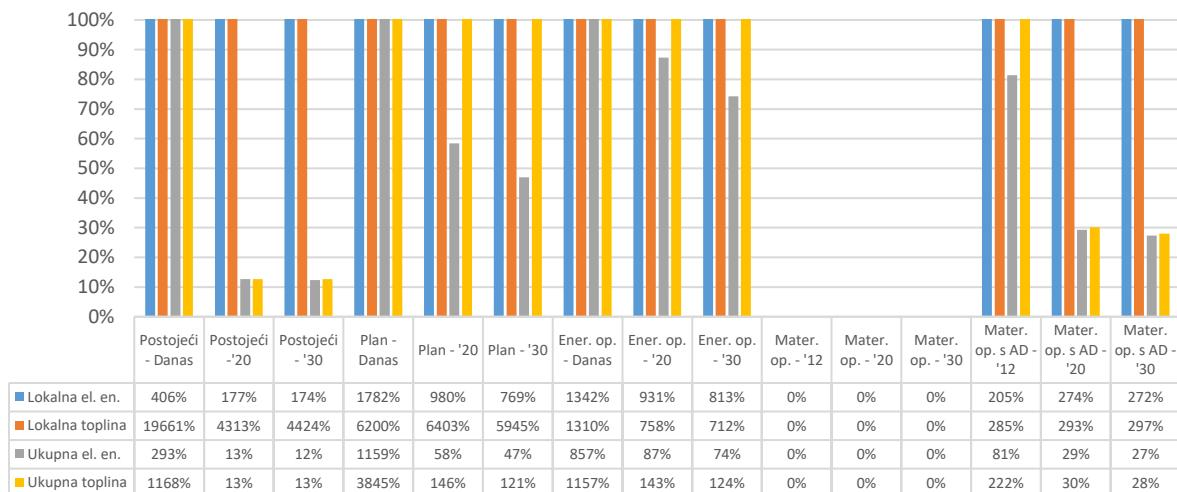
Slika 44. Faktori pokrivanja potrošnje energetskih vektora za varijantu transformacije bioplina u kogeneracijskom postrojenju
