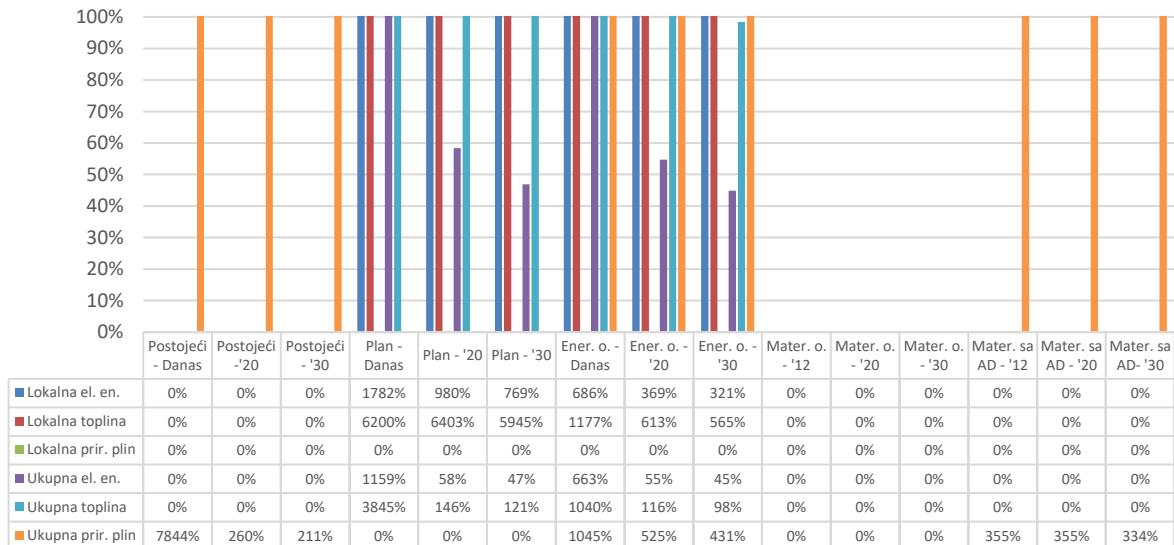
Slika 45. Faktori pokrivanja potrošnje energetskih vektora za varijantu transformacije bioplina u biometan
