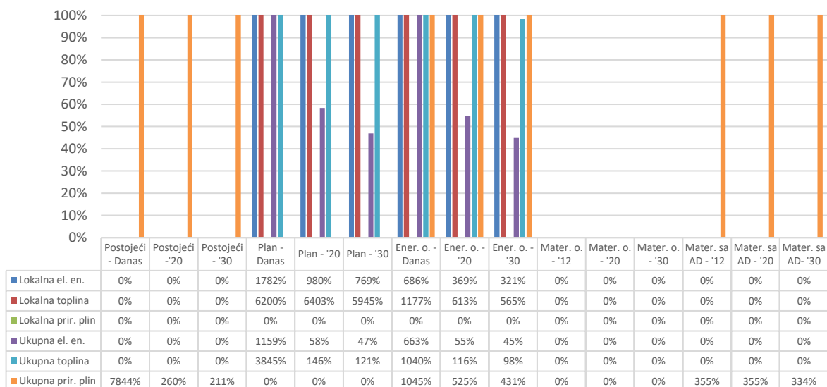
Slika 45. Faktori pokrivanja potrošnje energetske vektora za varijantu transformacije bioplina u biometan
