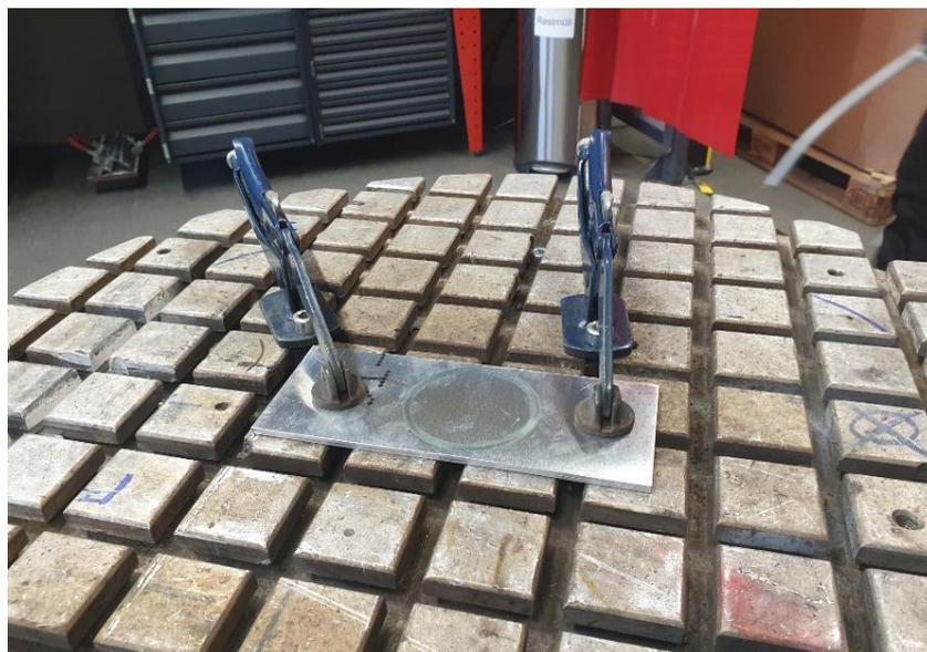
**Slika 62. Podloga za izradu učvršćena stegama**
