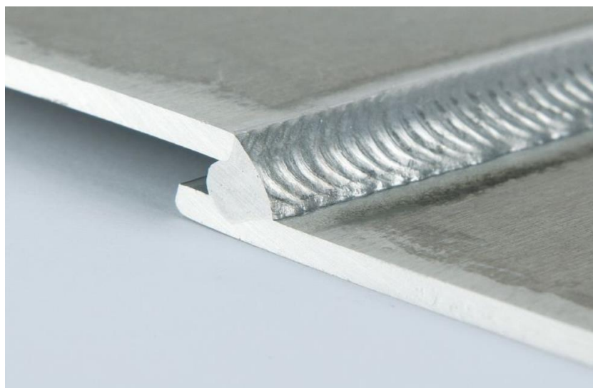
Slika 28. Spoj čelika i aluminija [38]
