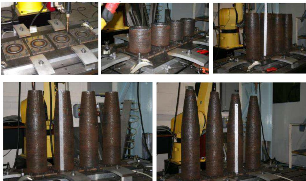
Slika 19. Faze izrade projektila [23]
