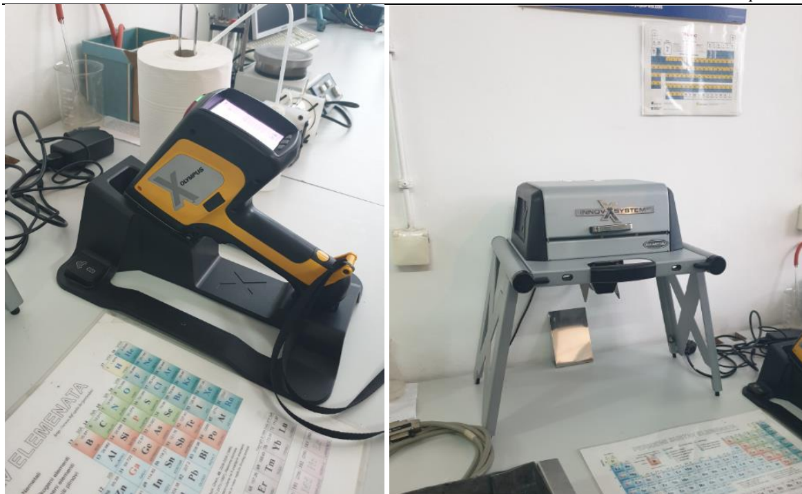
Slika 70. Olympus XRF uređaj za snimanje kemijskog sastava
