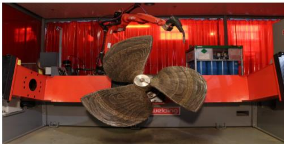
Slika 17. Izrada broskog propelera [21]
