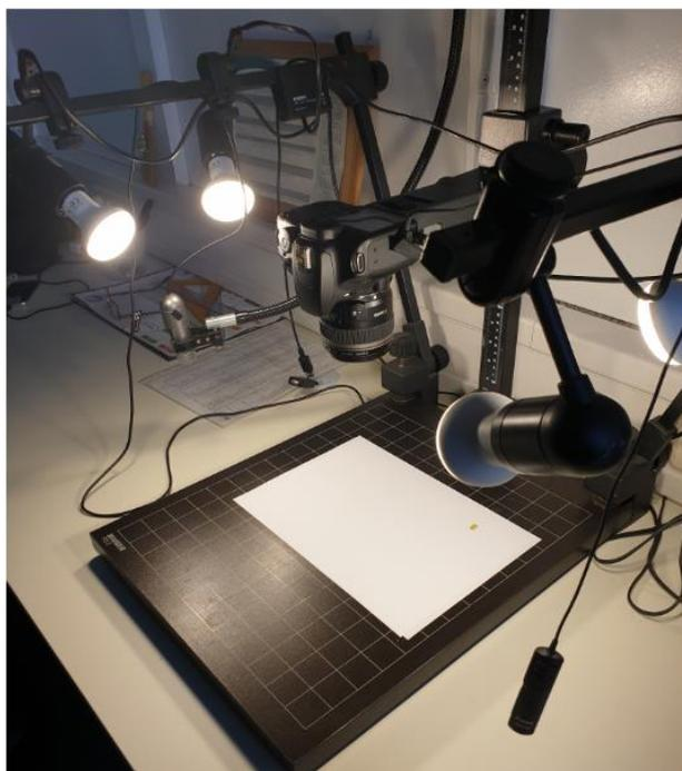
**Slika 87. Oprema za snimanje makrostrukture**
