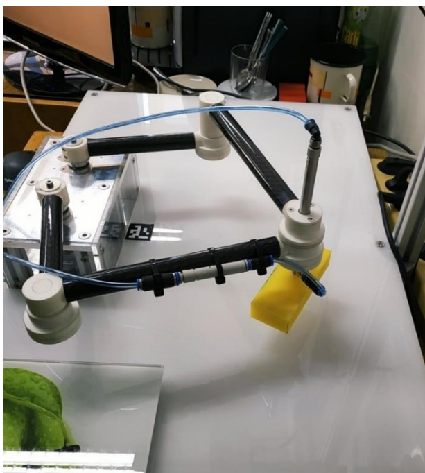
Slika 158. Mjerenje nosivosti robota 3
