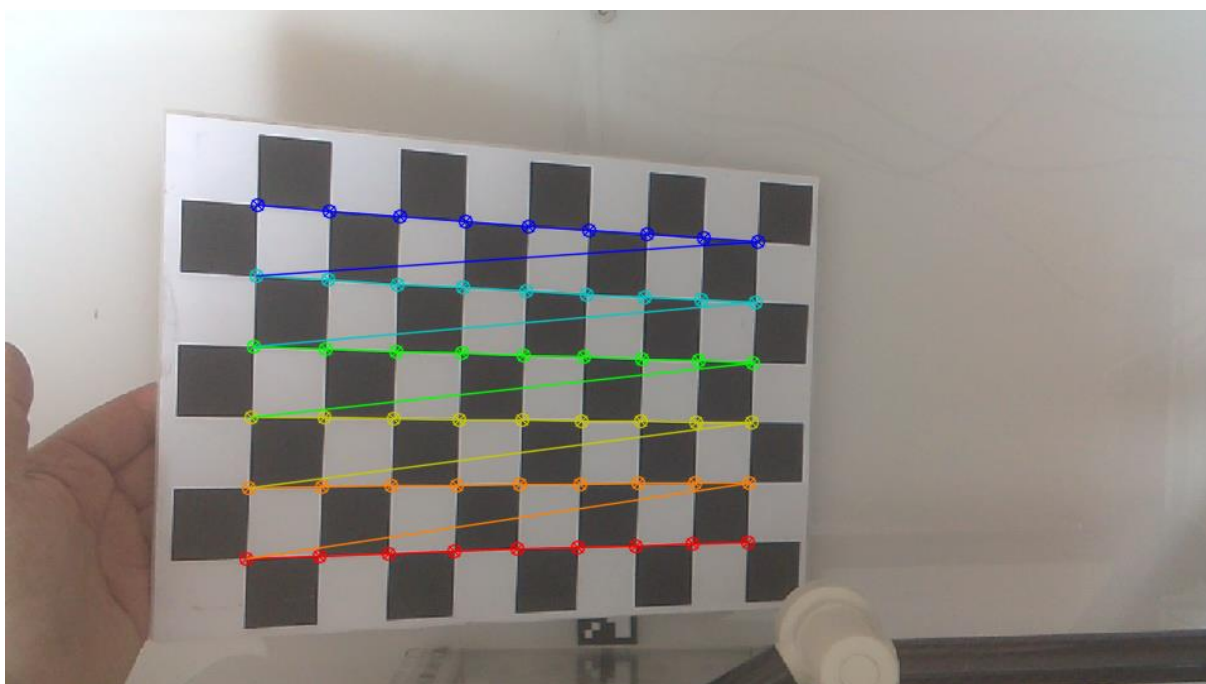
Slika 132. Kalibracija kamere, pronalazak točaka
