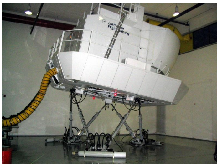
Slika 2. Heksapodni robot za simulaciju leta [3]
